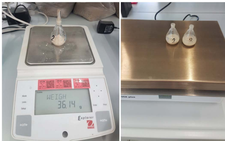
Slika 4. Prikaz ispitivanja gustoće čvrstih čestica metodom piknometra
