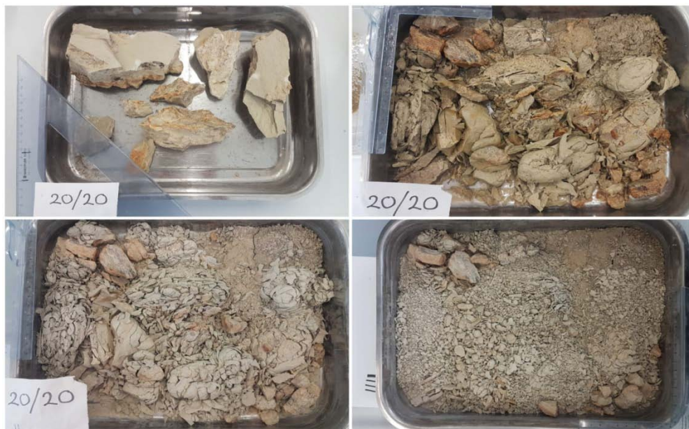
Slika 10. Proces dezintegracije uzorka u trećoj fazi rastrošbe – od 1. do 4. ciklusa
