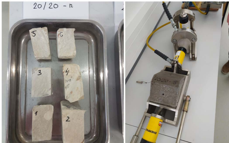
Slika 8. Prikaz intaktnog uzorka i uređaja za direktno smicanje stijena
