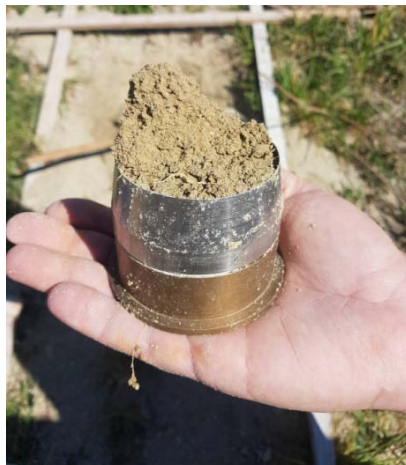
Slika 6. Uzimanje uzorka s terena - metoda cilindra
