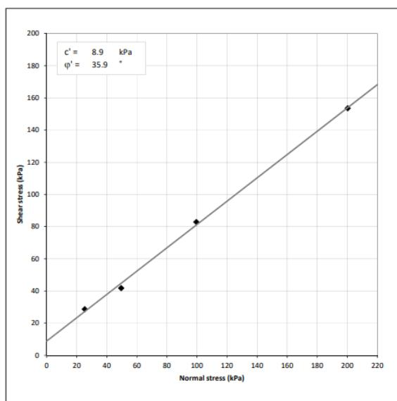
Slika 18. Rezultati posmične čvrstoće za uzorak
