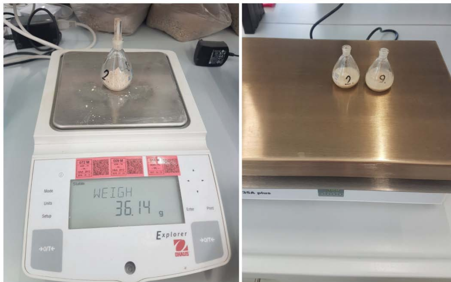
Slika 4. Prikaz ispitivanja gustoće čvrstih čestica metodom piknometra
