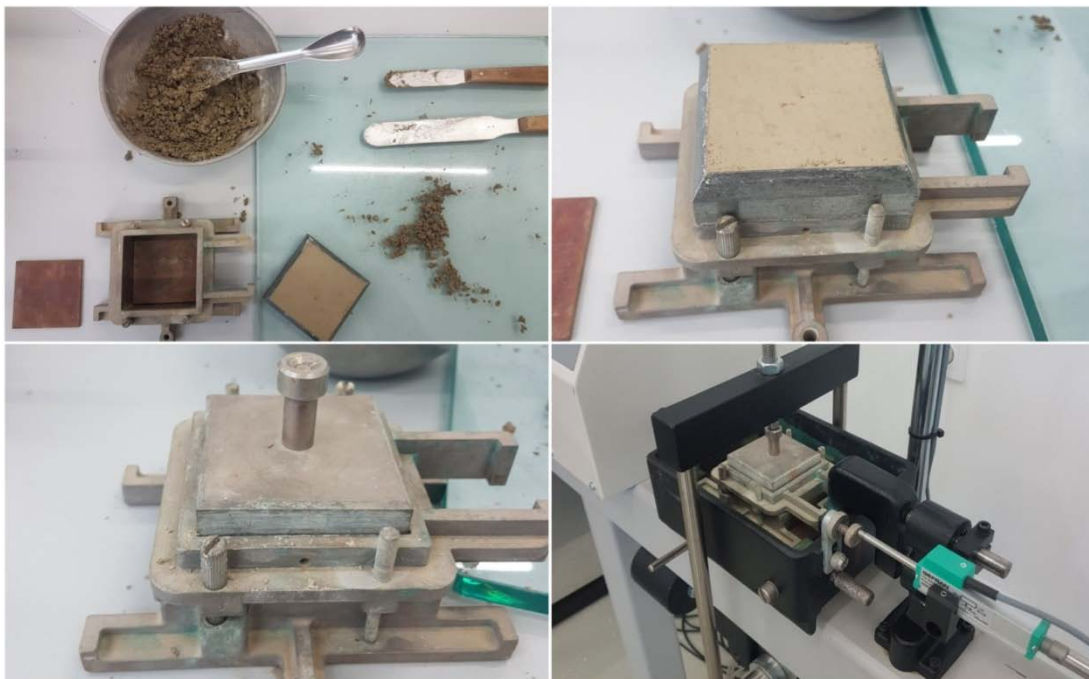
Slika 12. Priprema uzorka za ispitivanje posmične čvrstoće u uređaju za direktno smicanje tla
