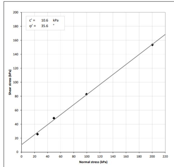
Slika 19. Rezultati posmične čvrstoće za uzorak
