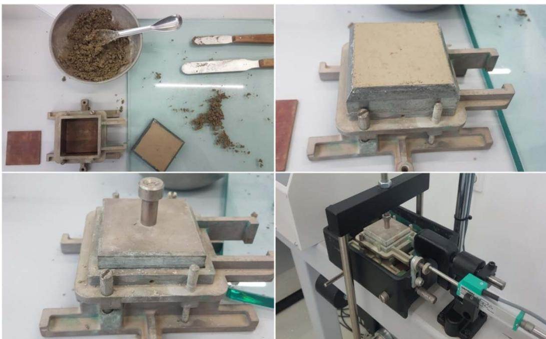
Slika 12. Priprema uzorka za ispitivanje posmične čvrstoće u uređaju za direktno smicanje tla
