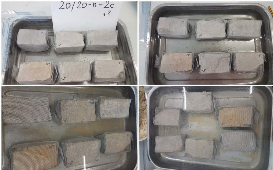
Slika 9. Proces dezintegracije uzorka u drugoj fazi rastrošbe - naizmjenično sušenje i vlaženje
