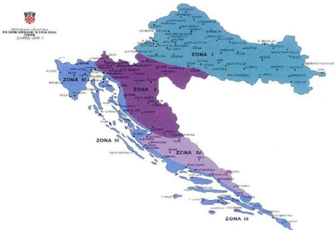
Slika 6. Klimatske zone karakterističnog opterećenja snijegom S_k
