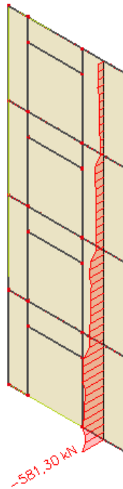
Slika 150. Uzdužne sile u zidu Zy1 (kN)
