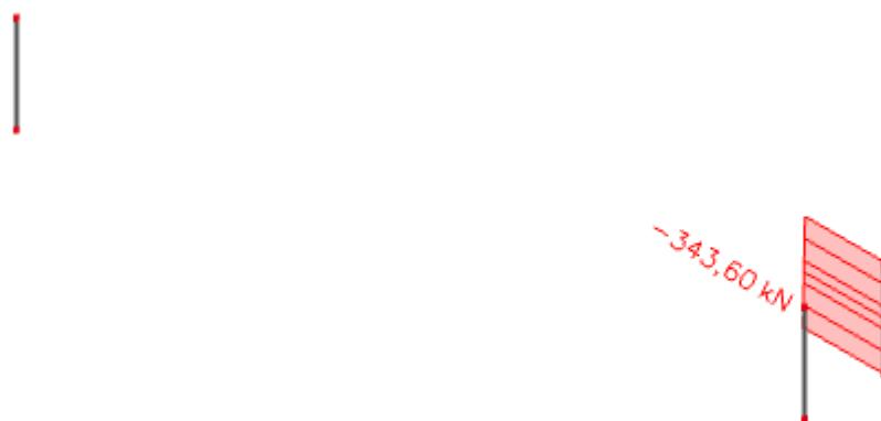
Slika 126. Prikaz pripadne uzdužne sile za maksimalni moment savijanja stupa S2 (kN)
