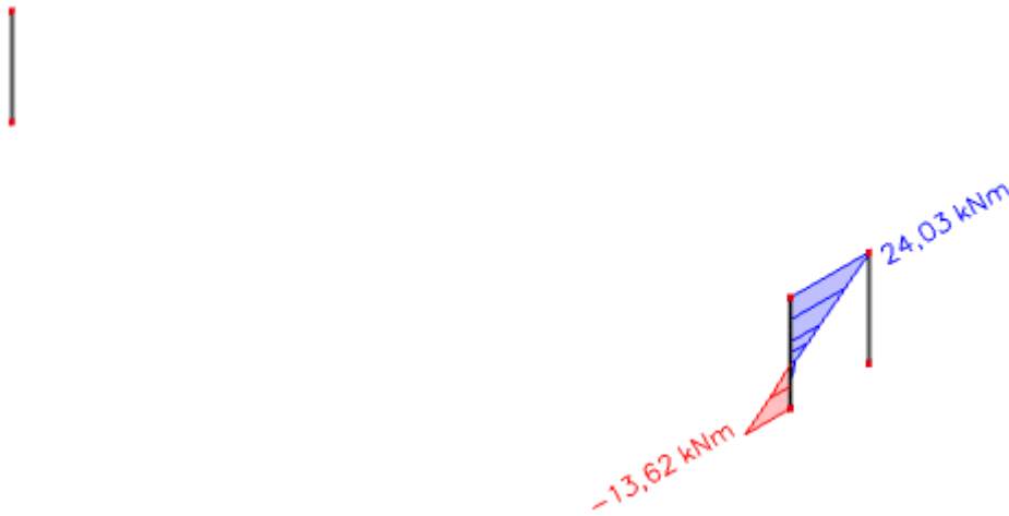
Slika 124.- Prikaz pripadnog momenta savijanja za maksimalnu uzdužnu silu stupa S2 (kNm)
