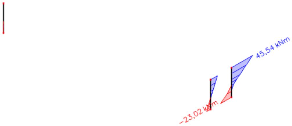
Slika 125. Prikaz maksimalnog momenta savijanja na stupovima S2 (kNm)
