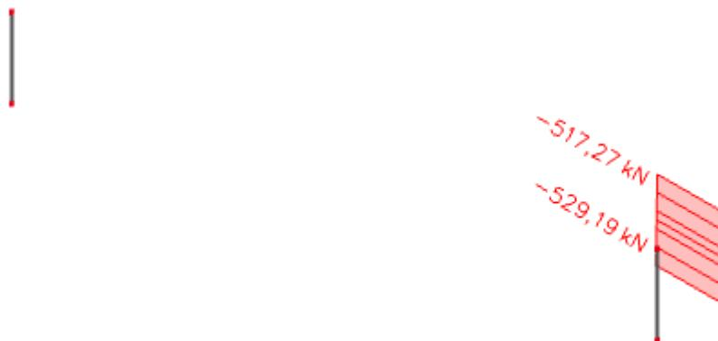
Slika 122. Prikaz pripadne uzdužne sile za maksimalni moment savijanja stupa S2 (kN)
