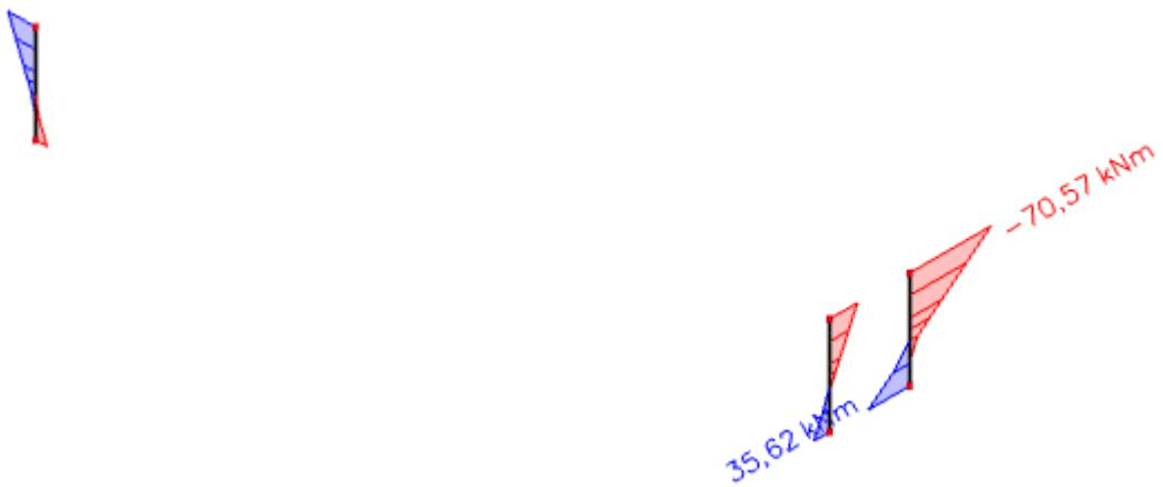
Slika 121. Prikaz maksimalnog momenta savijanja na stupovima S2 (kNm)
