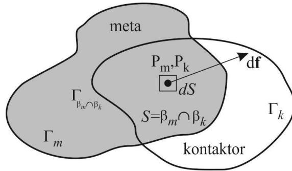
**Slika 4.9.** Prikaz kontaktne sile nastale uslijed preklopa u okolini točaka  $P_m$  i  $P_k$  [16].
