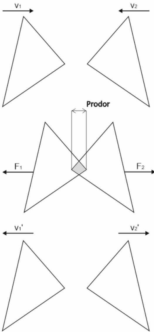
**Slika 4.4.** Prikaz mehanog kontakta dva trokutasta elementa.
