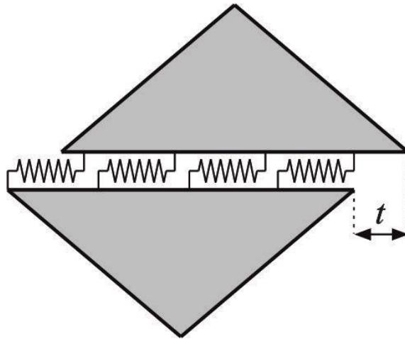
**Slika 4.15.** Prikaz modela posmične opruga između susjednih elemenata [17].
