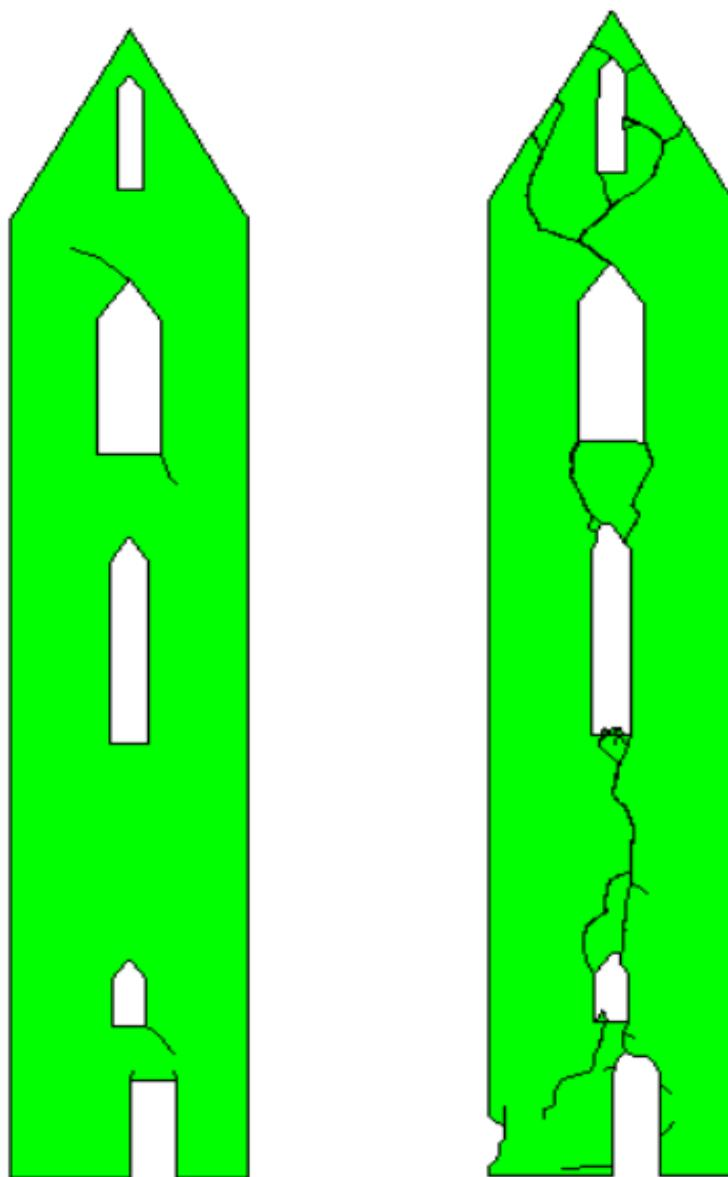
**Slika 6.5.** Prikaz stanja modela zvonika a) Prvo oštećenje; b) Finalno stanje.
