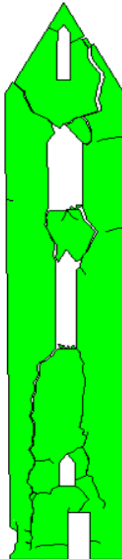
Slika 6.12. Prikaz trenutka urušavanja reprezentativnog modela zvonika.
