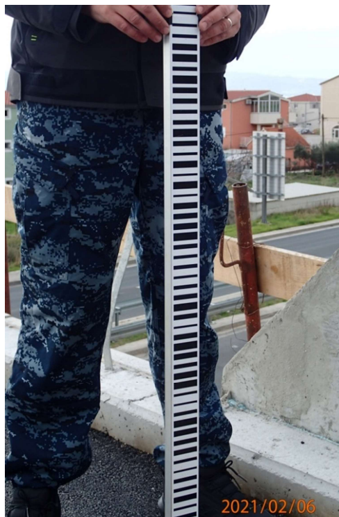
Slika 4.3. Invarska bar-code teleskopska letva STONEX, model DS1
