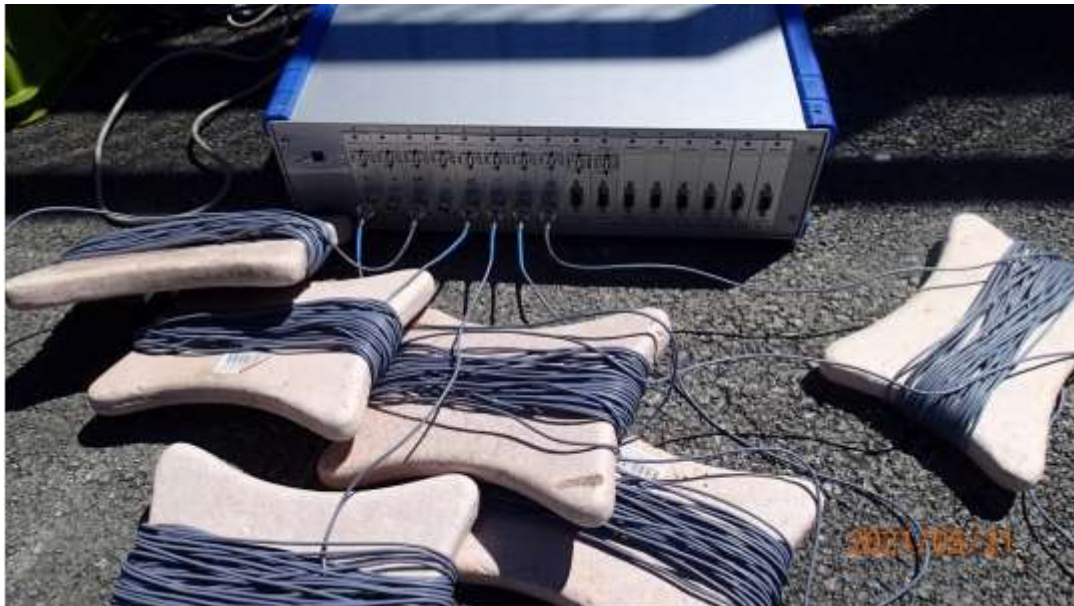
Slika 4.13. Uređaj za dinamička mjerenja DEWETRON 2010 odnosno DEWE-Rack
