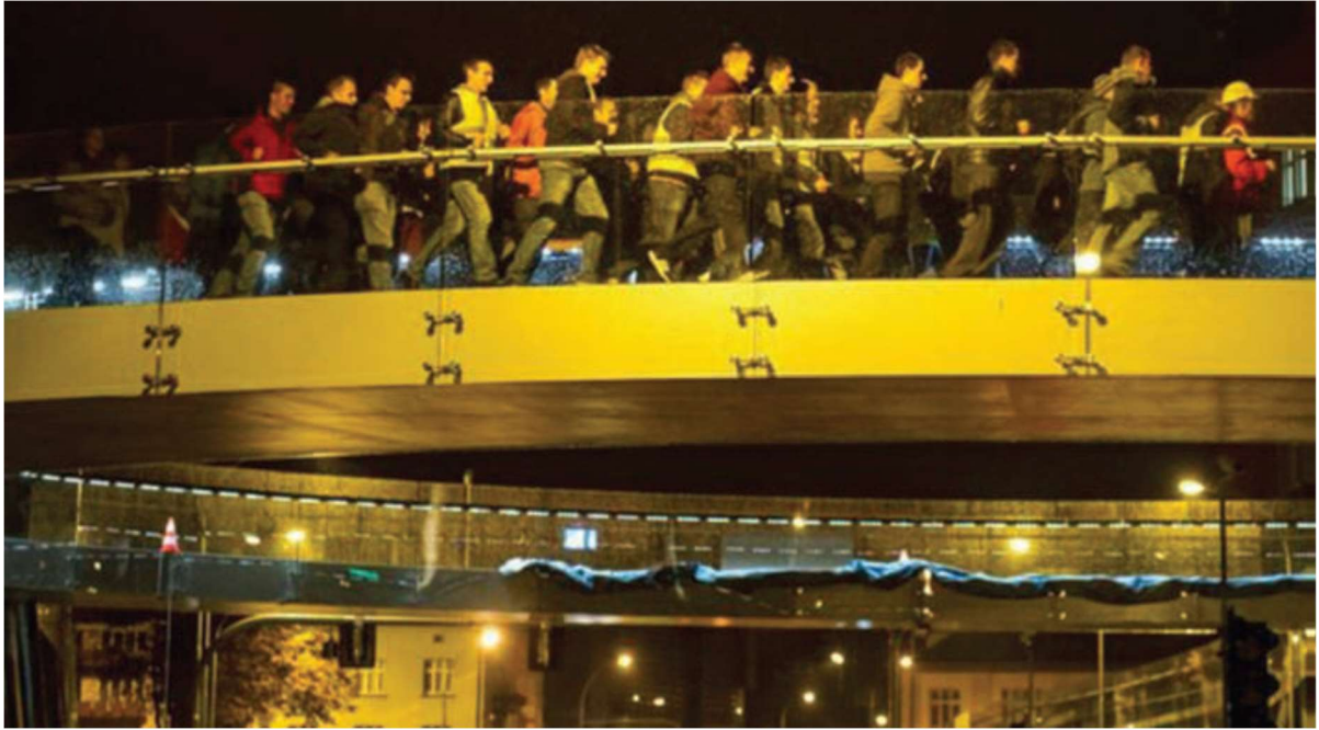
Slika 2.4. Dinamičko ispitivanje – ljudska navala-sporo trčanje [4]
