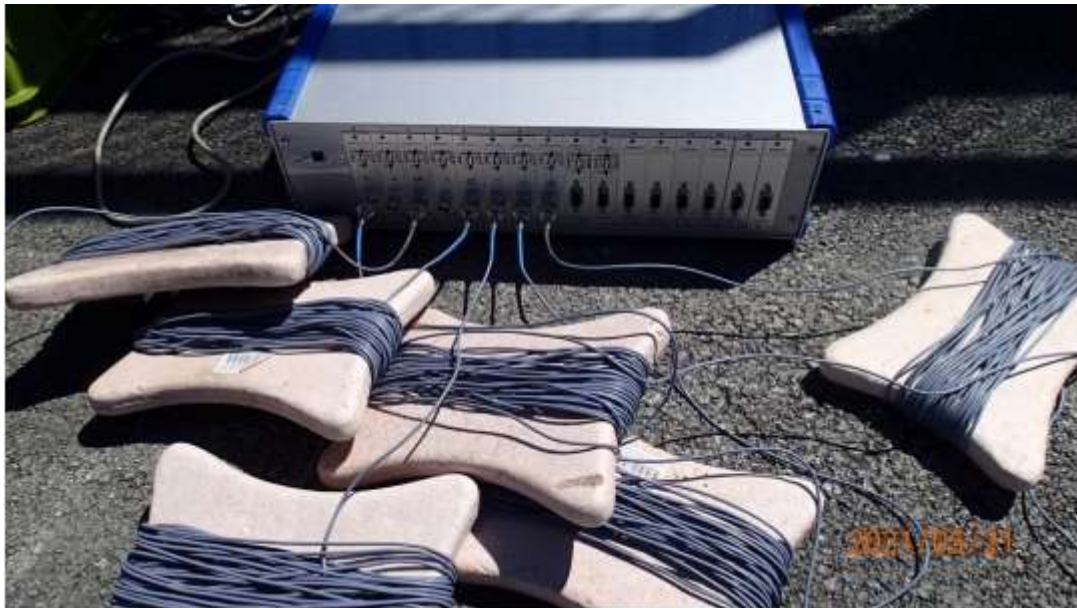
Slika 4.13. Uređaj za dinamička mjerenja DEWETRON 2010 odnosno DEWE-Rack
