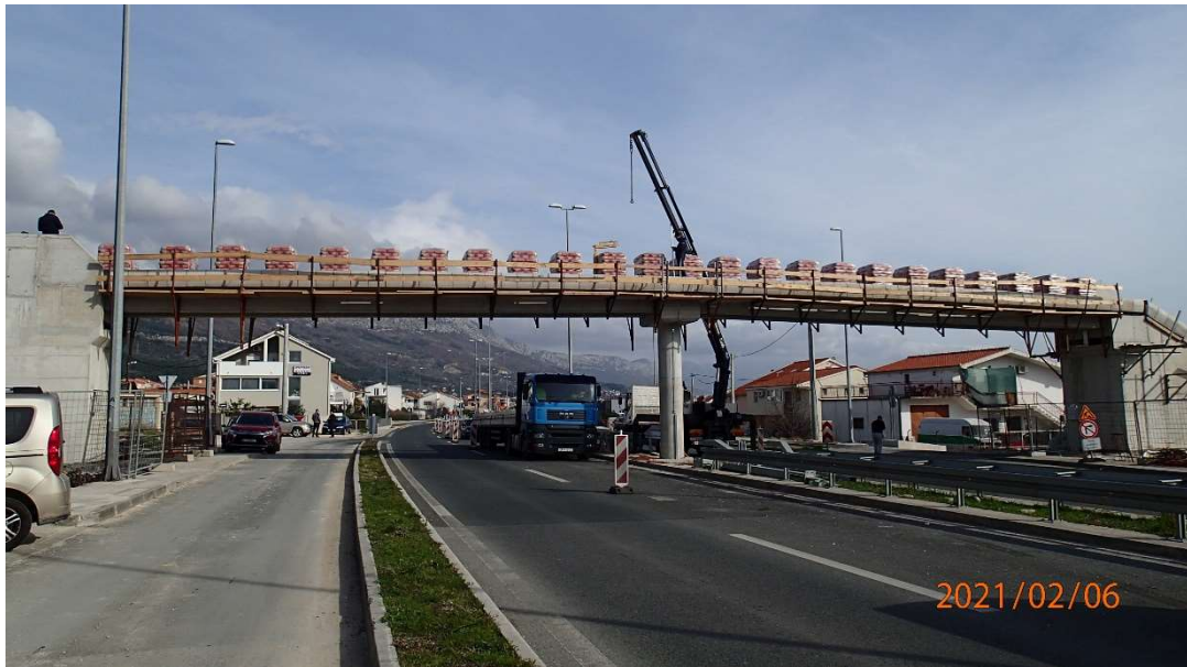
Slika 4.10. Faza 5 – opterećenje na oba raspona
