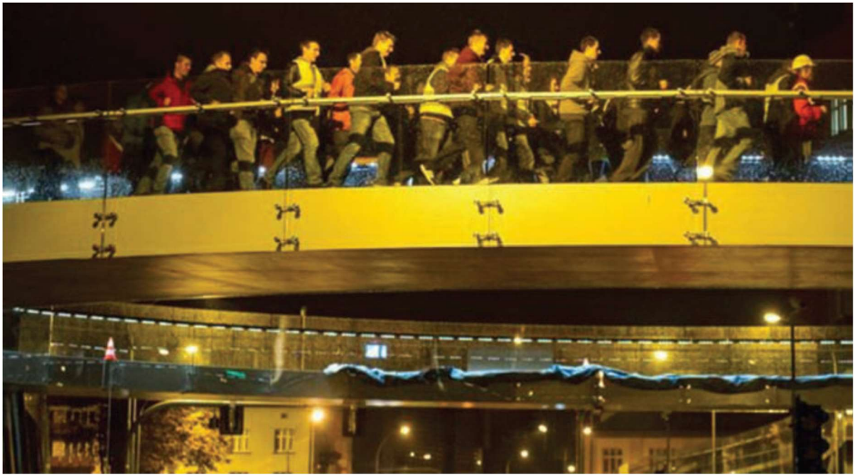
Slika 2.4. Dinamičko ispitivanje – ljudska navala-sporo trčanje [4]
