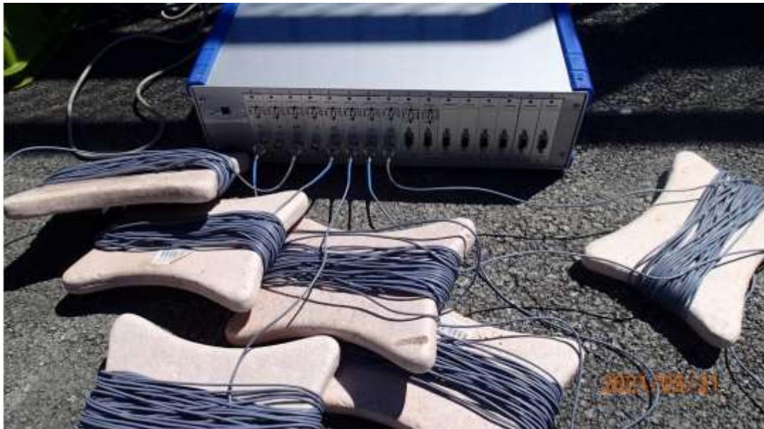
Slika 4.13. Uređaj za dinamička mjerenja DEWETRON 2010 odnosno DEWE-Rack
