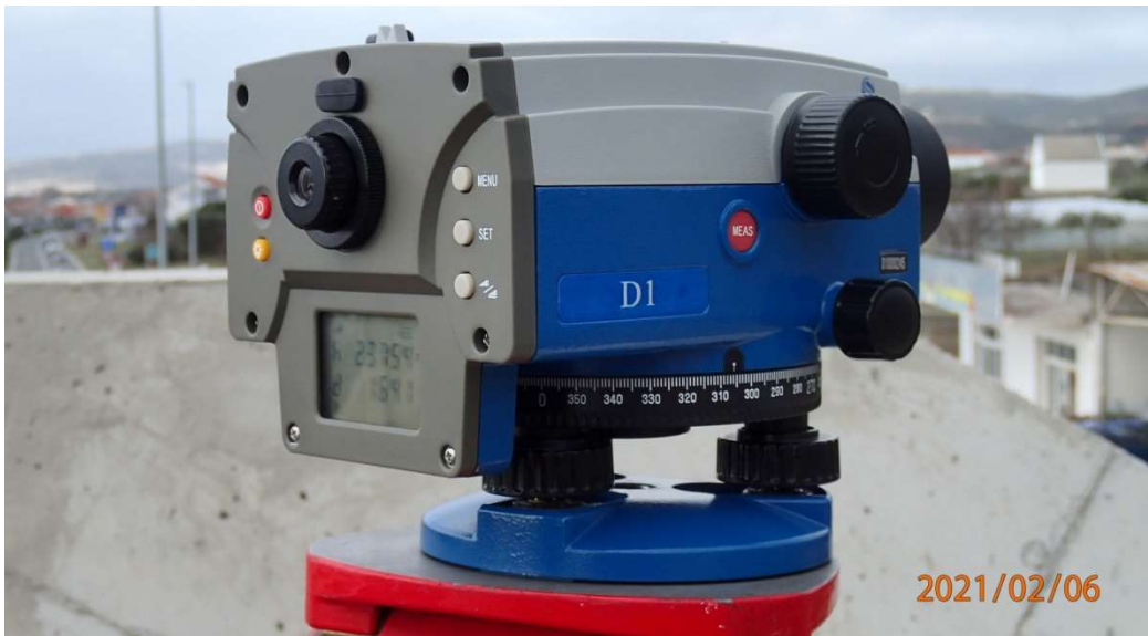
Slika 4.2. Precizni nivelman – aparat STONEX D1 za mjerenje pomaka
