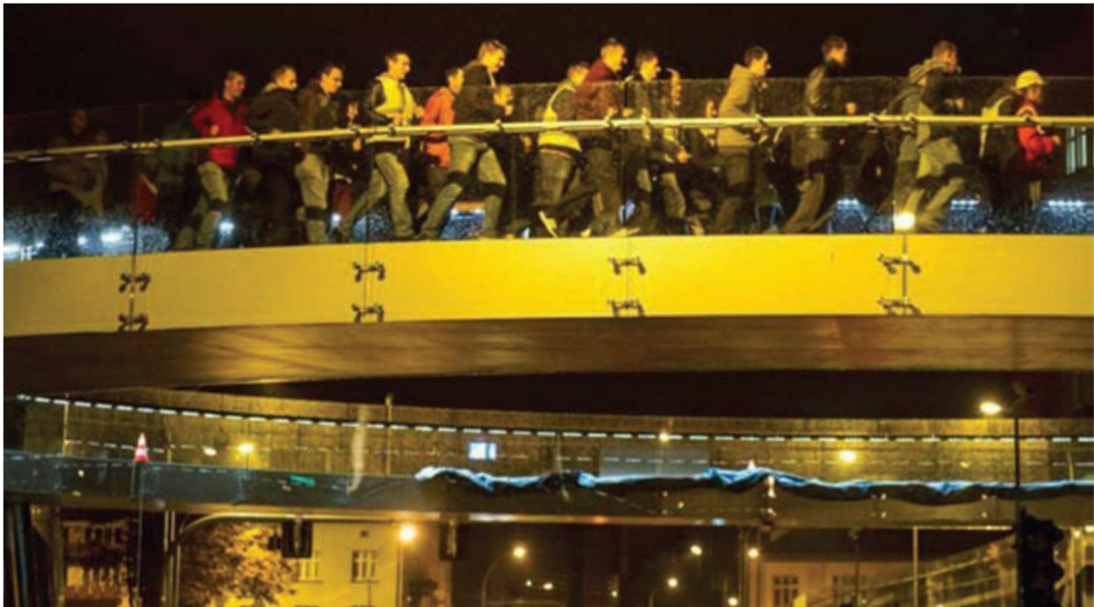
Slika 2.4. Dinamičko ispitivanje – ljudska navala-sporo trčanje [4]
