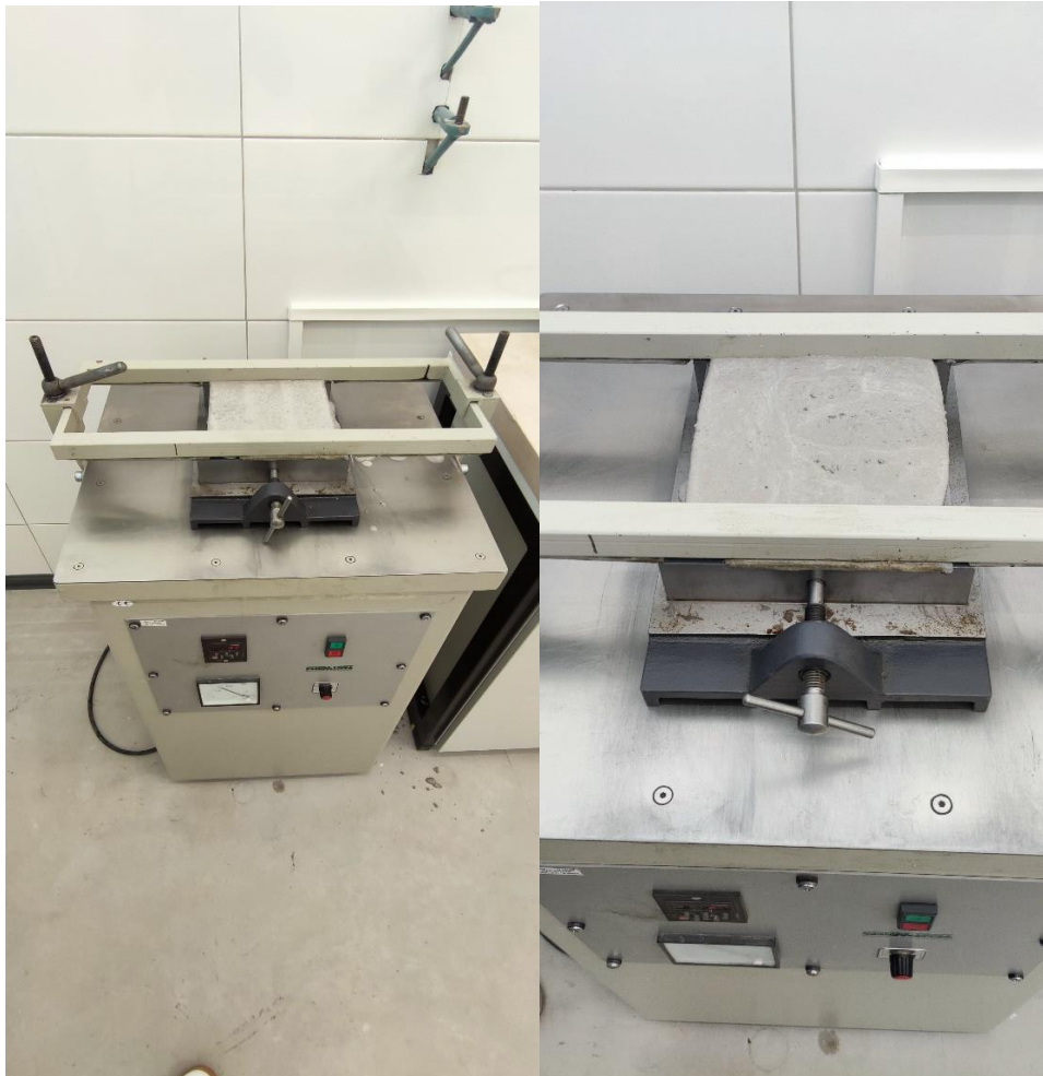
Slika 18, Ugradnja morta u kalupe [slika iz laboratorija]
