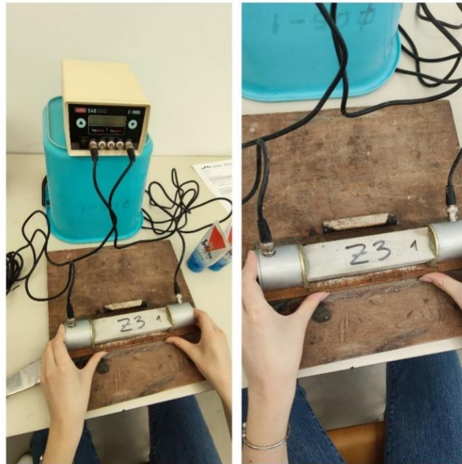
Slika 22, Ispitivanje ultrazvukom [slika iz laboratorija]
