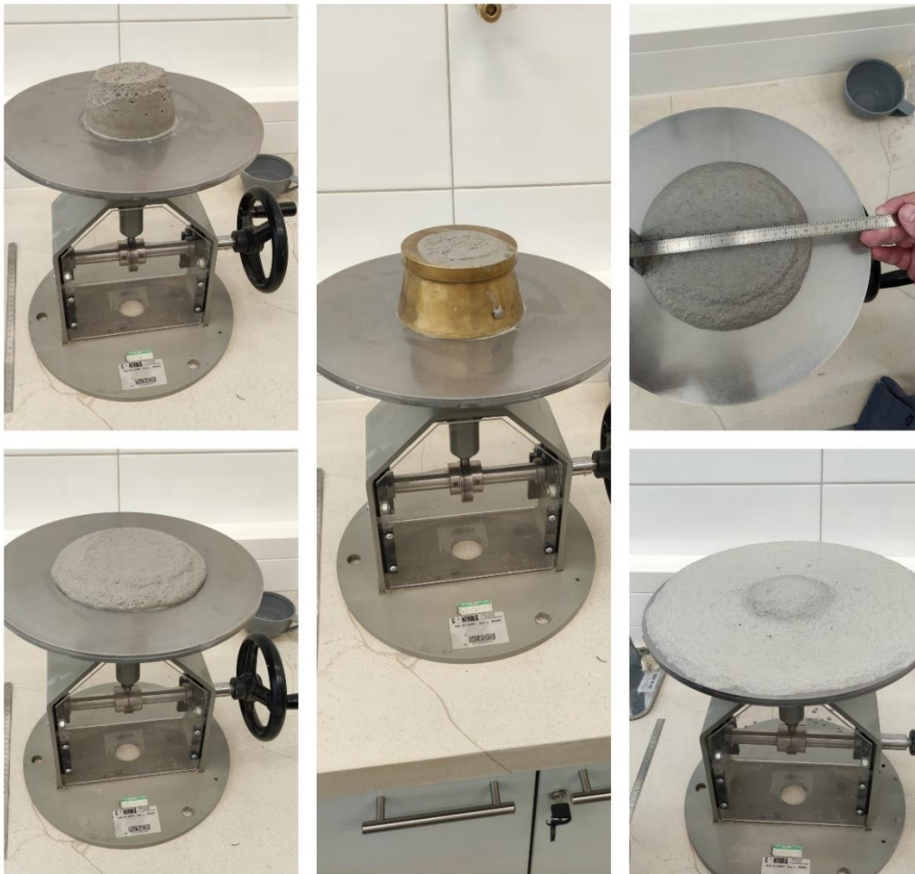
Slika 16, Ispitivanje obradivosti [slika iz laboratorija]
