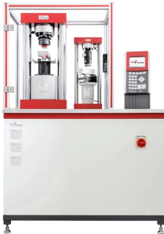
Slika 13, Uređaj za određivanje čvrstoće
