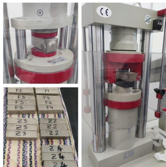
Slika 19, Ispitivanje čvrstoće [slika iz laboratorija]
