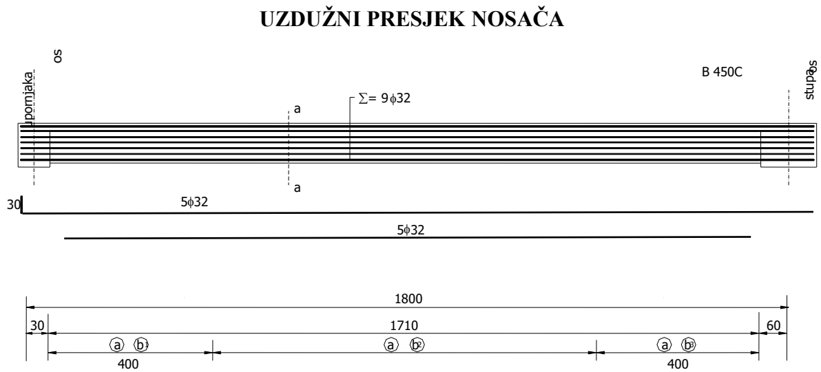
Slika 32. Prikaz armiranja uzdužnog nosača u polju
