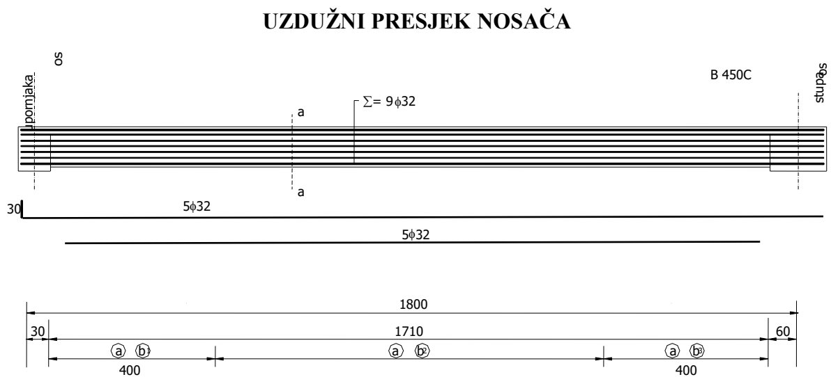
Slika 32. Prikaz armiranja uzdužnog nosača u polju
