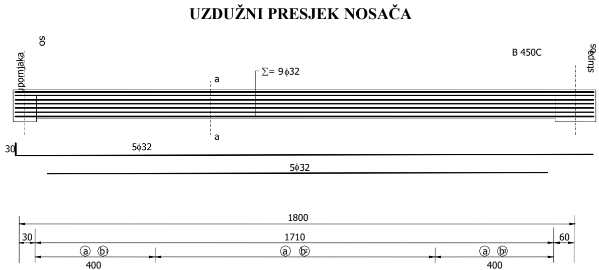
Slika 32. Prikaz armiranja uzdužnog nosača u polju
