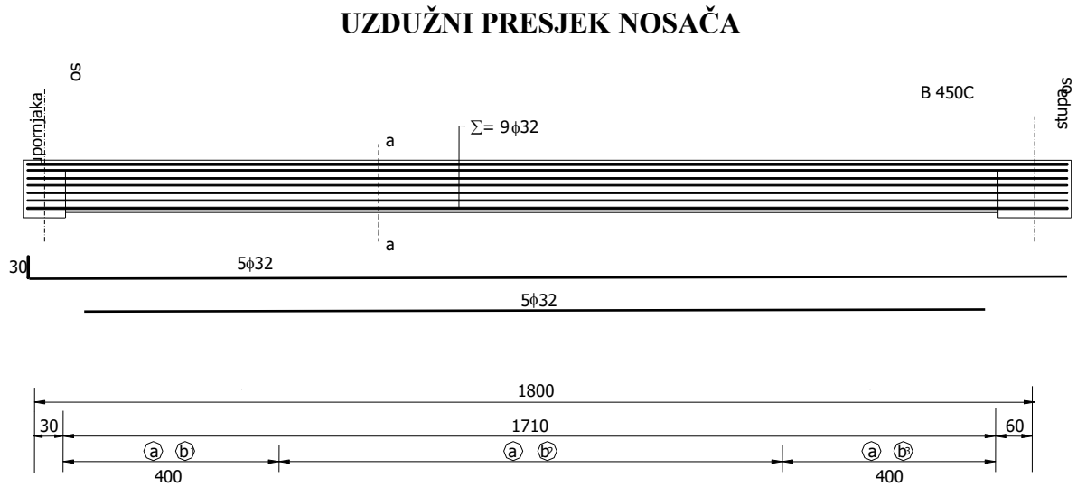
Slika 32. Prikaz armiranja uzdužnog nosača u polju
