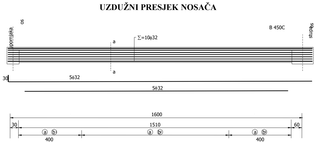
Slika 32. Prikaz armiranja uzdužnog nosača u polju
