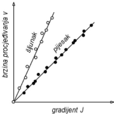
*Slika 1.3. Linearna ovisnost brzine procjeđivanja i gradijenta*
