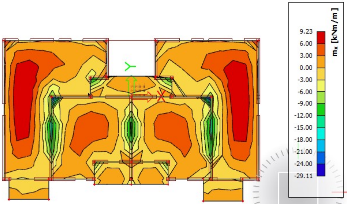
Slika 39 M_{sd,x} [kNm/m] = računski momenti savijanja u smjeru lokalnih osi za q_{sd}=1.0 G + 1.0Q
