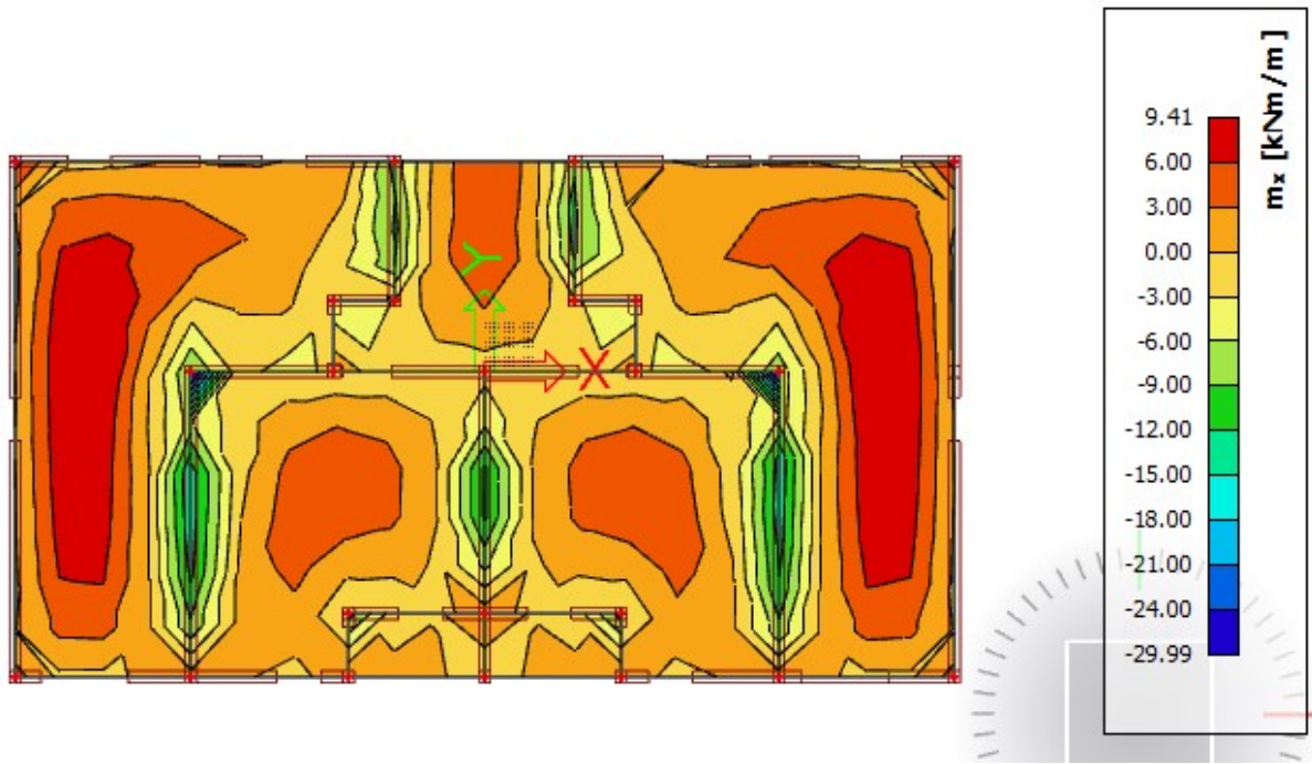
Slika 48 MS_{d,x} [kNm/m] = računski momenti savijanja u smjeru lokalnih osi za q_{Sd}=1.0 G + 1.0Q
