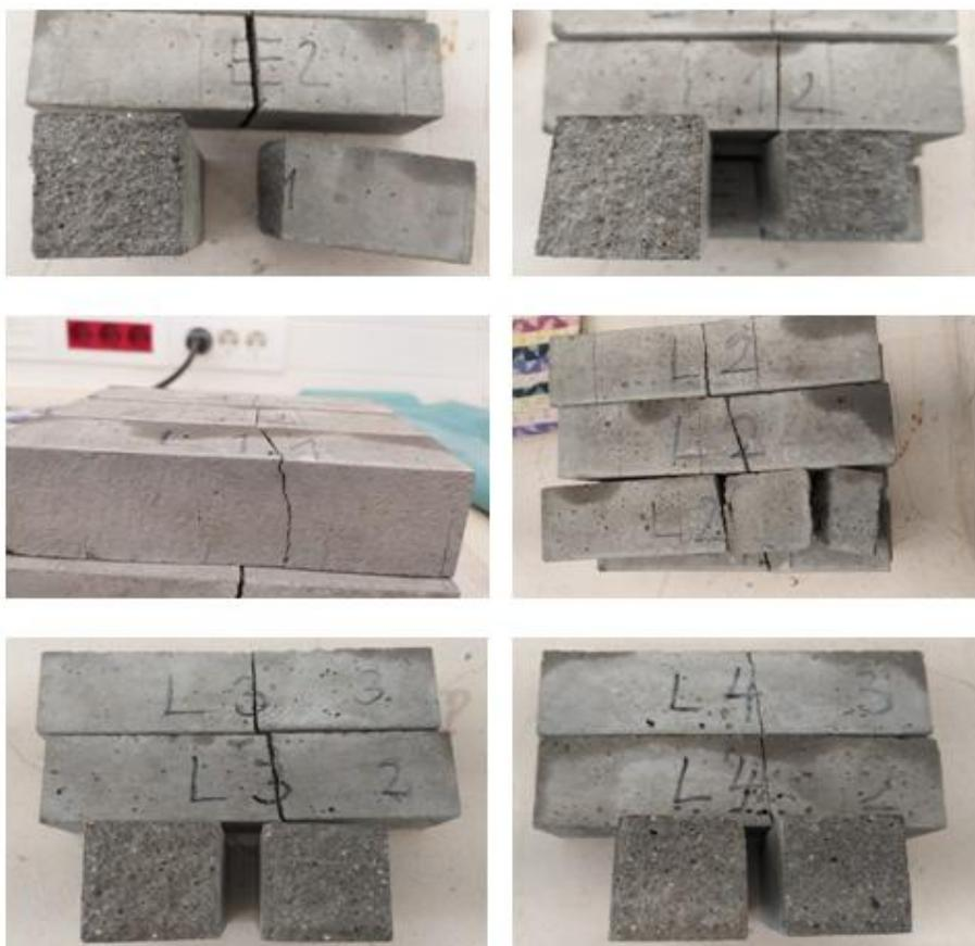
Slika 41. Uzorci nakon ispitivanja čvrstoće
