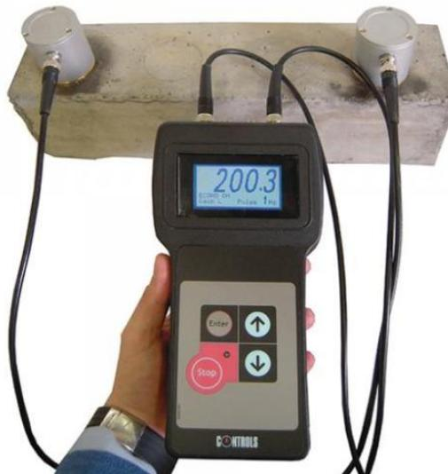
Slika 17. Uređaj za ispitivanje ultrazvuka (proizvođač Controls)
