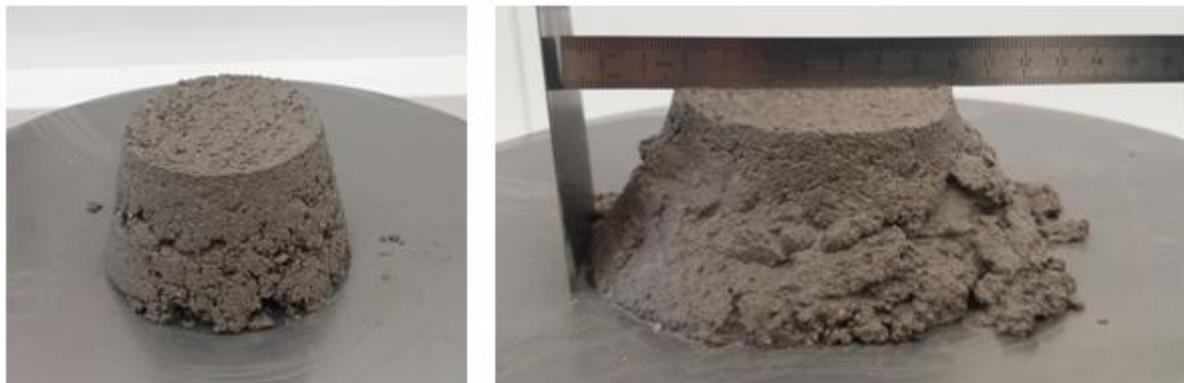
Slika 34. Obradljivost uzorka L4
