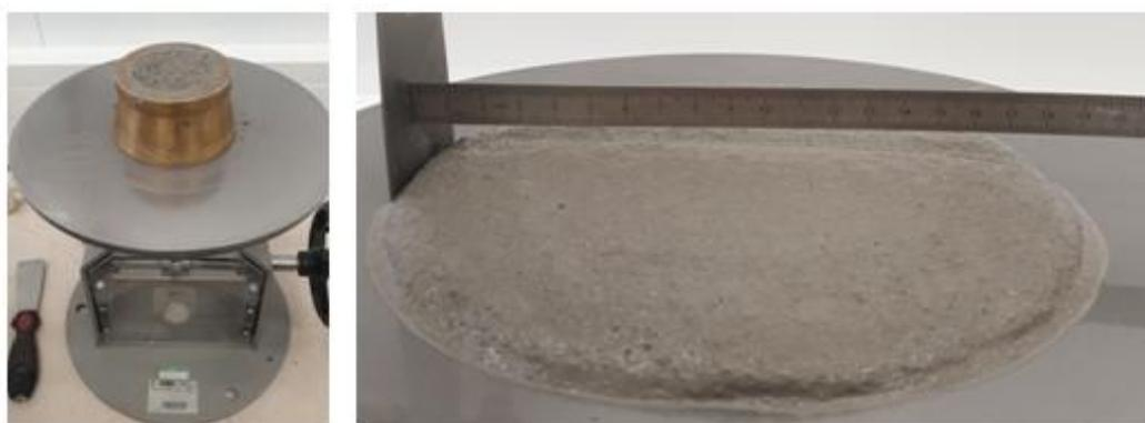
Slika 31. Obradljivost uzorka L1
