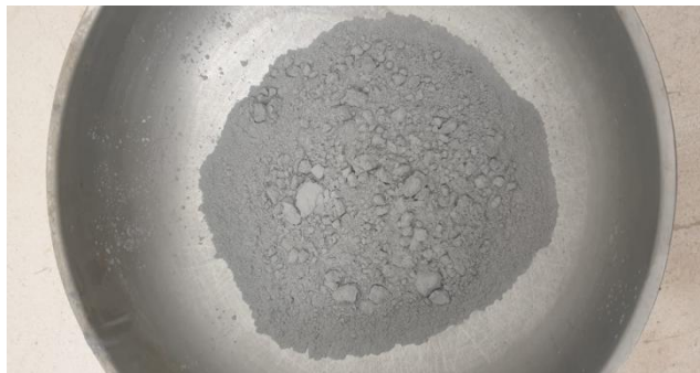
Slika 11. Upotrijebljen leteći pepeo u svrhu ispitivanja
