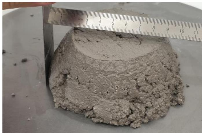
Slika 47. Obradljivost uzorka T2
