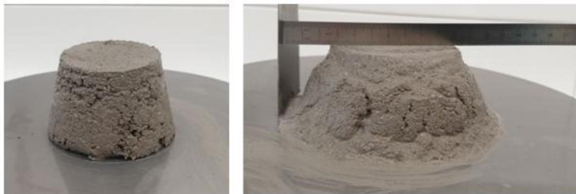
Slika 33. Obradljivost uzorka L3
