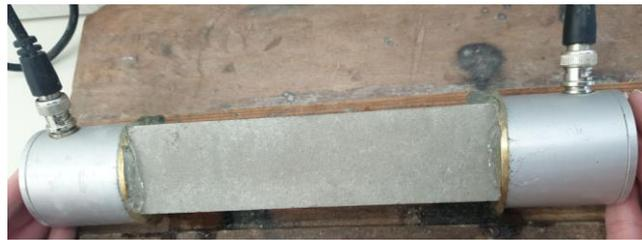
Slika 38. Ispitivanje ultrazvuka
