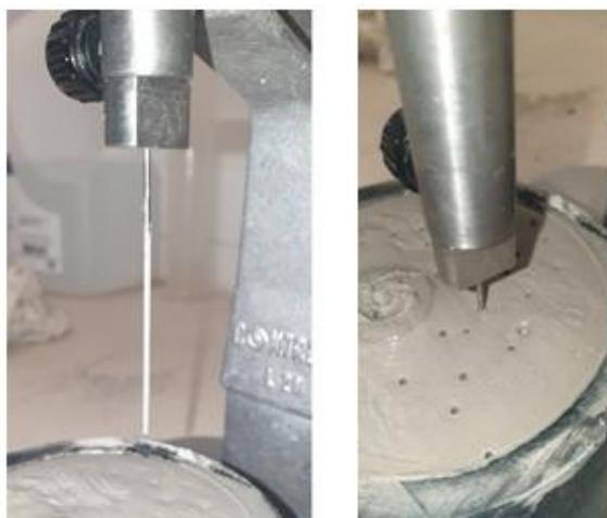
Slika 27. Ispitivanje vremena vezanja paste Vicatovom iglom
