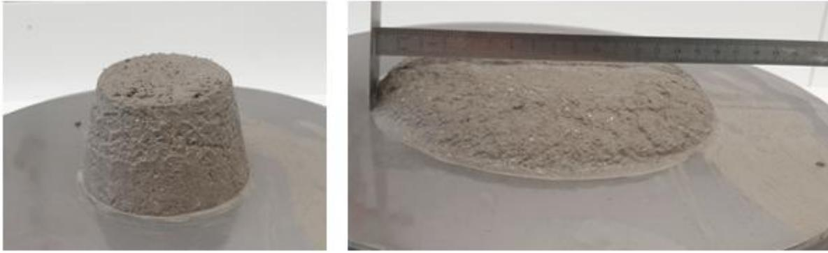
Slika 32. Obradljivost uzorka L2
