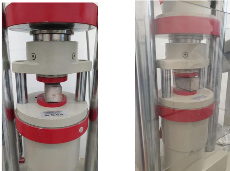
Slika 21. Uređaj za ispitivanje tlačne čvrstoće
