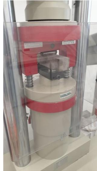
Slika 19. Uređaj za ispitivanje savojne čvrstoće
