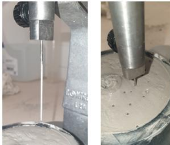
Slika 27. Ispitivanje vremena vezanja paste Vicatovom iglom
