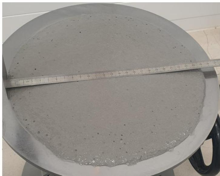
Slika 48. Obradljivost uzorka T4
