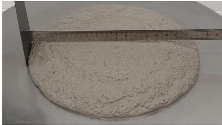
Slika 46. Obradljivost uzorka T1
