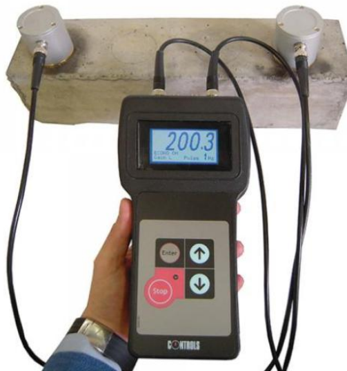
Slika 17. Uređaj za ispitivanje ultrazvuka (proizvođač Controls)
