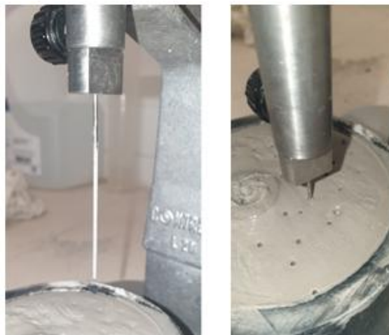
Slika 27. Ispitivanje vremena vezanja paste Vicatovom iglom
