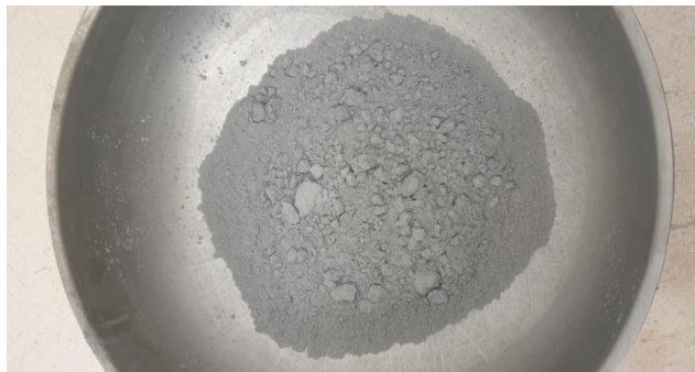
Slika 11. Upotrijebljen leteći pepeo u svrhu ispitivanja
