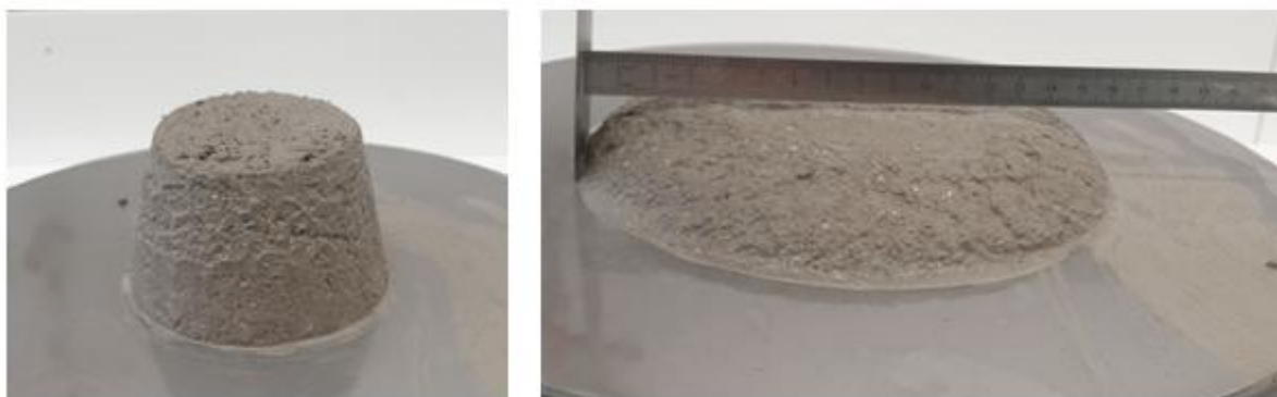
Slika 32. Obradljivost uzorka L2
