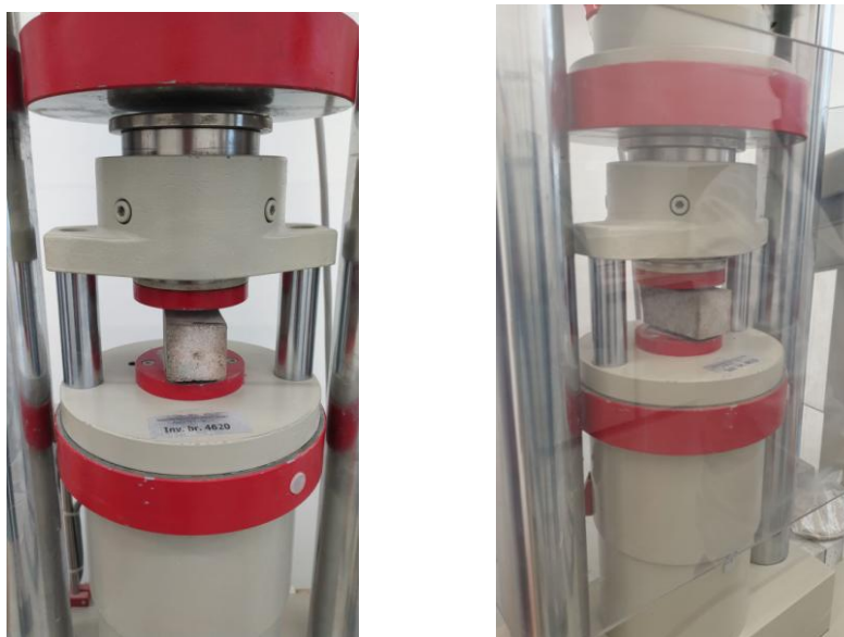
Slika 21. Uređaj za ispitivanje tlačne čvrstoće
