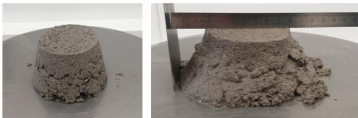
Slika 34. Obradljivost uzorka L4
