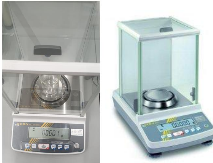
Slika 25. Kern ACJ-NM/ABS-N analitička vaga
