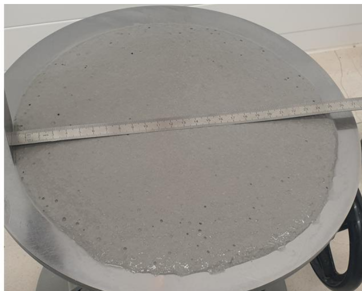
Slika 48. Obradljivost uzorka T4
