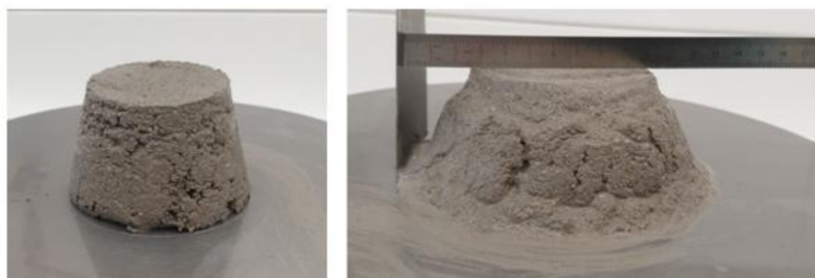
Slika 33. Obradljivost uzorka L3
