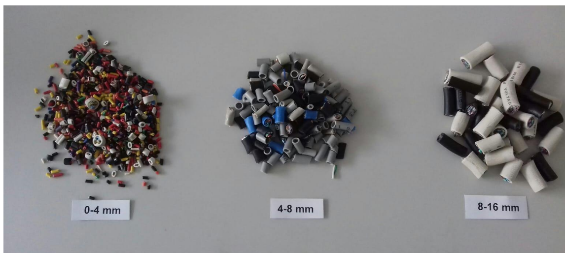
Slika 37 PVC kabeli korišteni za mješavine M1 – M6
