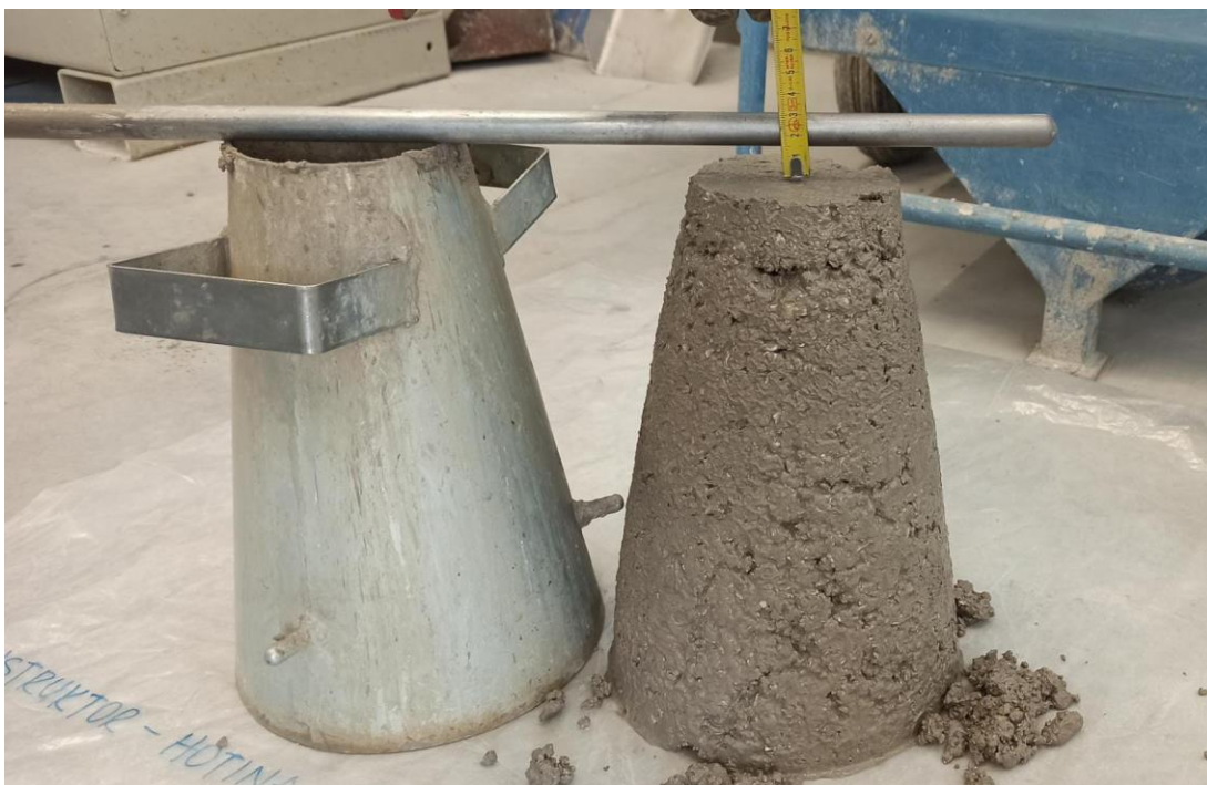
Slika 43 Slijeganje uzorka M3
