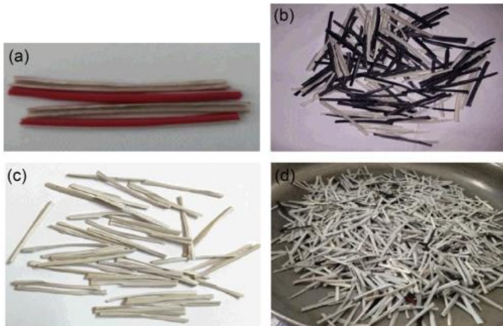
Slika 20 PVC vlakna iz e-otpada koja su istraživači koristili u betonu ((a) Gull i Balasubramanian, 2014.; (b) Kurup i Kumar, 2017.a; (c) Kurup i Kumar, 2017.b; (d) Nidhish i Arunima, 2017.). [2]
