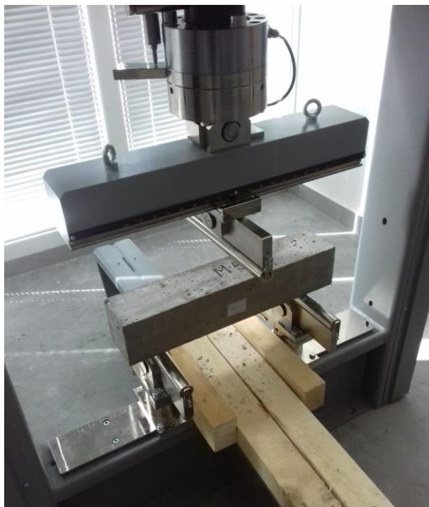
Slika 44 Primjer ispitivanja savojne čvrstoće
