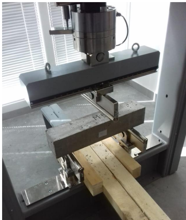
Slika 44 Primjer ispitivanja savojne čvrstoće
