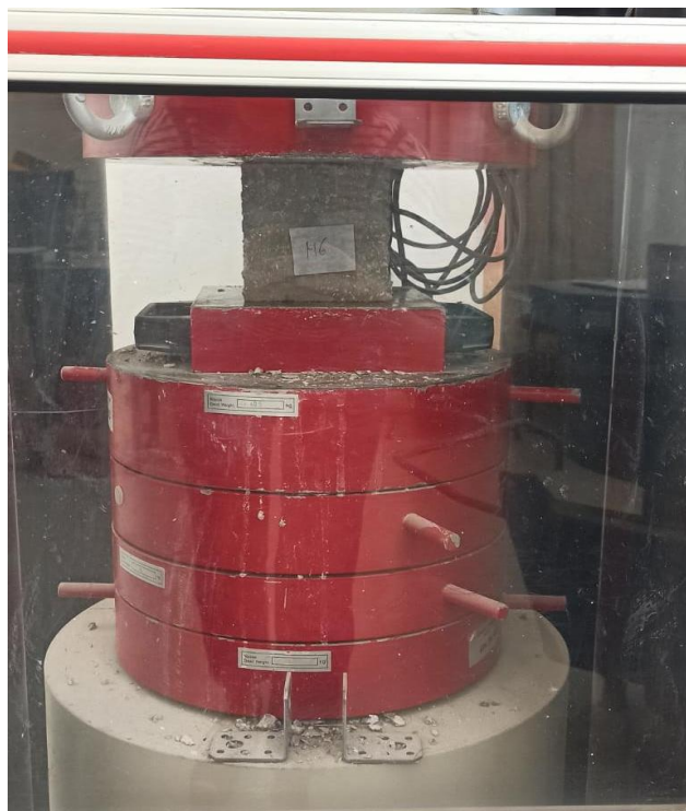
Slika 45 Primjer ispitivanja tlačne čvrstoće
