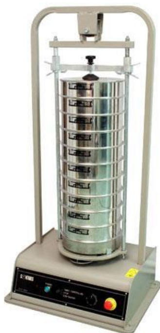
Slika 35 Sito za prosijavanje agregata [41]
