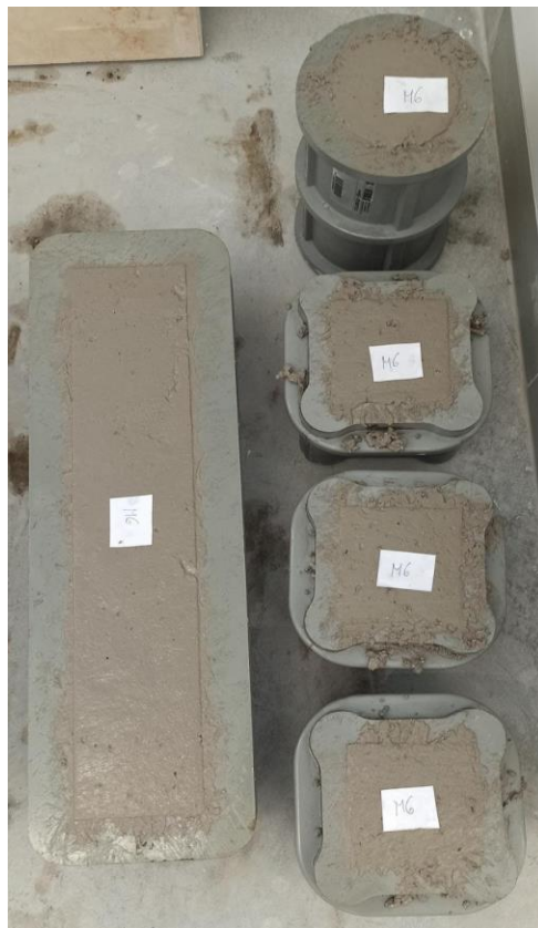
Slika 39 Ukalupljeni uzorci M6
