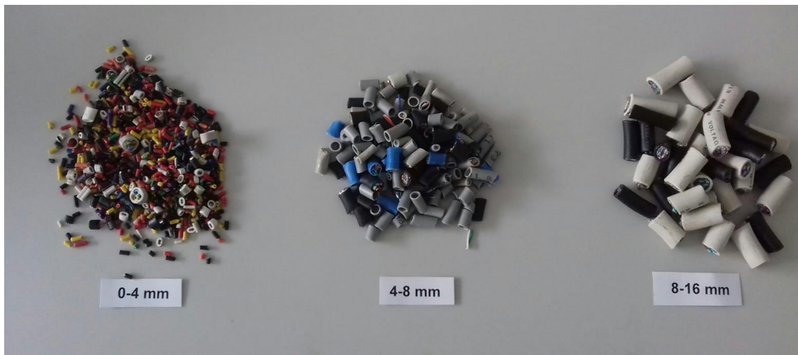
Slika 37 PVC kabeli korišteni za mješavine M1 – M6
