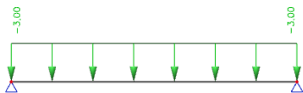
Slika 92. Korisno opterećenje na stubištu
