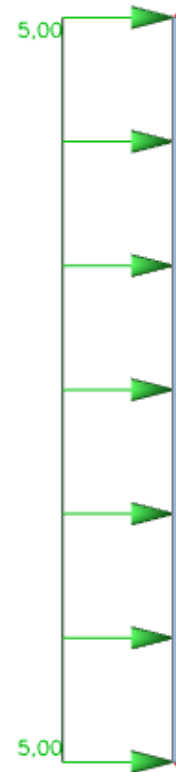
Slika 120. Korisno opterećenje na zid bazena
