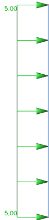
Slika 120. Korisno opterećenje na zid bazena
