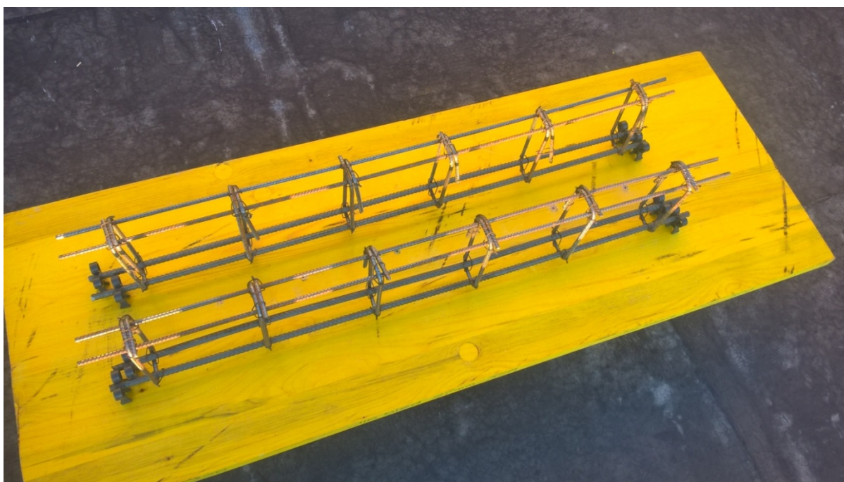
Fotografija 2.3: Armatura greda G1 i G2
