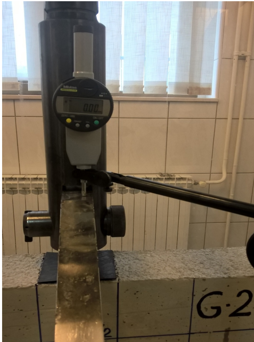
Fotografija 4.6: Slika postavljanja i nuliranja mikrouore
