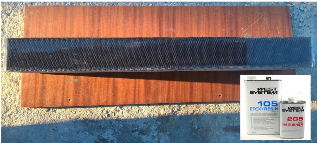
Fotografija 2.9: Greda G2 ojačana karbonskom trakom (pogled na preokrenutu gredu prilikom lijepljenja) i kantice s komponentama epoxy smole
