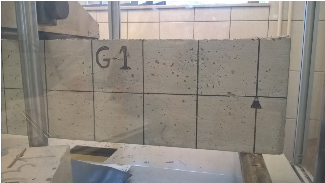
Fotografija 4.8: Pojava prvih pukotina na gredi G1
