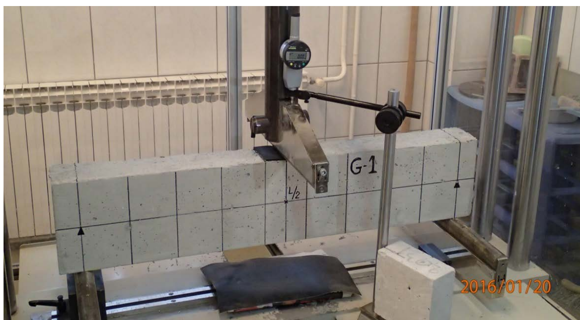
Fotografija 4.5: Rubni uvjeti oslanjanja grede i postavljena mikroura
