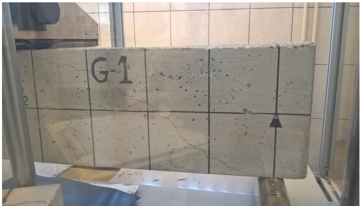
Fotografija 4.9: Širenje pukotina prije sloma na gredi G1
