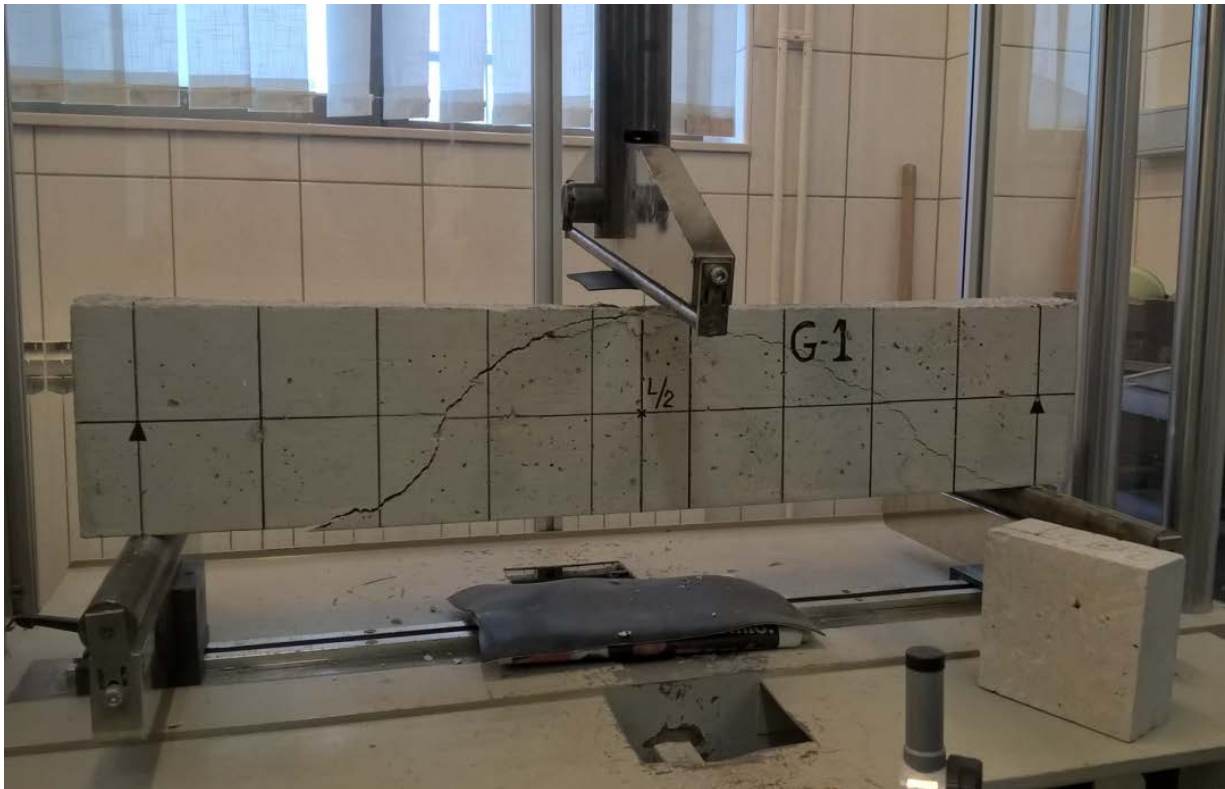
Fotografija 4.10: Slom i kraj ispitivanja grede G1
