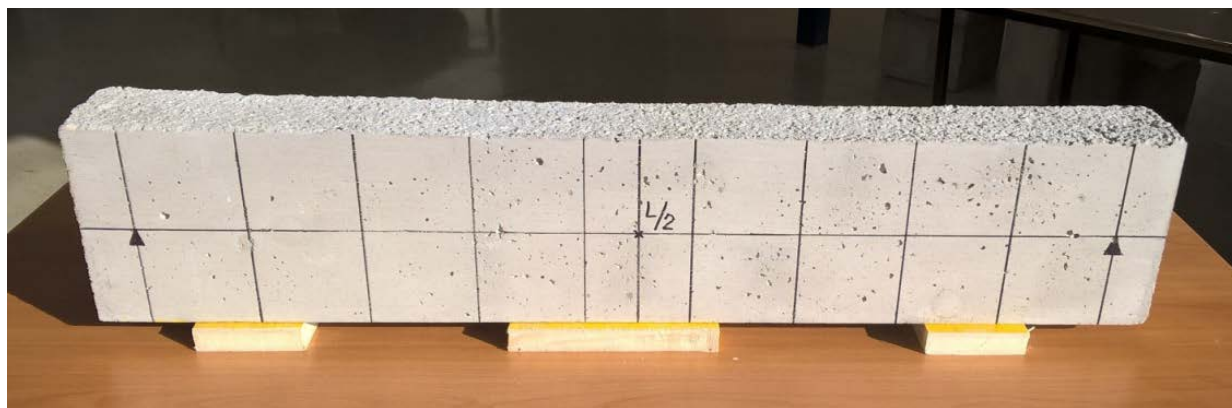
Fotografija 4.1: Greda G1 označena za ispitivanje
