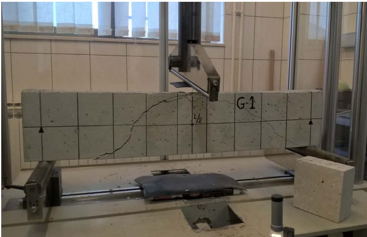
Fotografija 4.10: Slom i kraj ispitivanja grede G1
