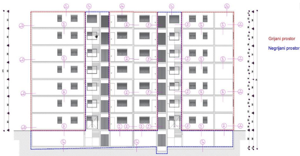
Slika 81. Presjek zgrade sa ucrtanom granicom grijanog/negrijanog prostora
