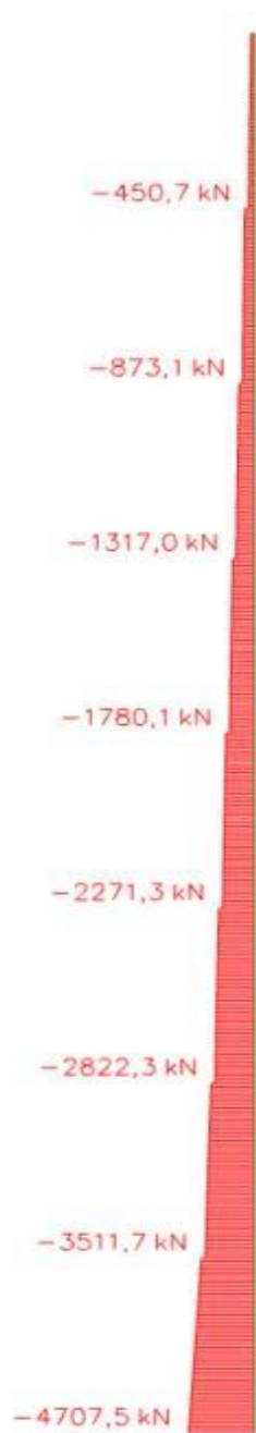
Slika 69. Dijagram uzdužnih sila N za anvelopu potresnih kombinacija
