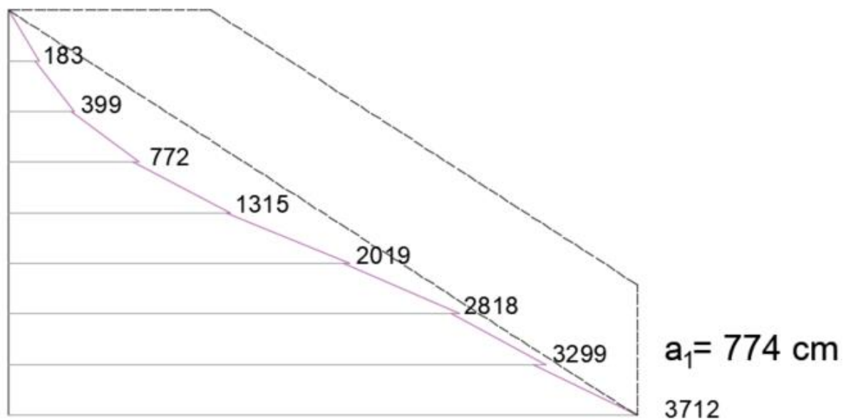
Slika 70. Ovojnica momenata savijanja
