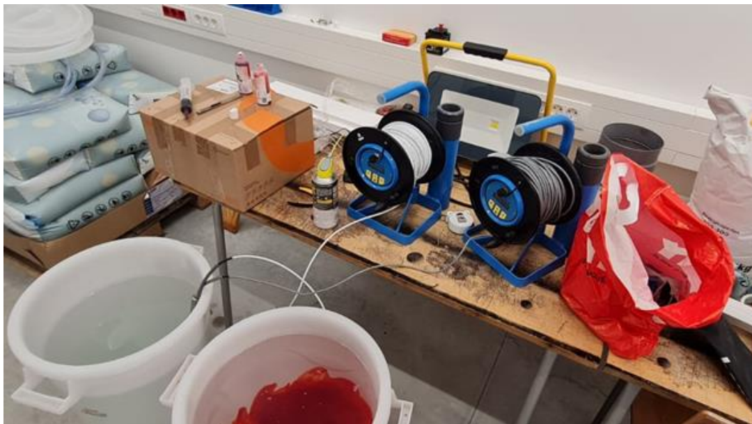
Slika 8 Sonde za mjerenje parametara i bojanje slane vode
