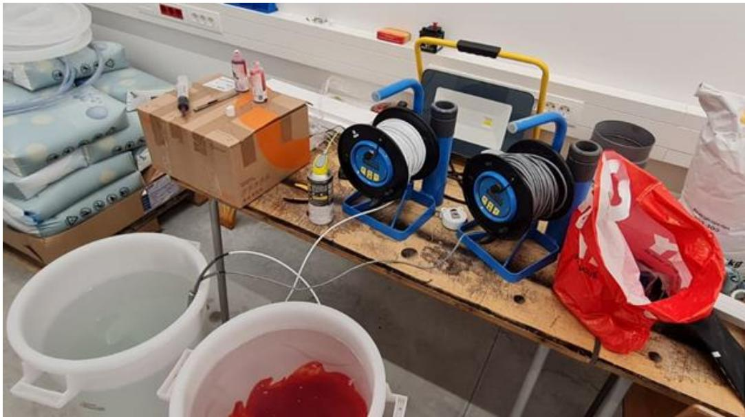
Slika 8 Sonde za mjerjenje parametara i bojanje slane vode
