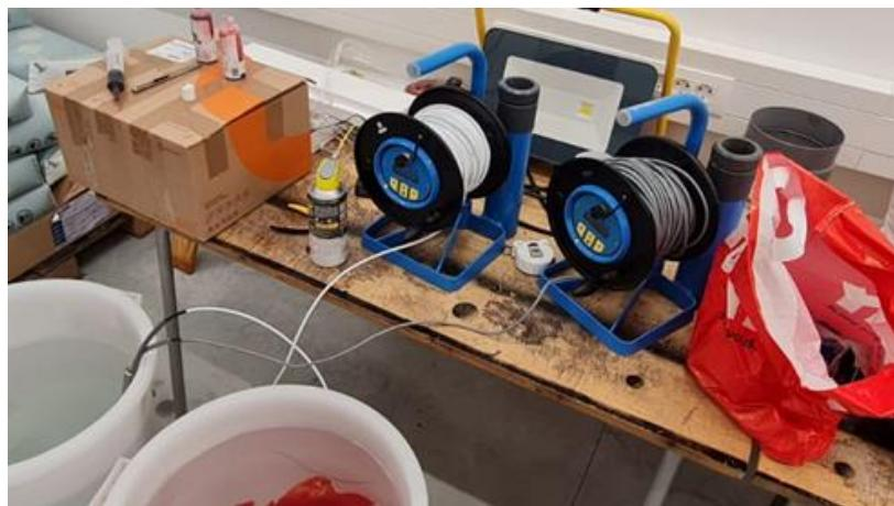
Slika 6 Multi - senzorska sonda za mjerjenje parametara vode
