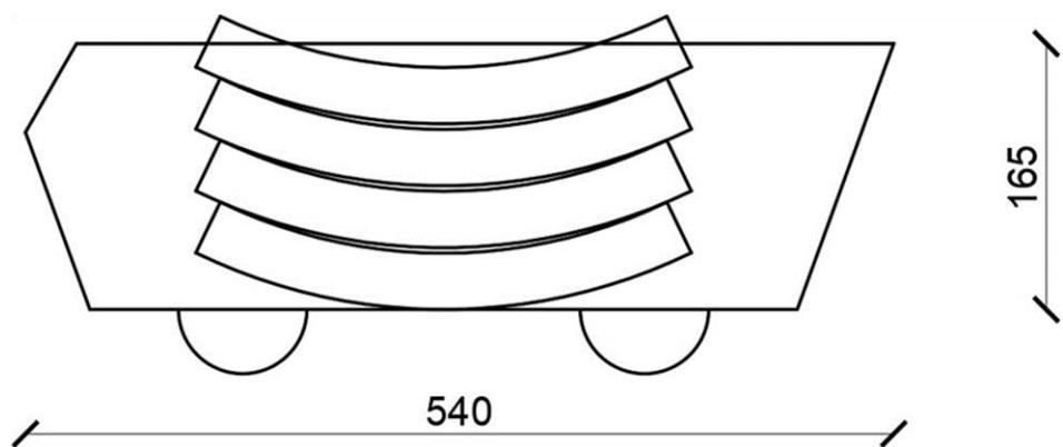
Slika 4.3: Grafički prikaz smještanja betonskih segmenata u vagonete [9]
