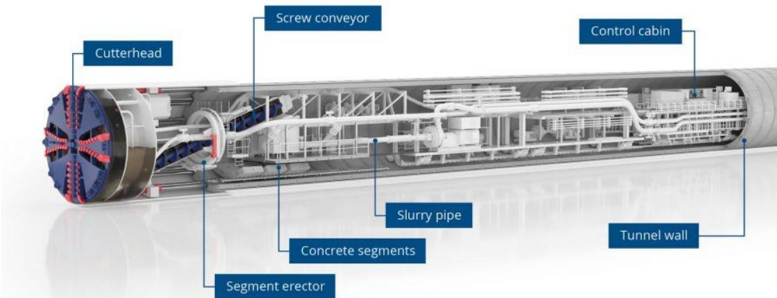
Slika 2.1: Shema TBM-a [3]
