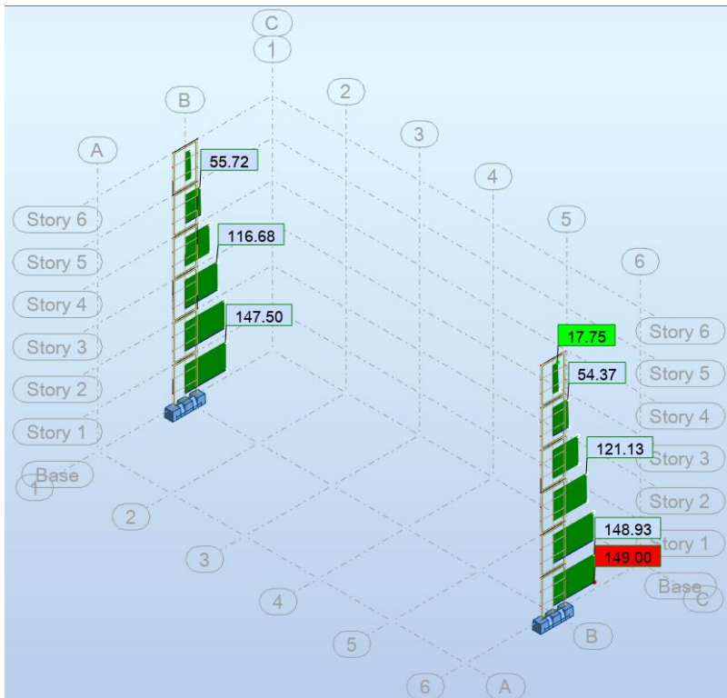
Slika 6.2 Maksimalna uzdužna sila za 1. kombinaciju
