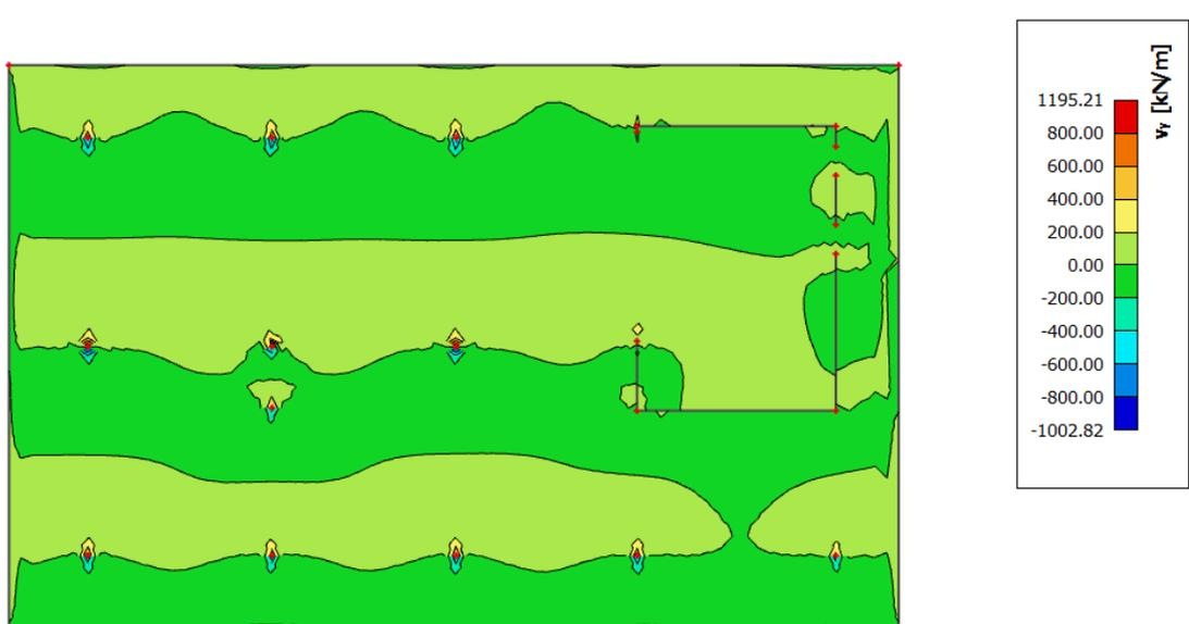
Slika 6.18 Poprečne sile  $V_{Ed,y}$  (kN/m) za GSN-1
