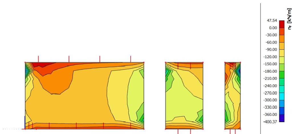
Slika 8.5 Uzdužne sile  $n_{Ed}$  [kN/m] u smjeru Y, u zidovima za anvelopu GSN1
