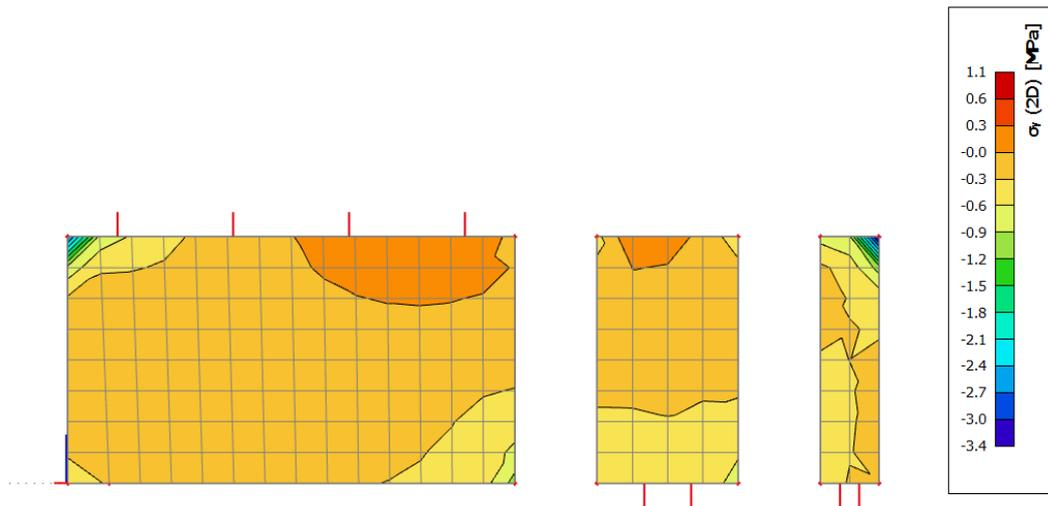
Slika 8.3 Glavna tlačna naprezanja  $\sigma_{c,Ed}$  [MPa] u zidu za nazovistalnu kombinaciju GSU1
