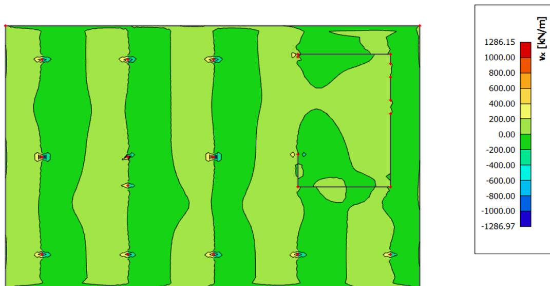
Slika 6.17 Poprečne sile  $V_{Ed,x}$  (kN/m) za GSN-1
