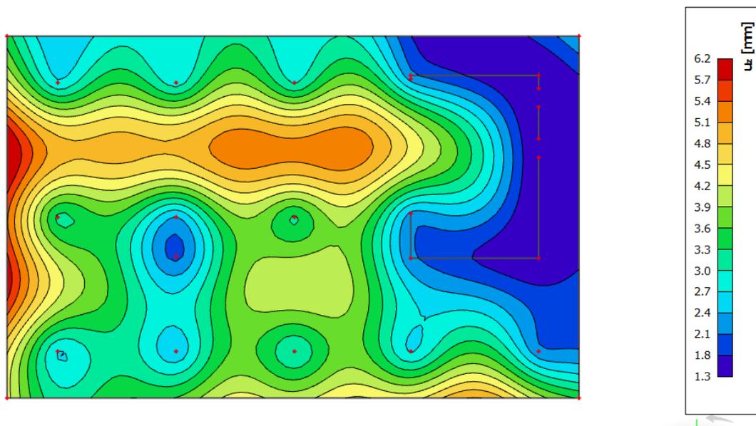
Slika 6.21 Progib ploče (mm) za kombinaciju GSU-1
