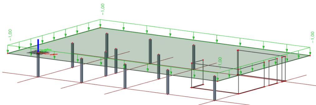
Slika 4.1.2 Promjenjivo djelovanje  $Q$  [ $\text{kN/m}^2$ ]
