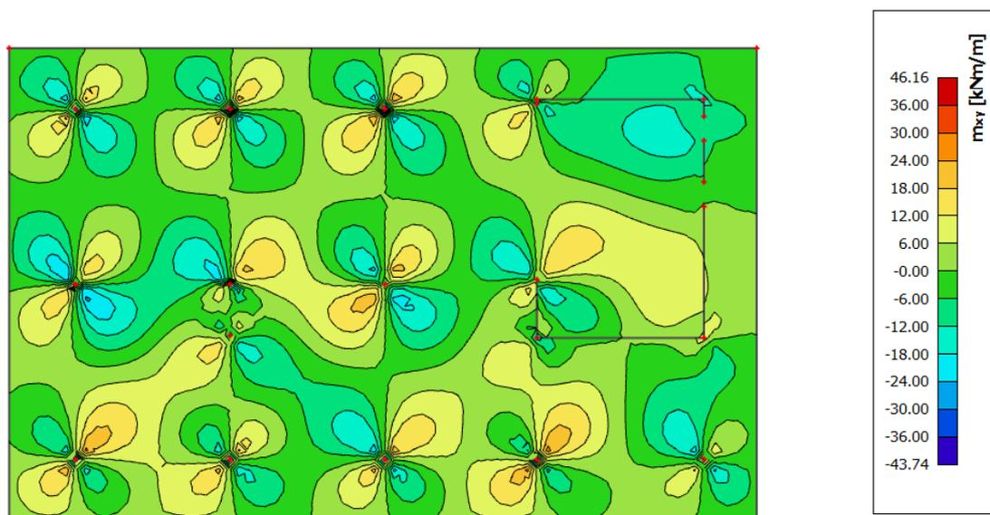
Slika 6.16 Moment savijanja  $M_{Ed,xy}$  (kNm/m) za GSN-1
