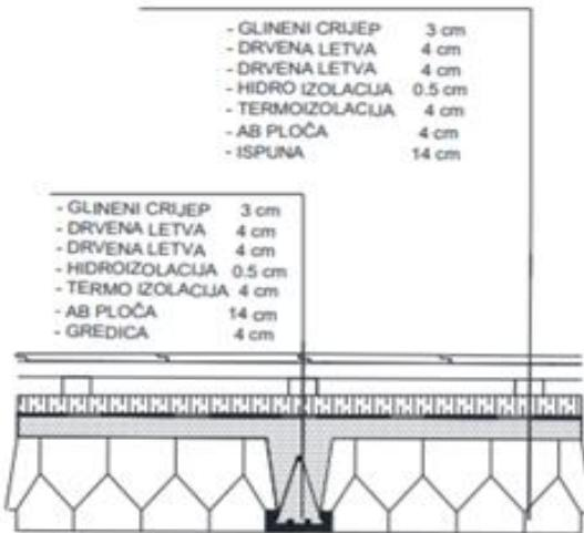
Slika 5: Skica polumontažnog krova s navedenim slojevima
