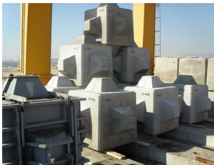
Slika 4.7.3. Detalj Cubipod elementa
