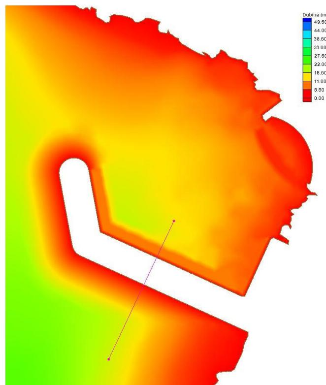
Slika 3.5.11. Identifikacija kontrolnog presjeka na trupu lukobrana
