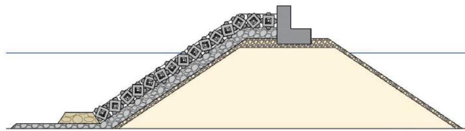
Slika 4.7.4. Karakteristični poprečni presjek lokobrana od Cubipod elemenata
