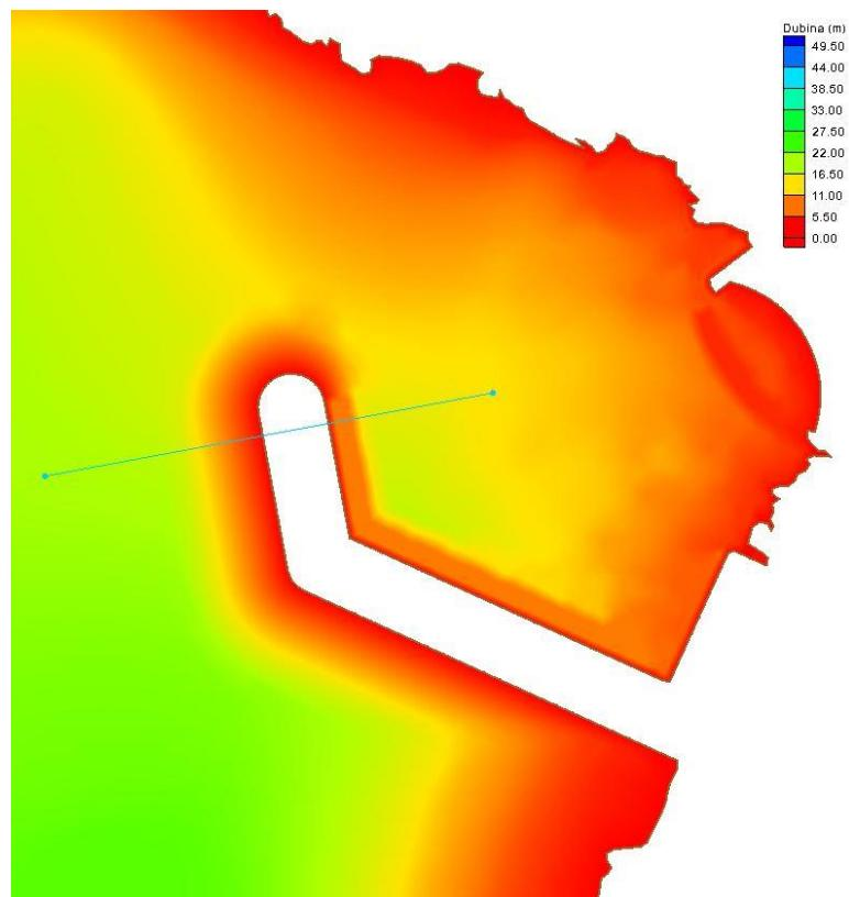
*Slika 3.5.8. Identifikacija kontrolnog presjeka na glavi lukobrana*
