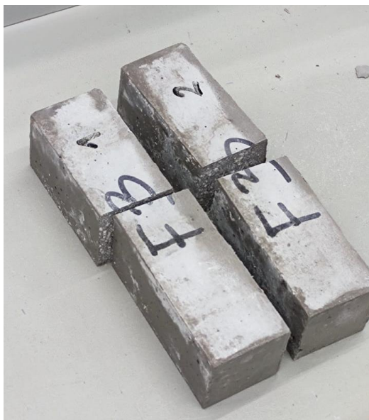
Slika 18, Polovice prizmi nakon ispitivanja savojne čvrstoće
