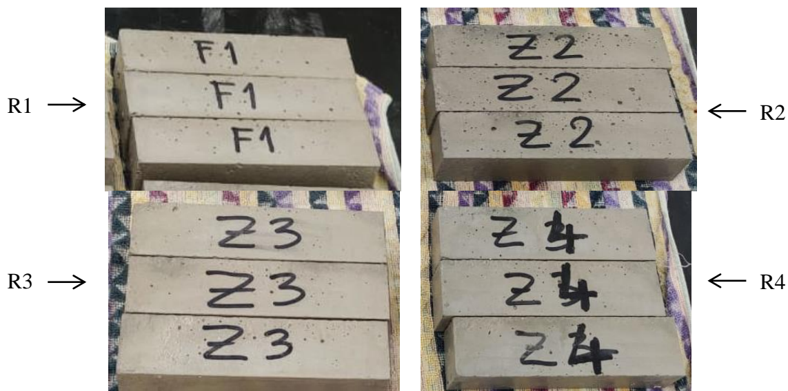
Slika 14, Vodom zasićeni uzorci [slike zabilježene tijekom ispitivanja]
