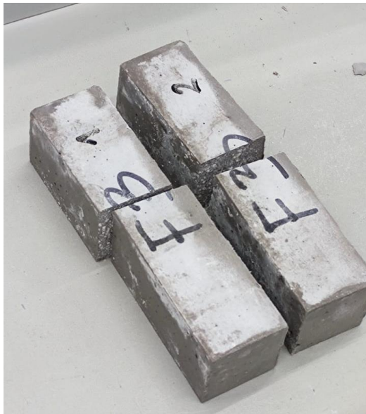
Slika 18, Polovice prizmi nakon ispitivanja savojne čvrstoće
