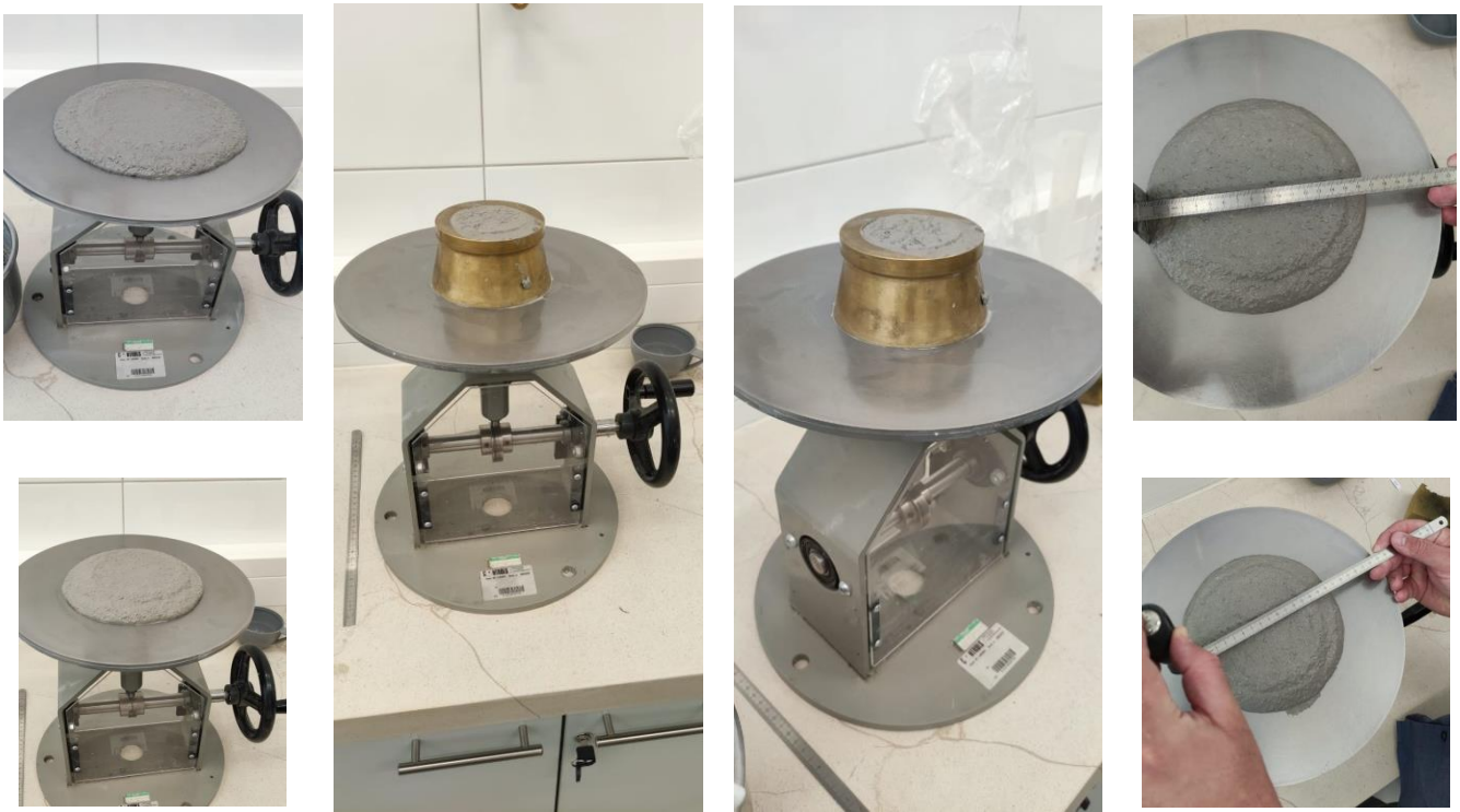
Slika 11, Ispitivanje obradivosti [Slike zabilježene tijekom ispitivanja]
