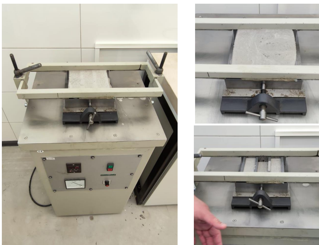
Slika 12, Svježi mort u kalupima na vibro stolu [slike zabilježene tijekom ispitivanja]
