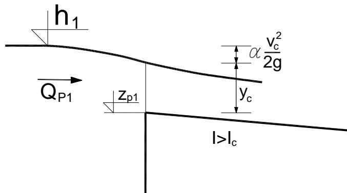
Slika 2. Izljevanje kroz preljevnu cijev iz prvog spremnika
