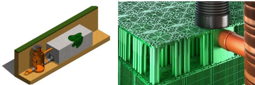
Slika 8.1. Infiltracija oborinske vode- (Raineo stormbox- katalog Pipelife)
