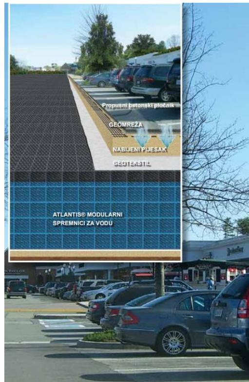
**Slika 9.10.** Modularni spremnici za skladištenje vode sa nepropusnim dnom (Green city design, Case Study)
