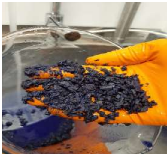
Slika 8. Prikaz uzorka 19/20 - frakcija < 5 mm na kraju pokusa
