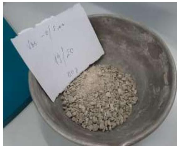
Slika 6. Uzorak 19/20 - frakcija  $<5\text{ mm}$
