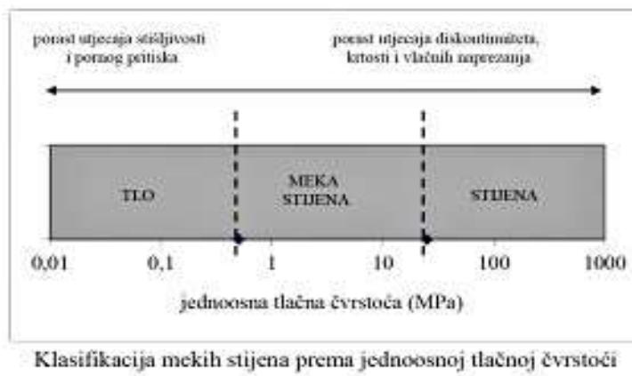
Slika 1. Klasifikacija mekih stijena prema jednoosnoj tlačnoj čvrstoći (Miščević, 2015.)
