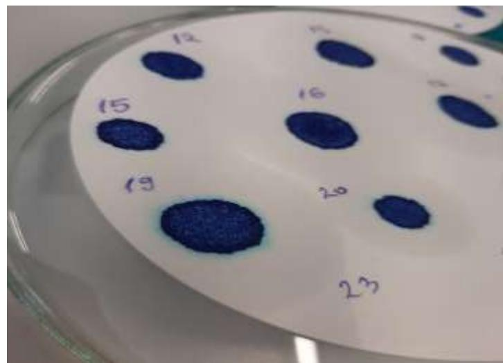
Slika 2. Prikaz kapljice otopine s uzorkom na filter papiru - svjetloplavi obruc oko kapljice
