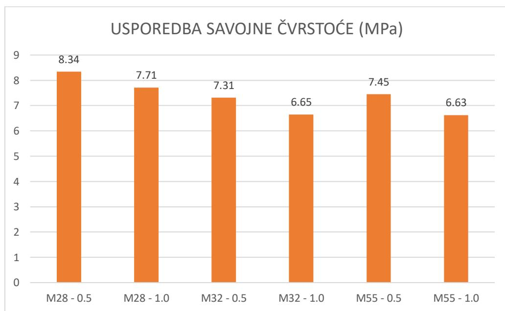
Slika 42. Usporedba savojne čvrstoće sa prijašnjim ispitivanjem
