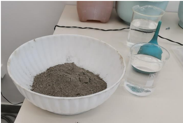
Slika 32. 450 g cementa i 225 g vode za miješanje
