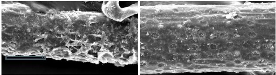
Slika 12. Netretirano vlakno i tretirano vlakno morskom vodom[12]
