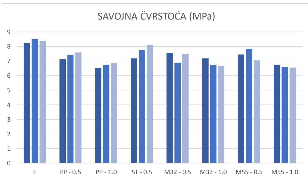
Slika 37. Pojedinačne vrijednosti rezultata savojne čvrstoće uzoraka
