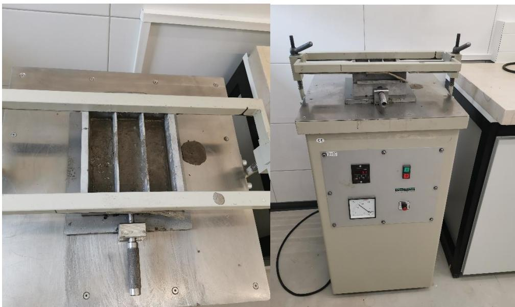
Slika 35. Trodijelni kalup i vibracijski stol
