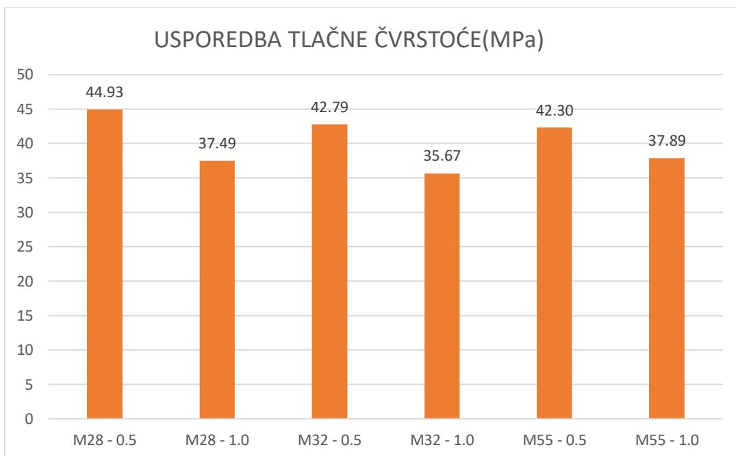
Slika 43. Usporedba tlačne čvrstoće sa prijašnjim ispitivanjem
