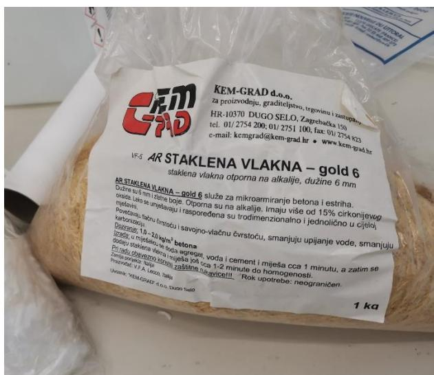
Slika 27. Staklena vlakna duljine 6 mm
