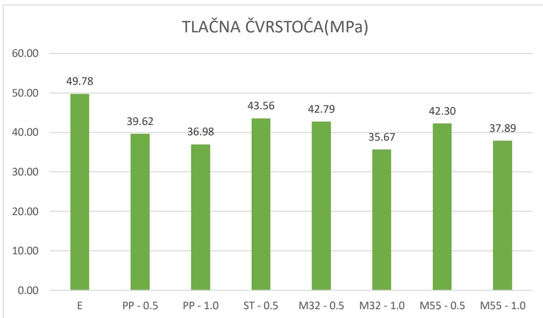
Slika 41. Srednje vrijednosti rezultata tlačne čvrstoće uzoraka
