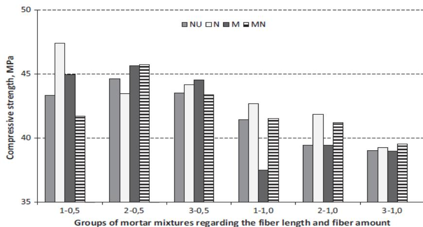
Slika 19. Tlačna čvrstoća različitih mješavina morta[17]
