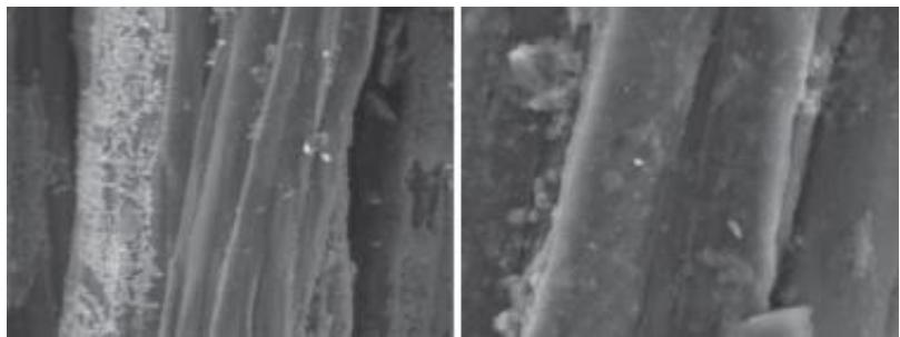
Slika 4. Tretirana vlakna 75 dana čuvana u slanoj vodi[11]
