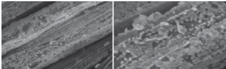
Slika 5. Netretirana vlakna čuvana 75 dana u slanoj vodi[11]
