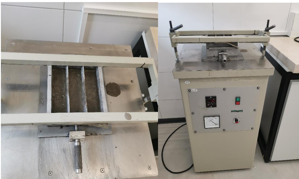
Slika 35. Trodijelni kalup i vibracijski stol
