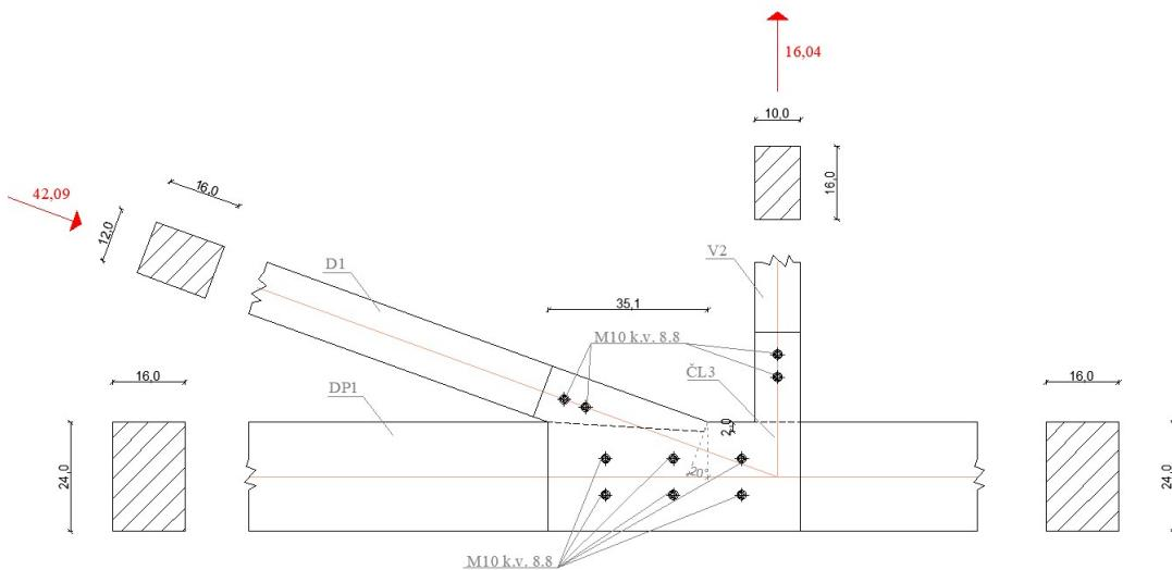
Slika 67. Spoj donjeg pojasa DP1, dijagonalne ispune D1 i vertikalne ispune rešetke V2
