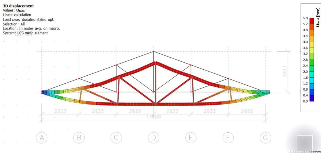
Slika 24. Progib rešetke uslijed djelovanja dodatnog stalnog opterećenja
