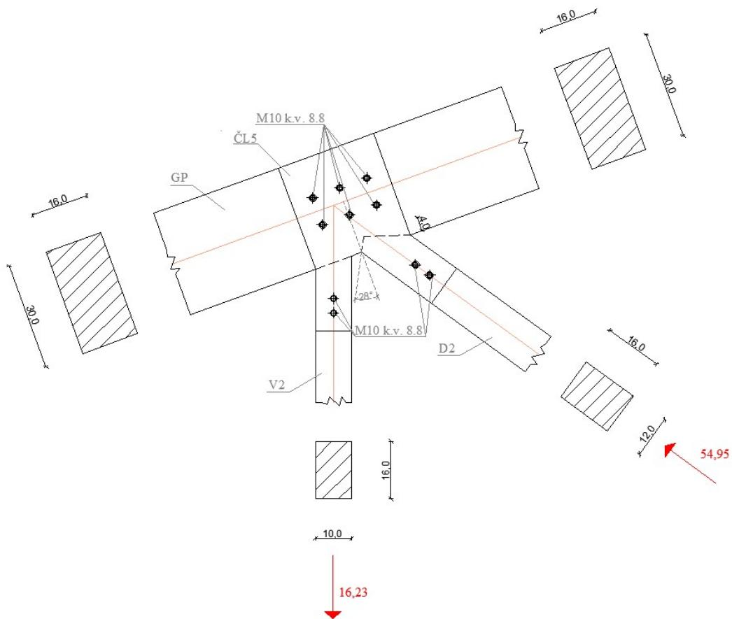
Slika 69. Spoj gornjeg pojasa GP, vertikalne ispune rešetke V2 i dijagonalne ispune rešetke D2
