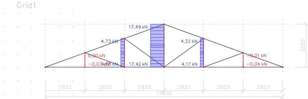
Slika 58. N-dijagram vertikala glavnog nosača uslijed djelovanja najkritičnije požarne kombinacije
