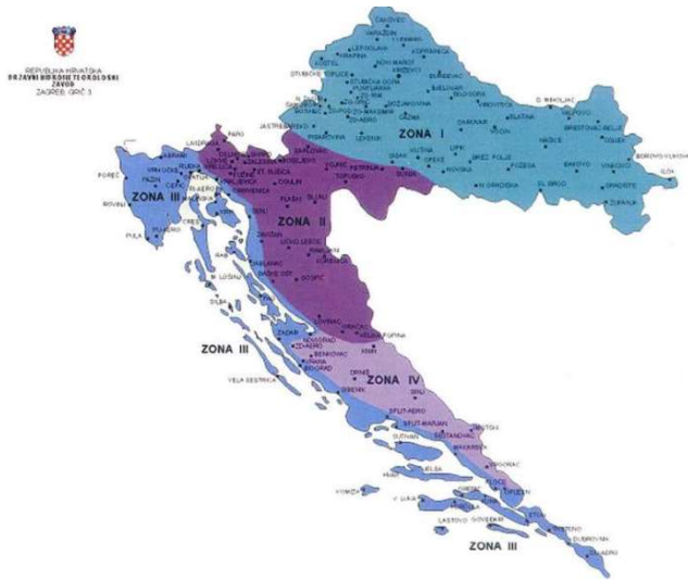
Slika 3. Klimatske zone karakterističnog opterećenja snijegom s_k
