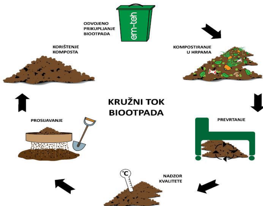
Slika 33. Kompostiranje bio otpada [izvor: http://www.emteh.hr/kompostiranje-bio-otpada/ , 2016.]
