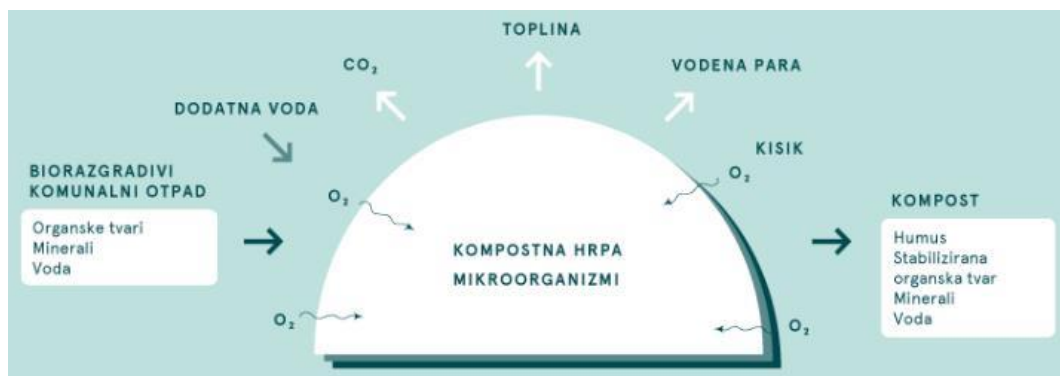
Slika 34. Ulazi i izlazi tvari u procesu kompostiranja [izvor: http://www.emteh.hr/kompostiranje-bio-otpada/ ]
