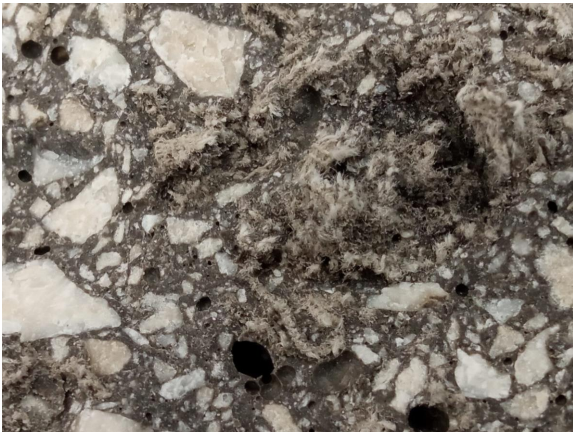
Slika 5.17: Detalj loma uzorka TX3.5 nastao savijanjem
