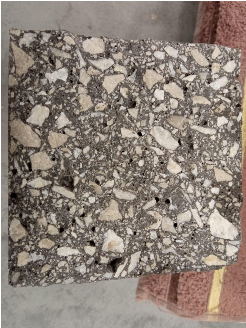
Slika 5.14: Lom etalona nastao savijanjem
