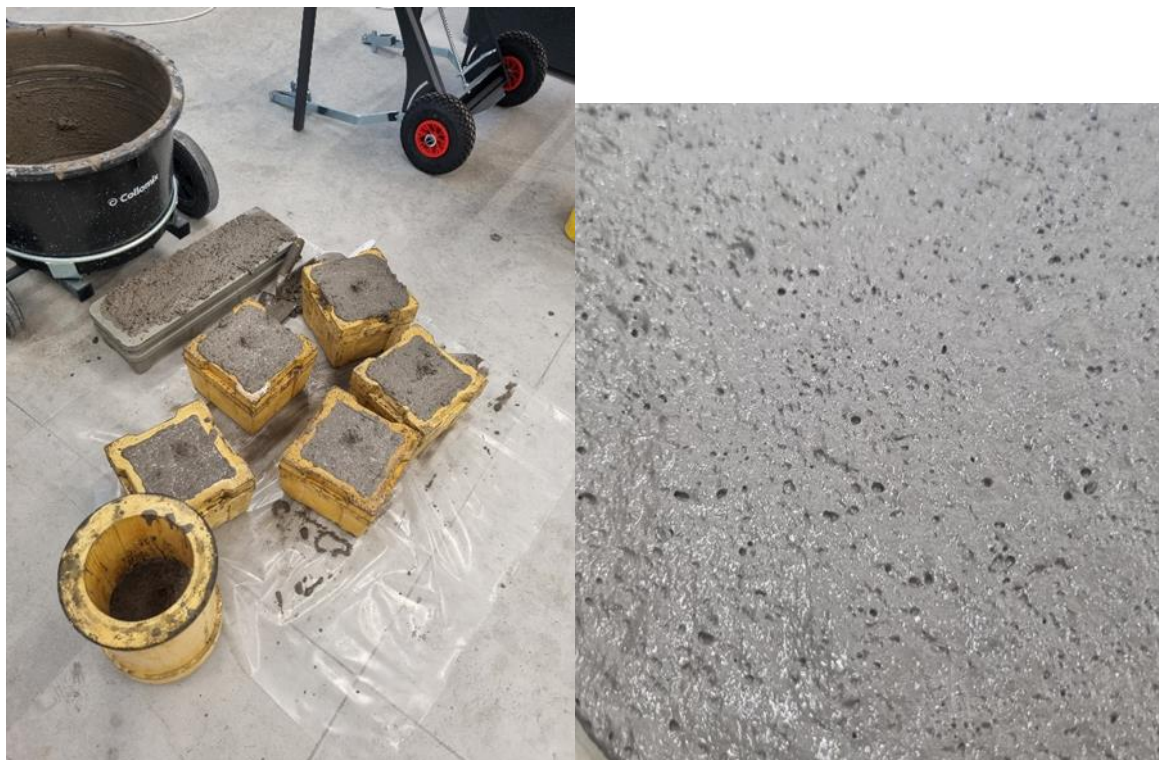
Slika 4.7: Lijevo-izrada ispitnih tijela, desno-detalj pjenjenja betona M1.0
