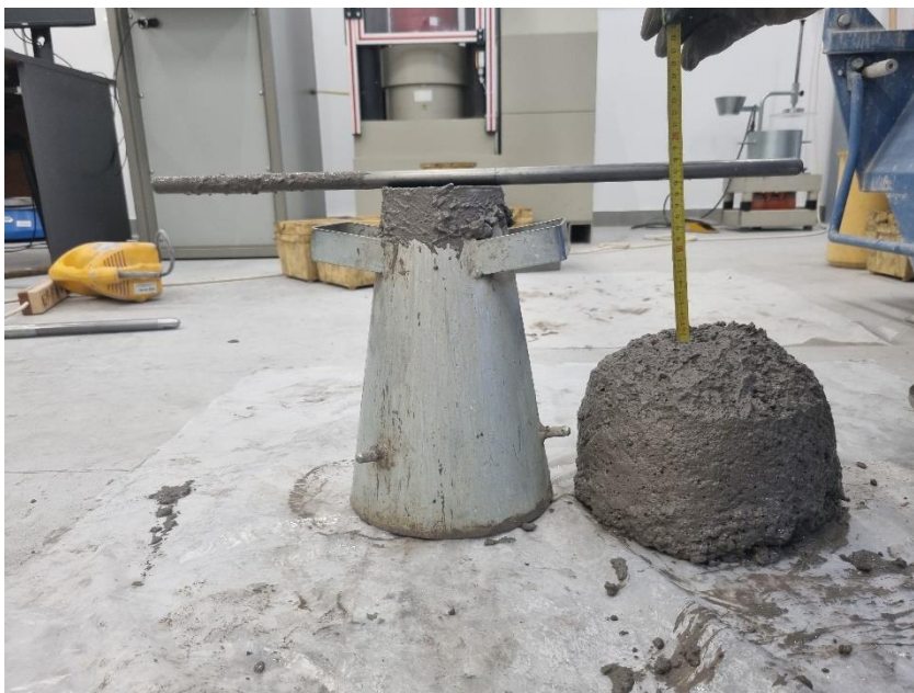
Slika 5.4: Mjerenje slijeganja za mješavinu M1.0
