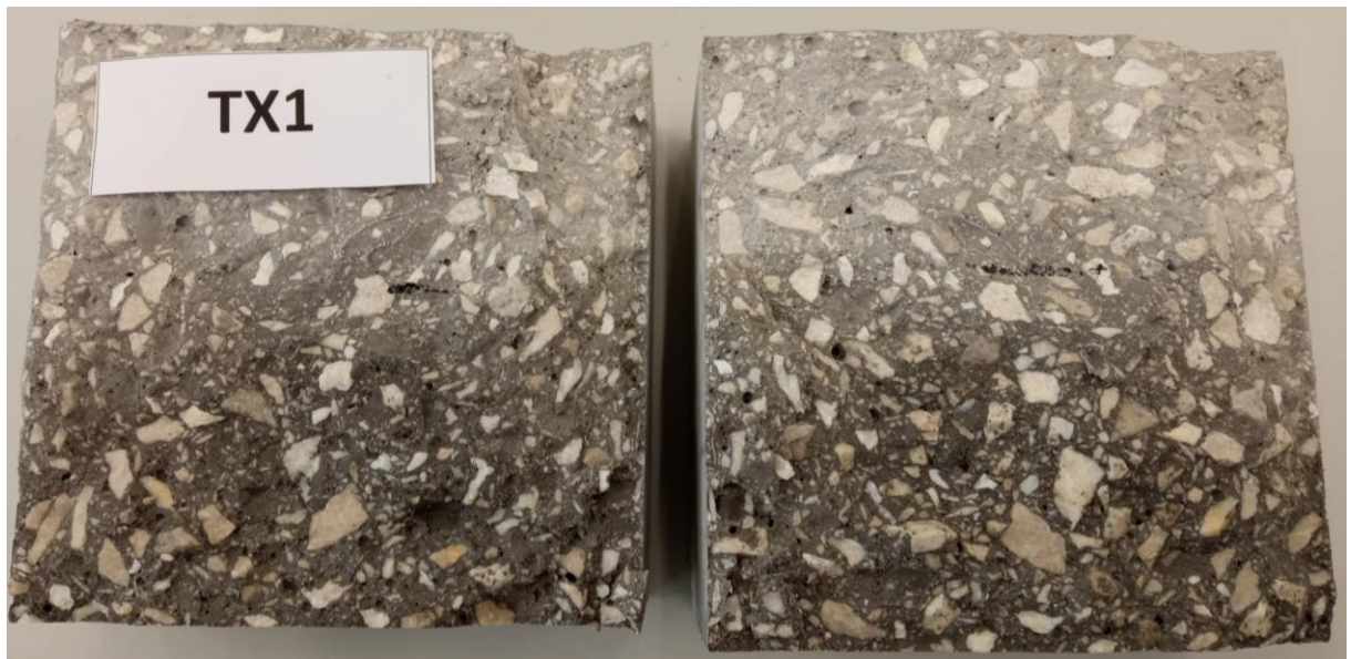
Slika 5.37: Detalj prodora vode u uzorak TX1.7
