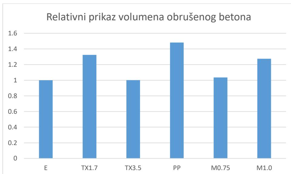
Slika 5.30: Relativni prikaz obrušenog betona nakon 16 ciklusa
