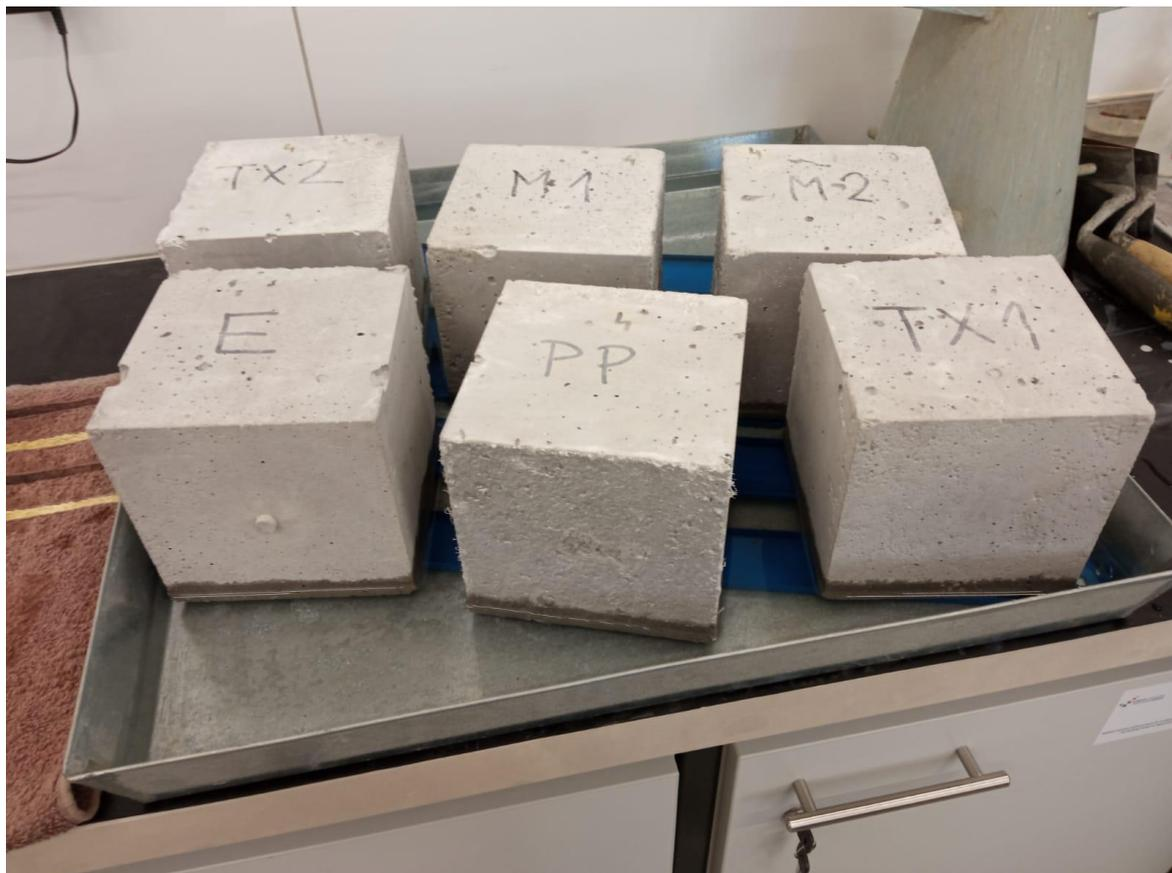
Slika 4.13: Ispitivanje kapilarnog upijanja
