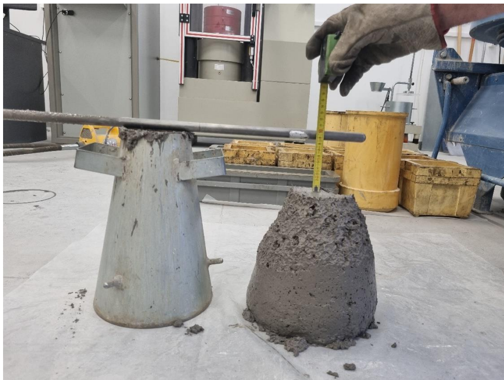
Slika 5.5: Mjerenje slijeganja za mješavinu M0.75
