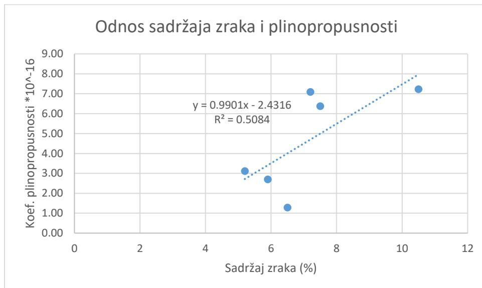
Slika 5.33: Odnos sadržaja zraka u betonu i plinopropusnosti
