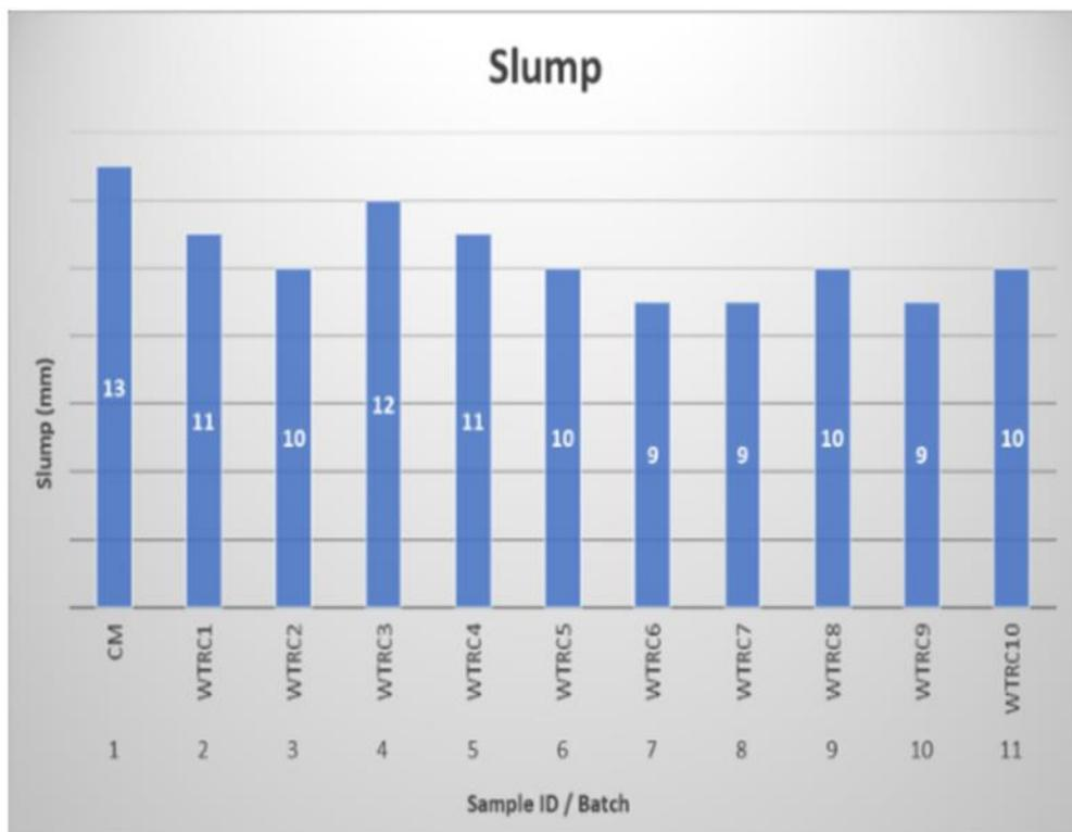
Slika 3.2: Rezultati mjerenja slijeganja svježeg betona [11]
