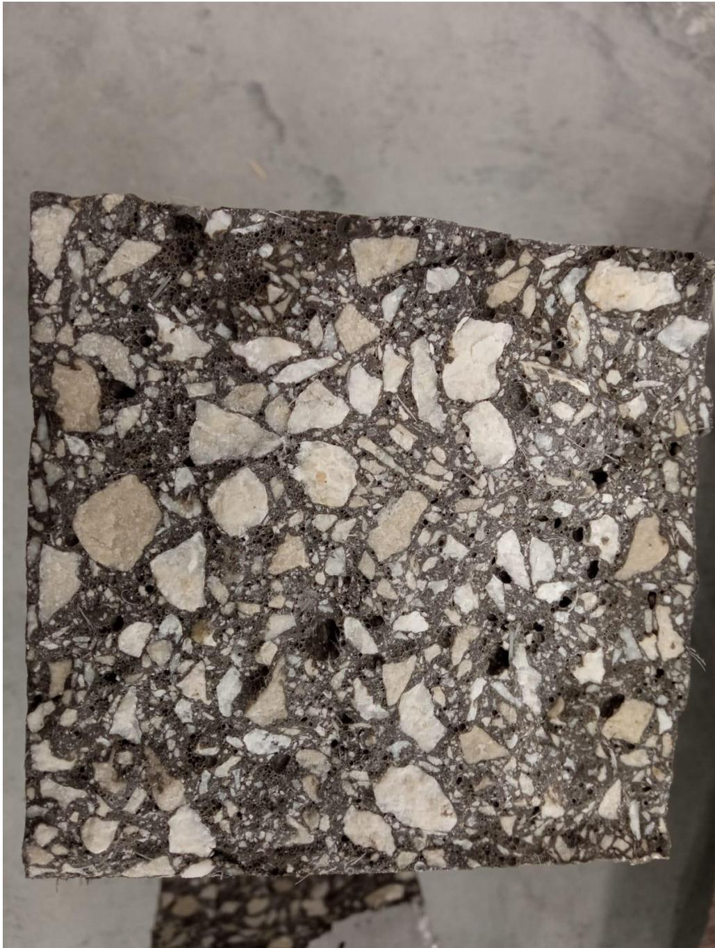
*Slika 5.15: Lom uzorka PP nastao savijanjem*
