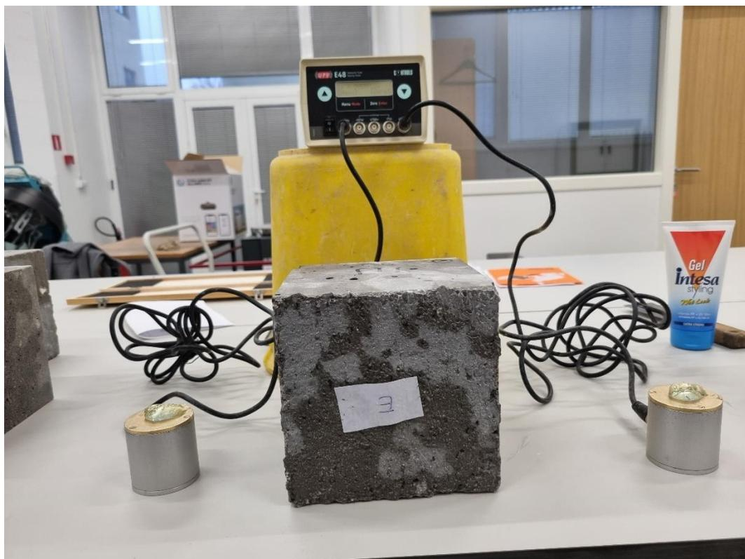
Slika 4.12: Mjerenje brzine ultrazvučnih valova kroz betonsku kocku
