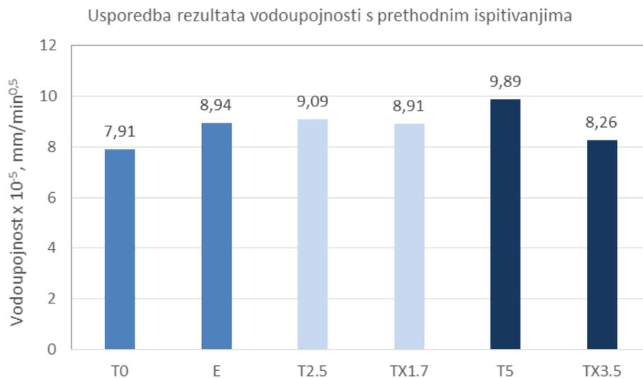
Slika 5.25: Usporedba rezultata vodoupojnosti s prethodnim istraživanjem
