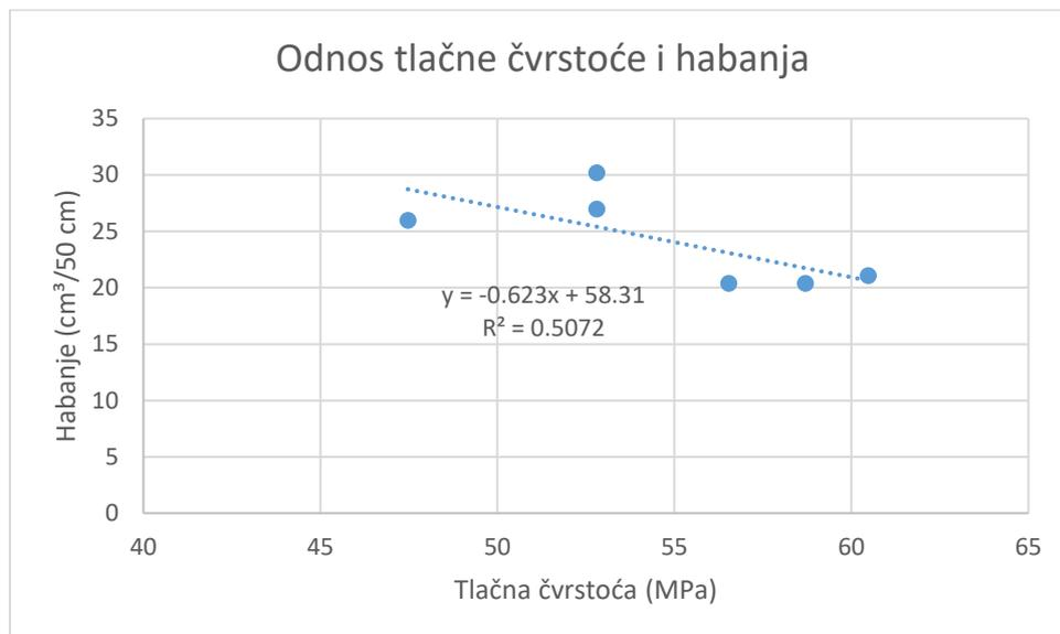
Slika 5.31: Odnos tlačne čvrstoće betona i habanja
