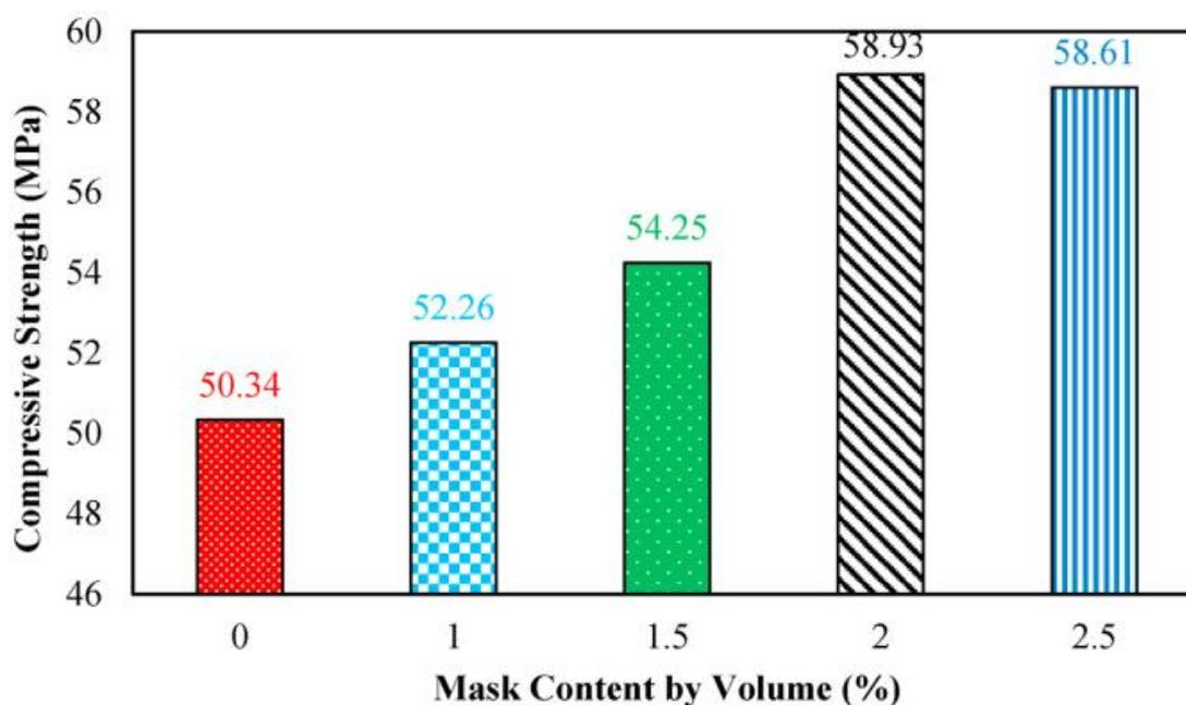
Slika 3.6: Rezultati ispitivanja tlačne čvrstoće betona [13]
