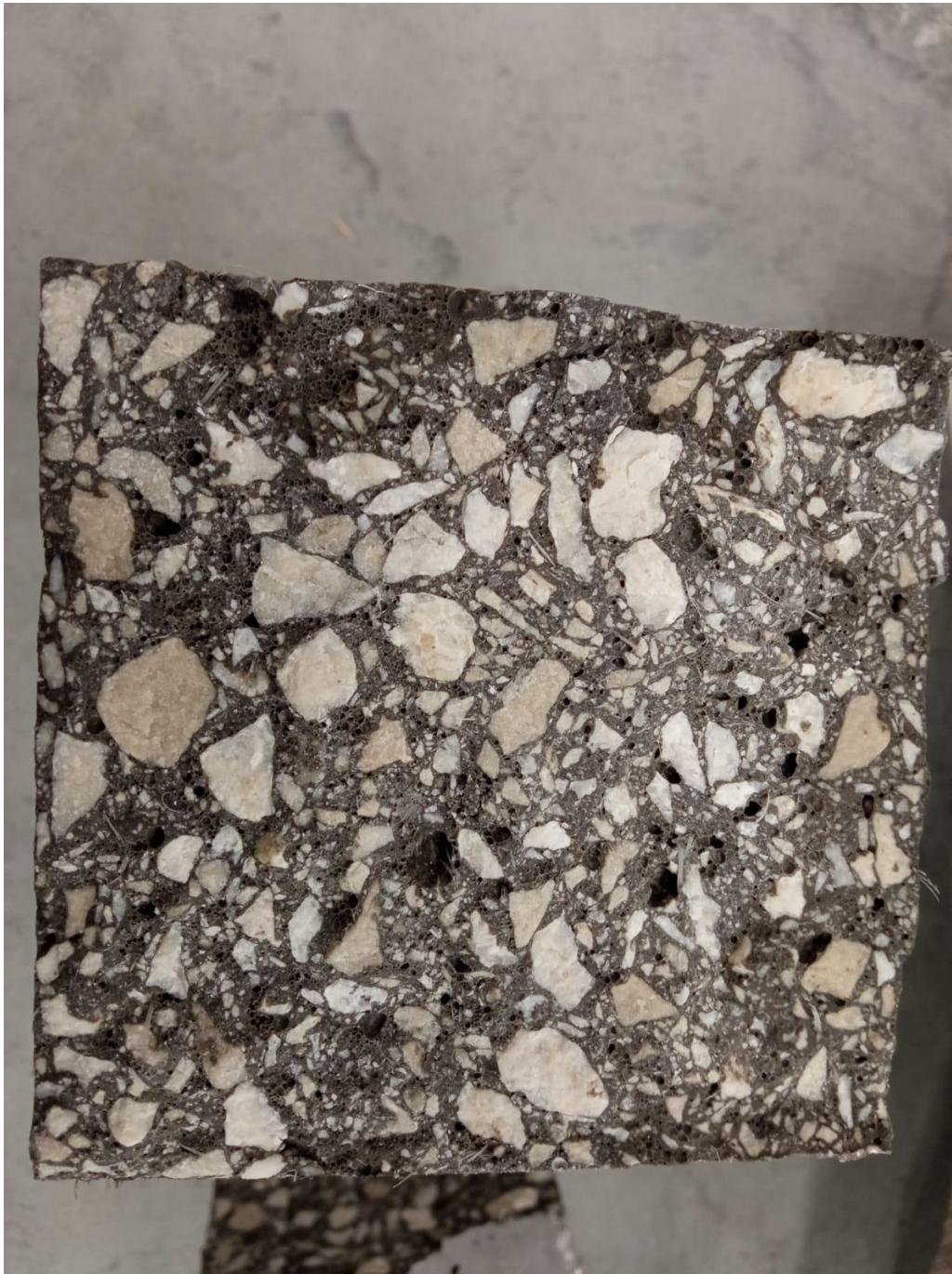
Slika 5.15: Lom uzorka PP nastao savijanjem
