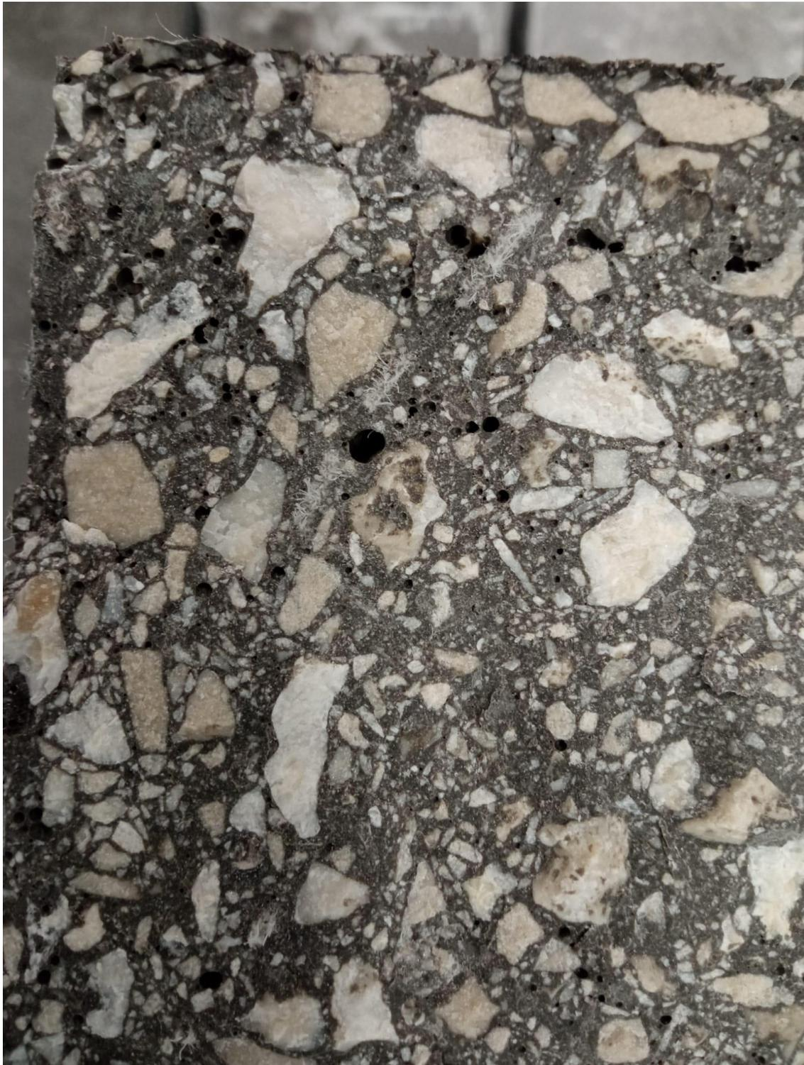
*Slika 5.18: Detalj loma uzorka M0.75 nastalog savijanjem*
