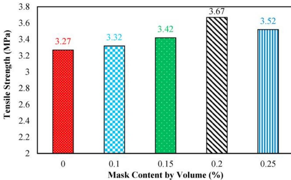
Slika 3.8: Rezultati ispitivanja indirektnje vlačne čvrstoće [13]
