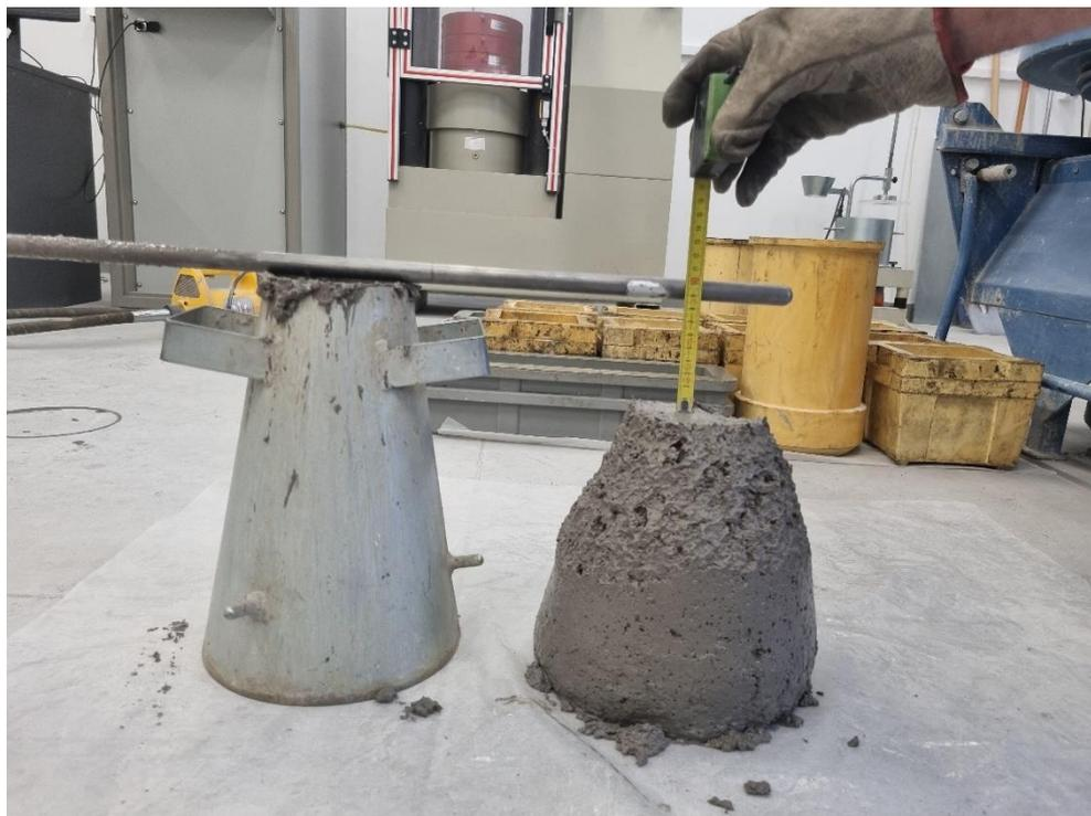
Slika 5.5: Mjerenje slijeganja za mješavinu M0.75
