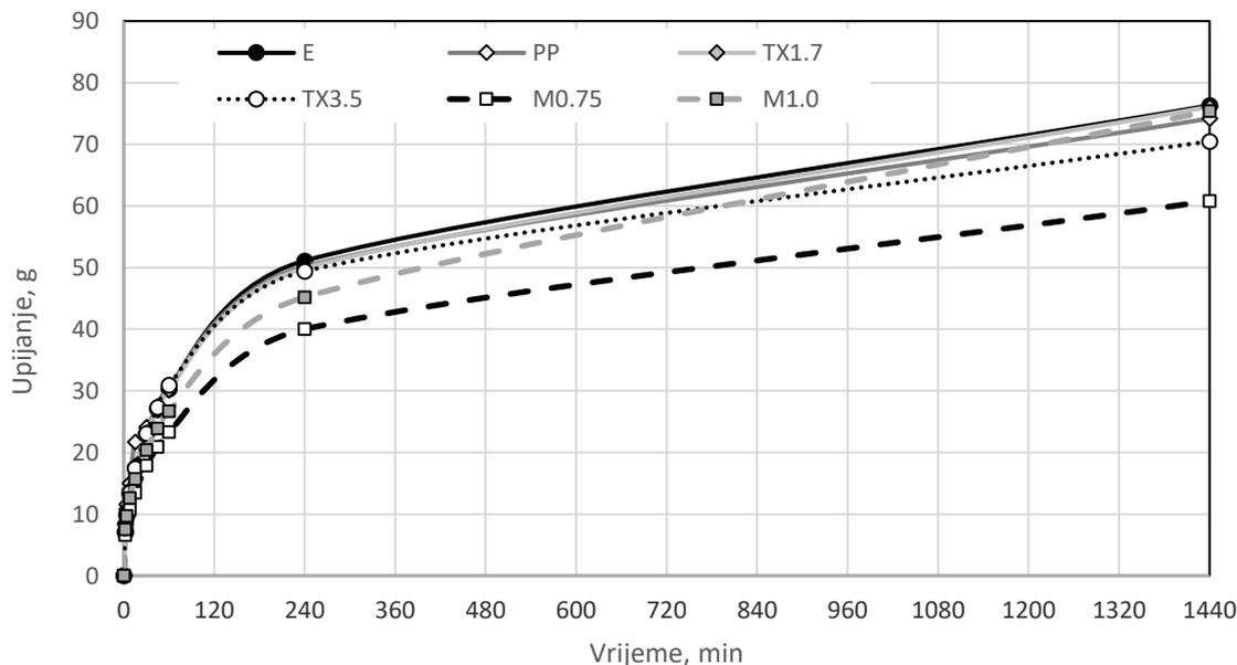
Slika 5.23: Dijagram kapilarnog upijanja betona
