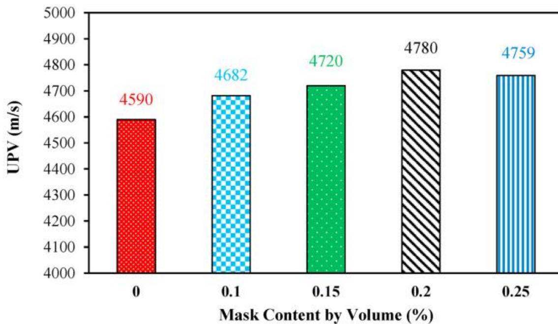
Slika 3.7: Rezultati mjerenja brzina ultrazvučnog impulsa kroz beton [13]
