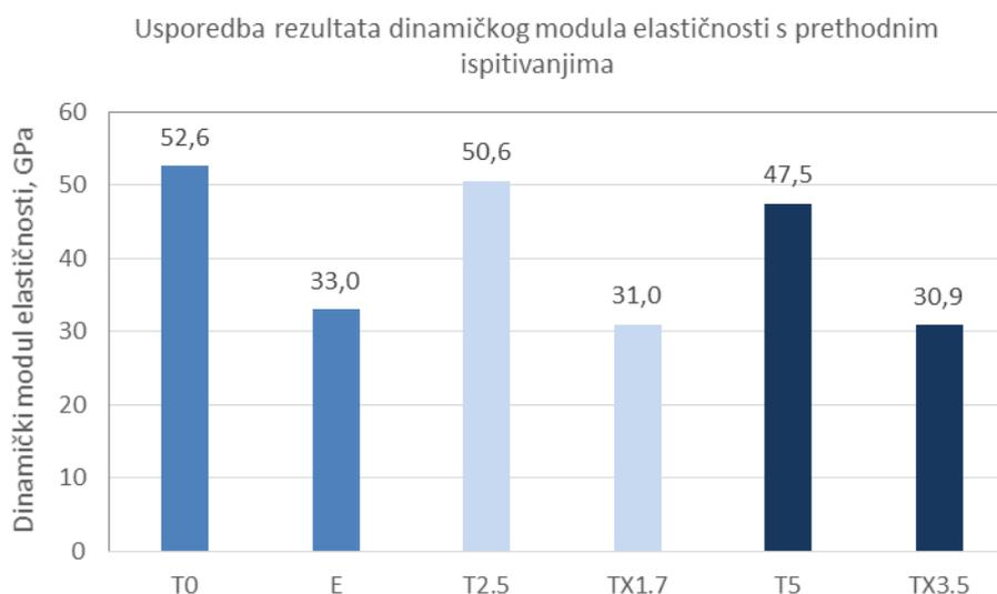
Slika 5.22: Usporedba dinamičkog modula elastičnosti s prethodnim istraživanjem
