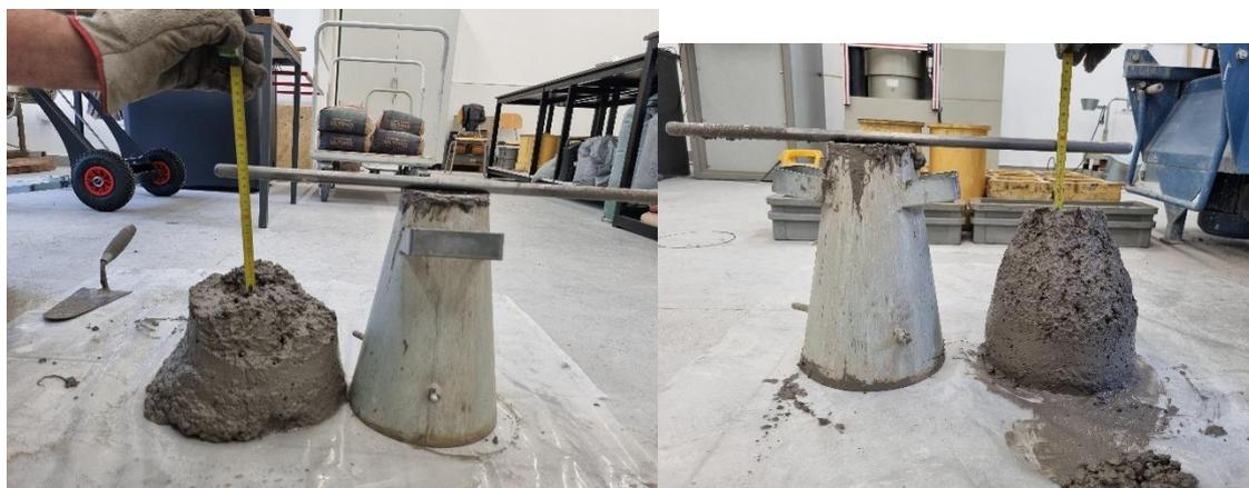
Slika 5.2: Mjerenje slijeganja za mješavine TX1.7 i TX3.5
