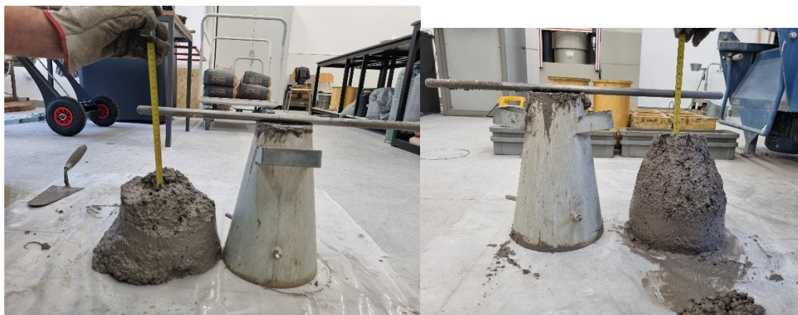
Slika 5.2: Mjerenje slijeganja za mješavine TX1.7 i TX3.5
