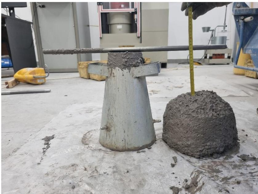
*Slika 5.4: Mjerenje slijeganja za mješavinu M1.0*
