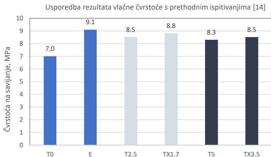
Slika 5.13: Usporedba rezultata vlačne čvrstoće s prethodnim istraživanjem
