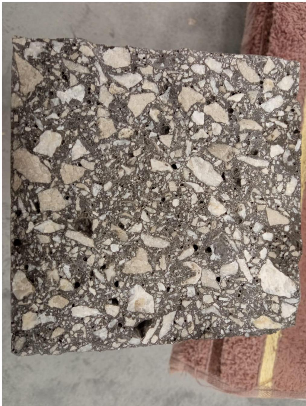
*Slika 5.14: Lom etalona nastao savijanjem*
