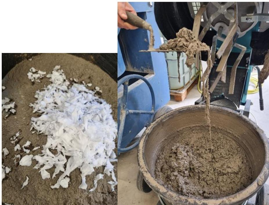
Slika 4.4: Izrada betonskih mješavina
