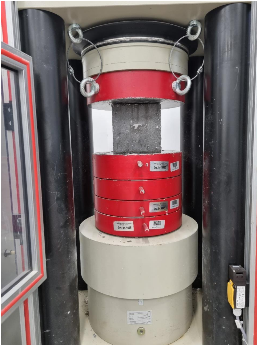
Slika 4.11: Ispitivanje tlačne čvrstoće
