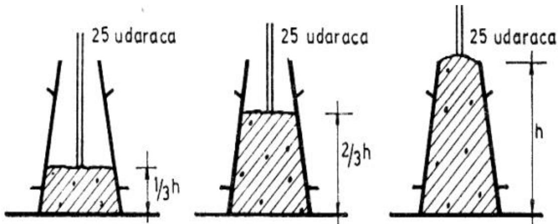
Slika 4.8: Standardni postupak zbijanja betona u Abramsov kalup [4]
