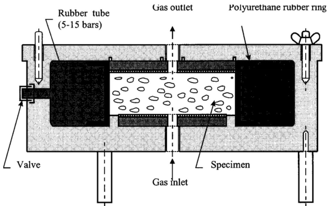
Slika 4.15: Komora u koju se postavlja betonski disk [15]
