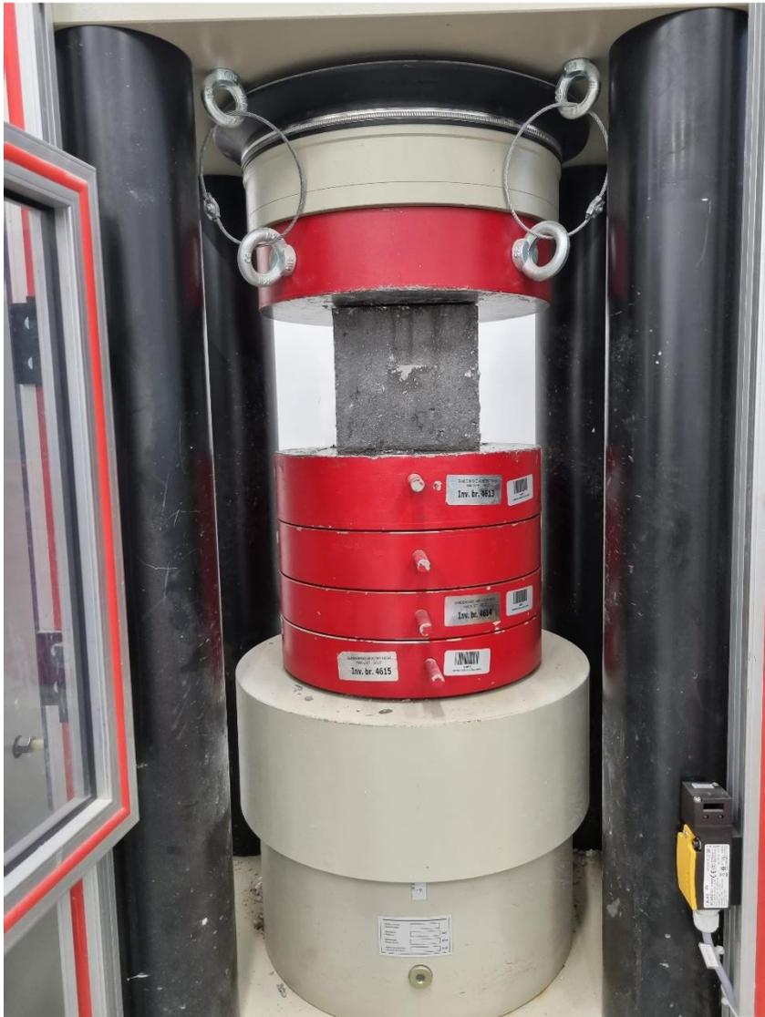
Slika 4.11: Ispitivanje tlačne čvrstoće
