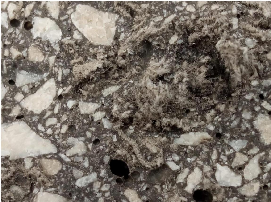
*Slika 5.17: Detalj loma uzorka TX3.5 nastao savijanjem*
