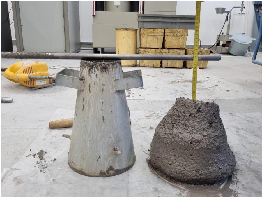
*Slika 5.3: Mjerenje slijeganja za mješavinu PP*
