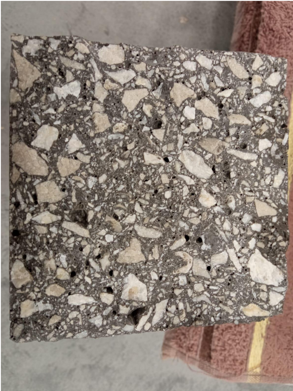
Slika 5.14: Lom etalona nastao savijanjem
