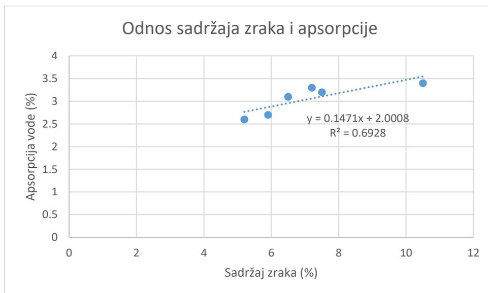
Slika 5.28: Prikaz odnosa sadržaja zraka u betonu i apsorpcije
