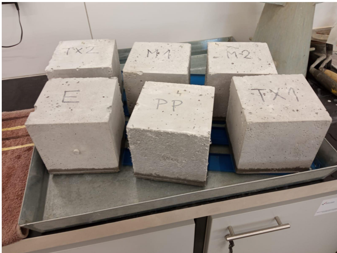
Slika 4.13: Ispitivanje kapilarnog upijanja
