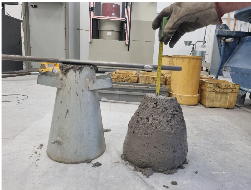
Slika 5.5: Mjerenje slijeganja za mješavinu M0.75
