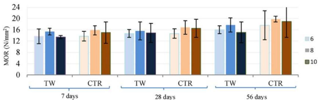
Slika 3.3: Prikaz rezultata čvrstoće na vlak savijanjem za uzorke različite starosti [12]
