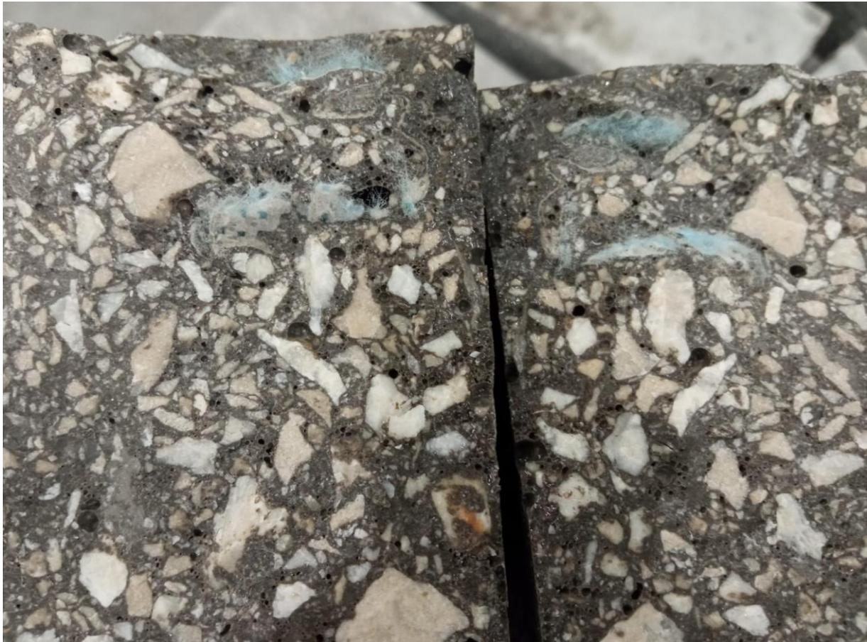
*Slika 5.19: Detalj loma uzorka M1.0 nastalog savijanjem*
