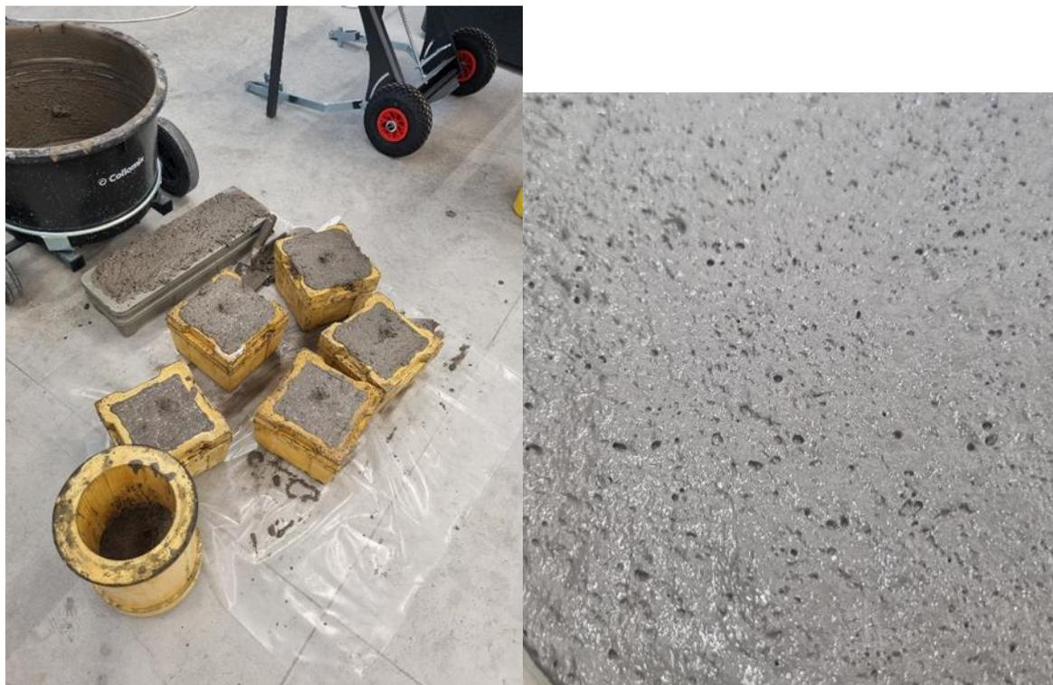
*Slika 4.7: Lijevo-izrada ispitnih tijela, desno-detalj pjenjenja betona M1.0*
