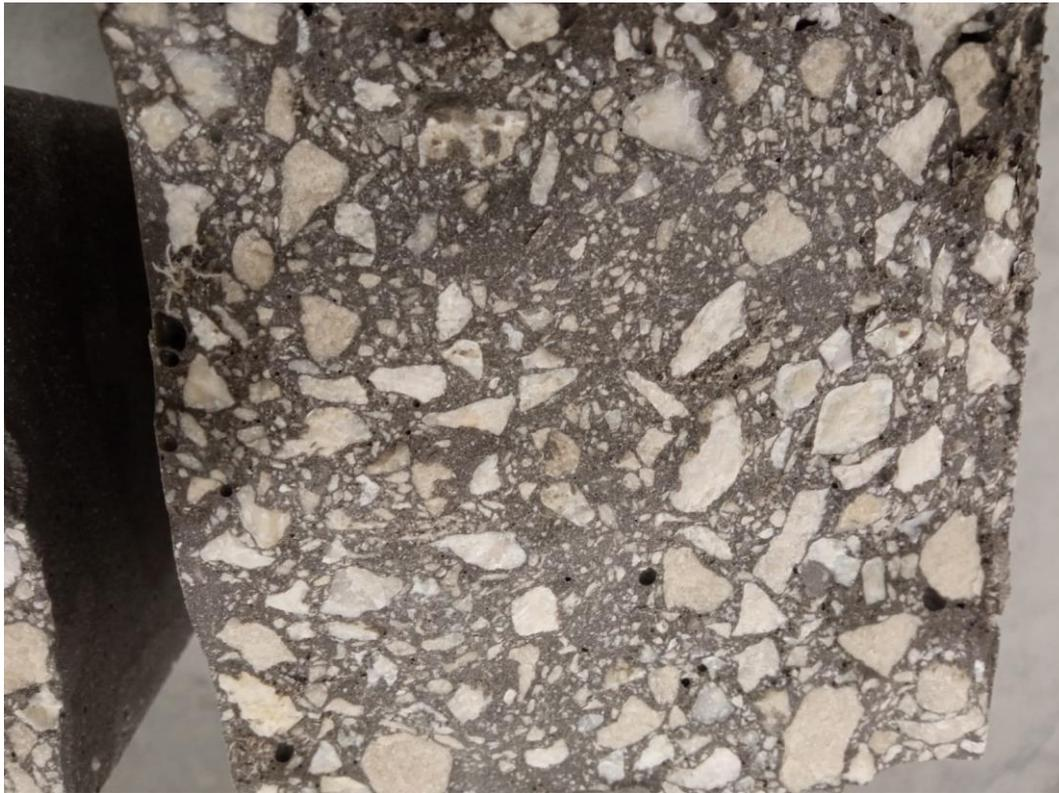
*Slika 5.16: Lom uzorka TX1.7 nastao savijanjem*
