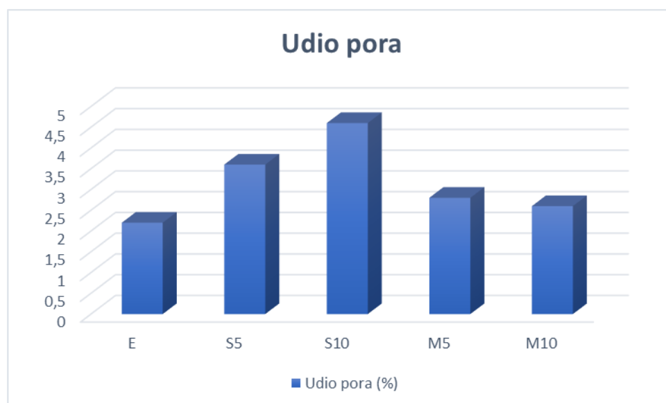
Slika 4.7. Udio pora u svježem betonu
