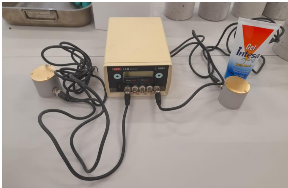
Slika 3.5. Uređaj za ispitivanje brzine ultrazvučnih valova
