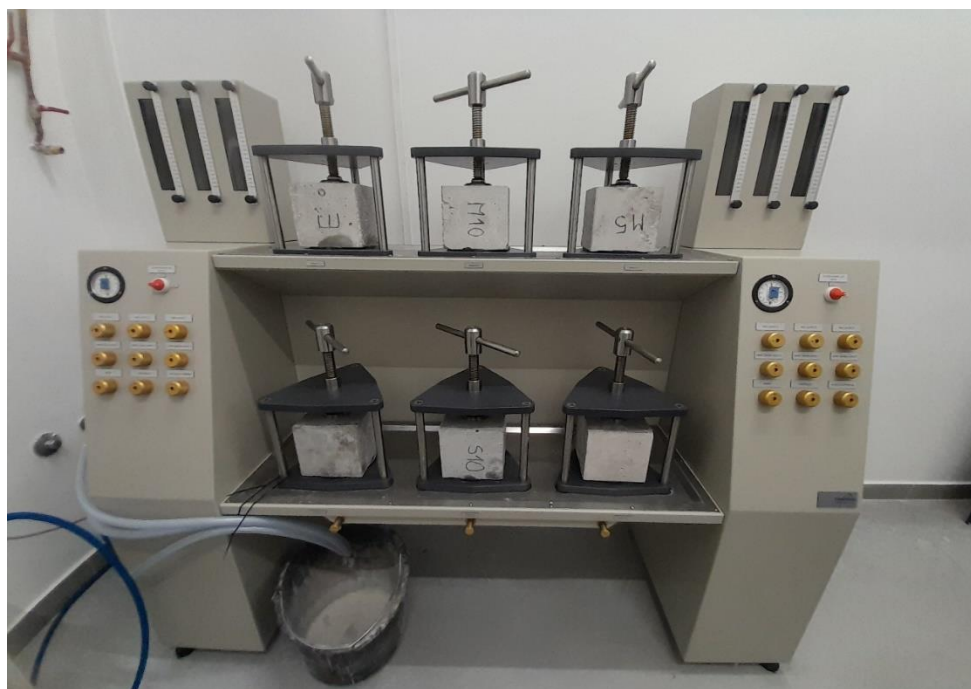
Slika 3.6. Uređaj za ispitivanje vodonepropusnosti
