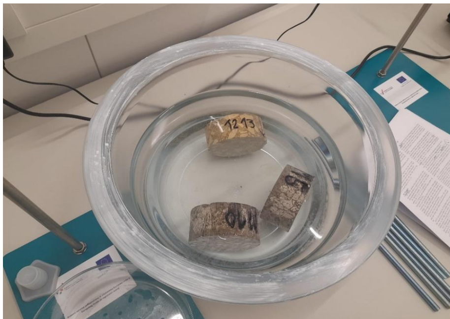
Slika 3.12. Vakimirani ispitni uzorci
