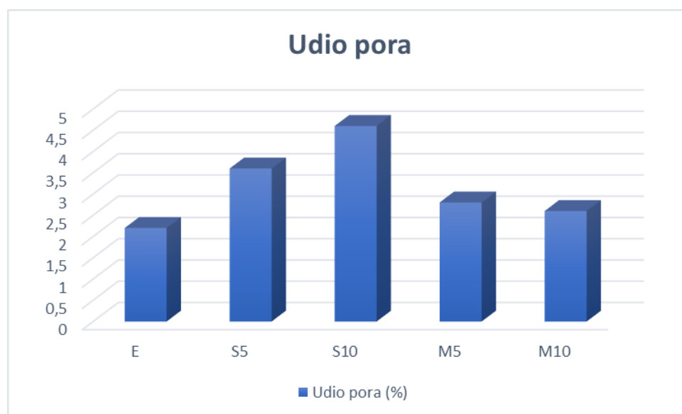
Slika 4.7. Udio pora u svježem betonu
