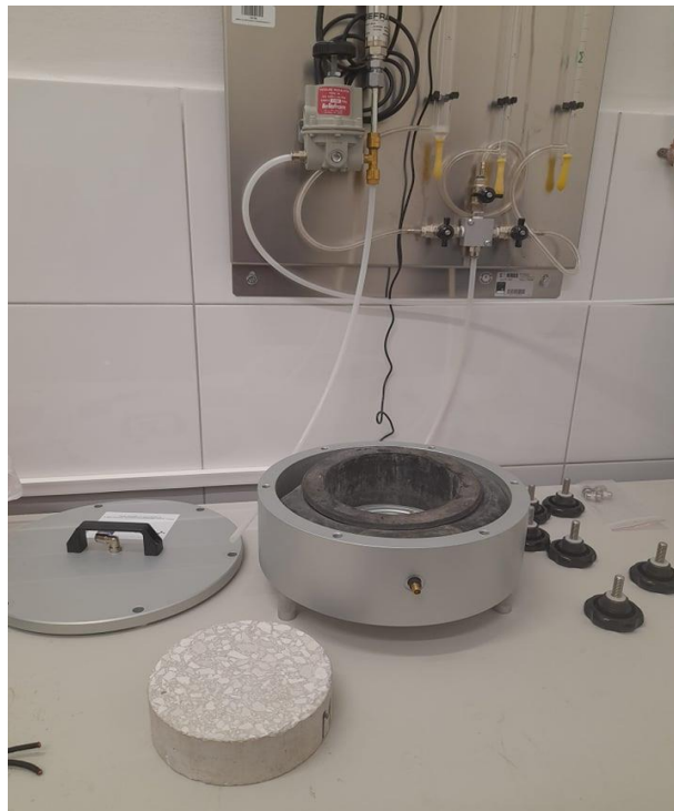
Slika 3.9. Uređaj i ispitni uzorak za ispitivanje plinopropusnosti
