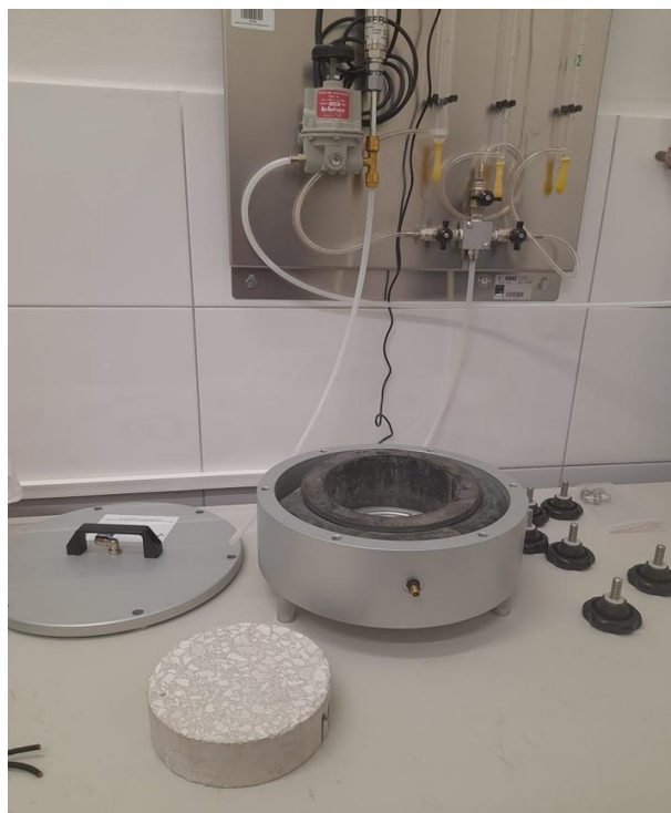
Slika 3.9. Uređaj i ispitni uzorak za ispitivanje plinopropusnosti
