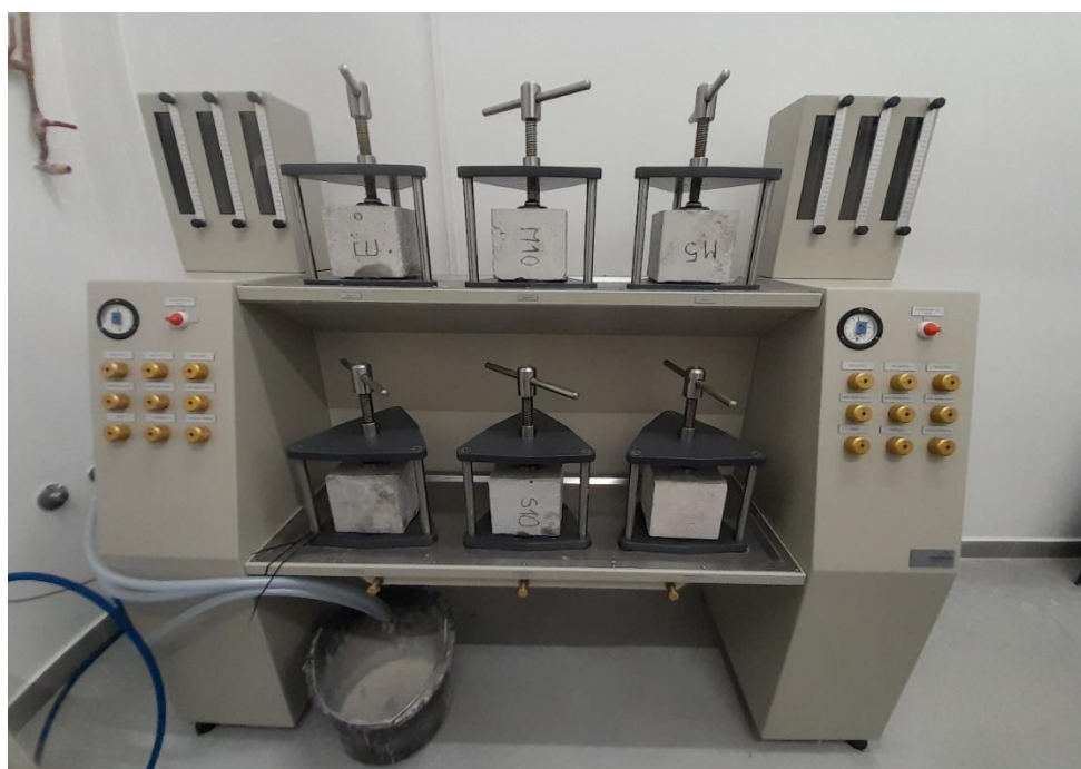
Slika 3.6. Uređaj za ispitivanje vodonepropusnosti
