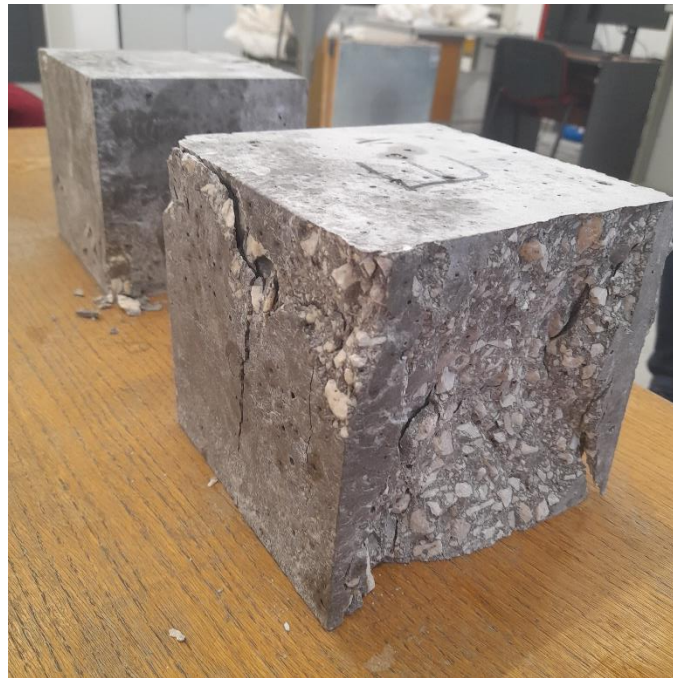
Slika 4.8. Ispitni uzorak E nakon ispitivanja tlačne čvrstoće
