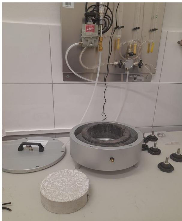
Slika 3.9. Uređaj i ispitni uzorak za ispitivanje plinopropusnosti
