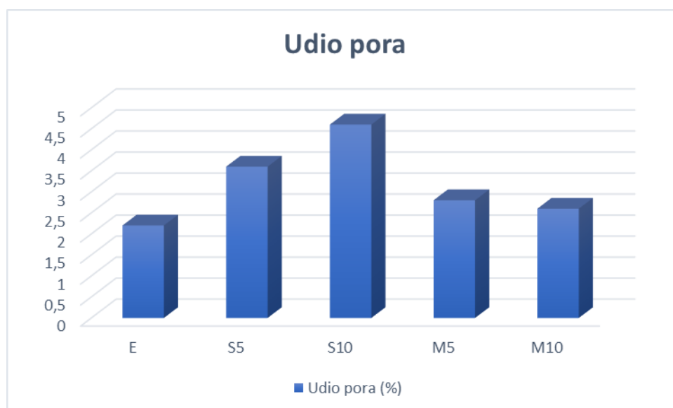
Slika 4.7. Udio pora u svježem betonu
