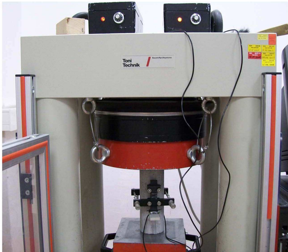
Fotografija 5.9. Uzorak s postavljenim ekstenzometrima za mjerenje relativnog pomaka
