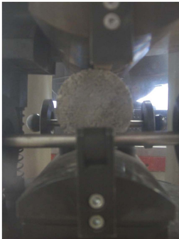
Fotografija 5.8. Prikaz uzorka za ispitivanje vlačne čvrstoće
