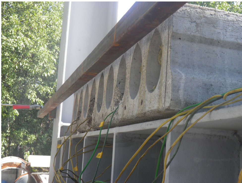
Fotografija 6.5. Prikaz termoparova za mjerenje temperature
