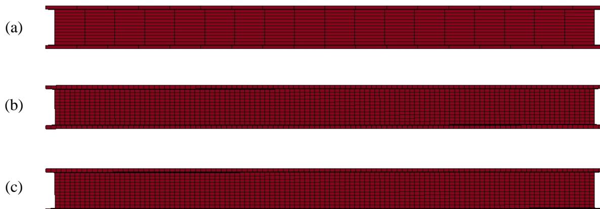
Crtež 7.6. Diskretizacija modela za proračun provođenja topline za 1., 2., 4. i 5. primjer – mreža (a), (b) i (c)
