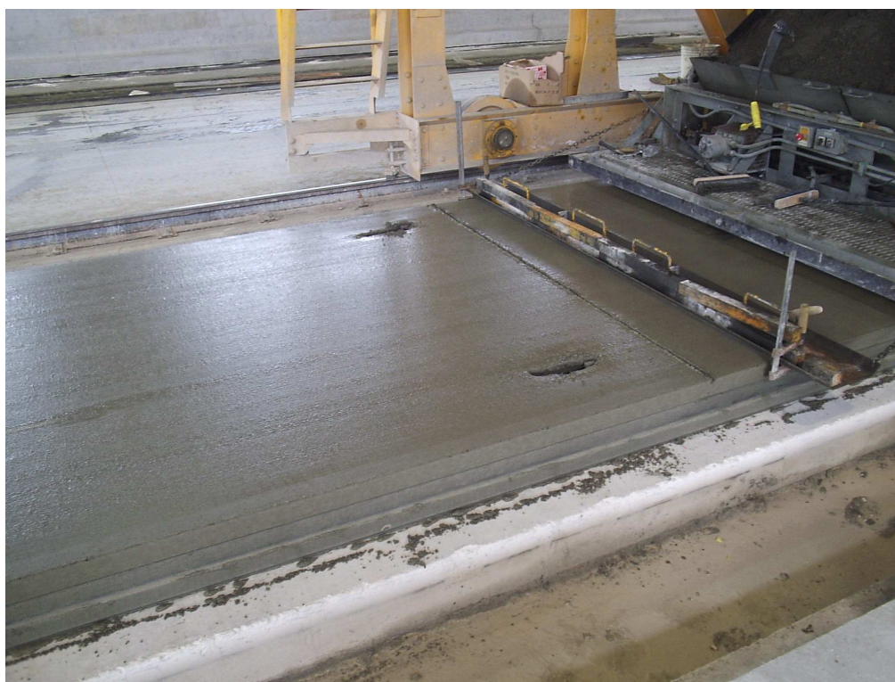
Fotografija 6.1. Prikaz procesa proizvodnje prednapetih šupljih ploča
