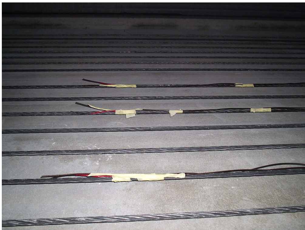
Fotografija 6.2. Termoparovi pričvršćeni za prednapete natege
