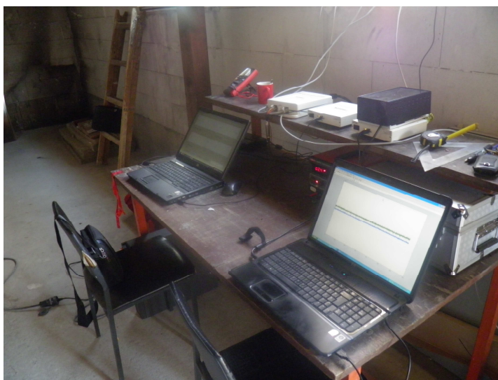
Fotografija 6.9. Prikaz uređaja za akviziciju podataka mehaničkog odgovora ploče
