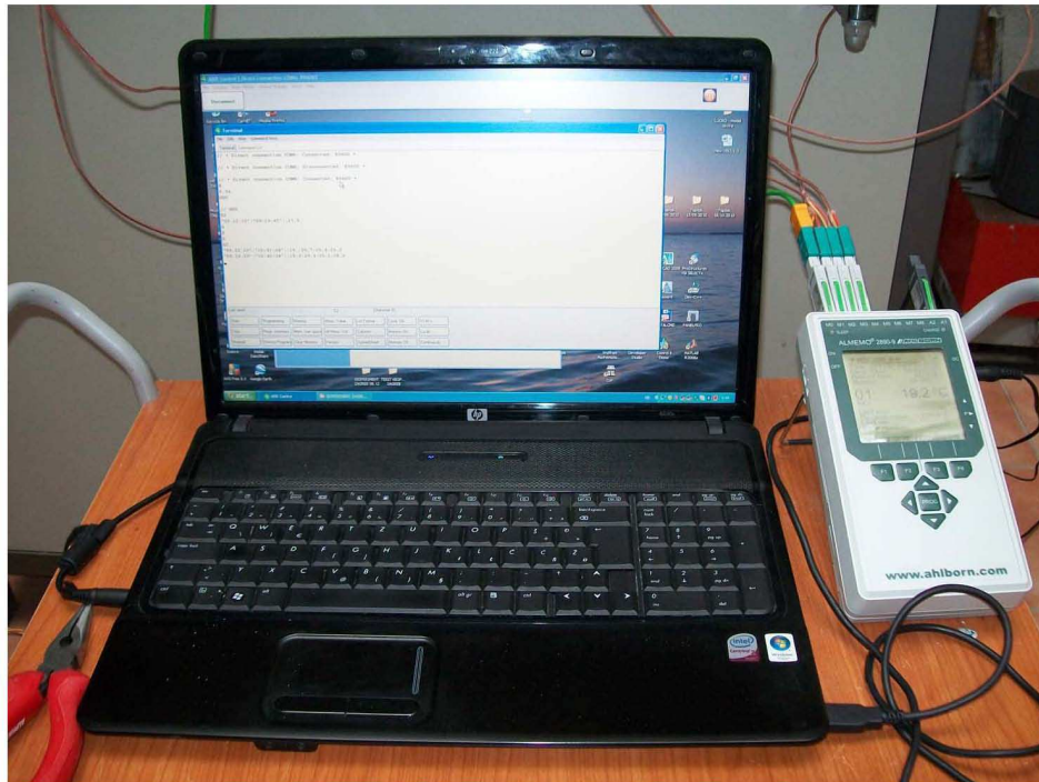
Fotografija 5.5. Prikaz uređaja za akviziciju podataka
