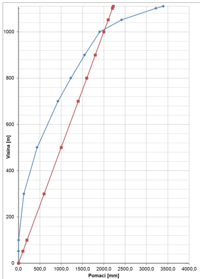
Slika 7.1.2.6 Pomaci konstrukcije u horizontalnom smjeru, opterećenje vjetrom
