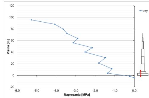
Slika 8.1.3.16 Posmična naprezanja u presjeku  $x=61\text{m}$  – opterećenje vjetrom
