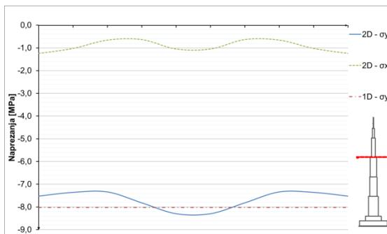
**Slika 8.1.3.10** Naprezanja u betonu u presjeku  $h=700$  m
