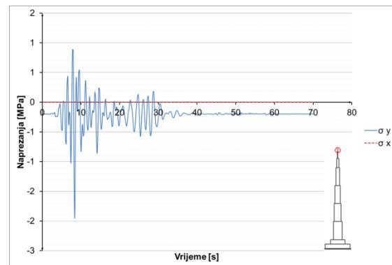
**Slika 8.3.7.31** Naprezanja u čeliku u presjeku  $h=1100$  m
