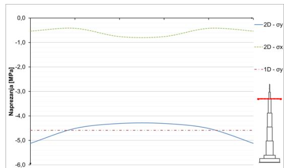
**Slika 8.1.3.11** Naprezanja u betonu u presjeku  $h=900$  m
