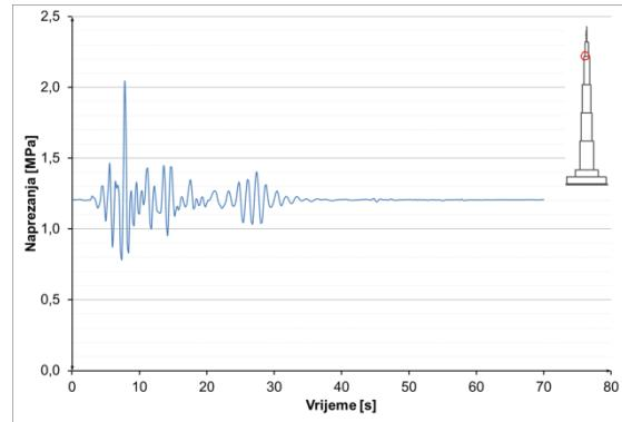
**Slika 8.3.7.41** Naprezanja u armaturi u u presjeku
