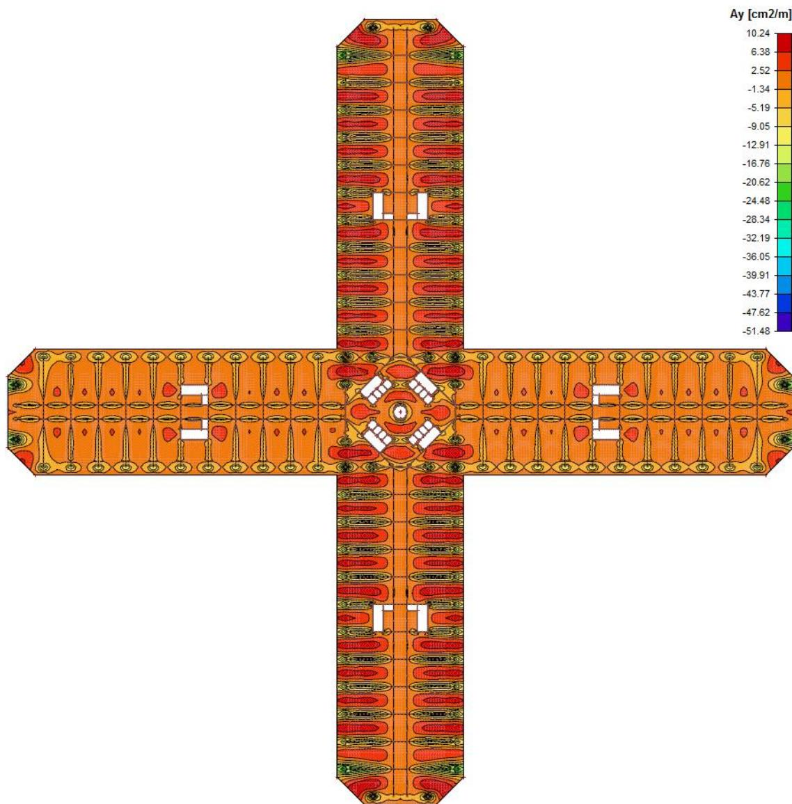
Slika 6.1.4.2 Potrebna površina armature [Ay] – cm<sup>2</sup>/m
