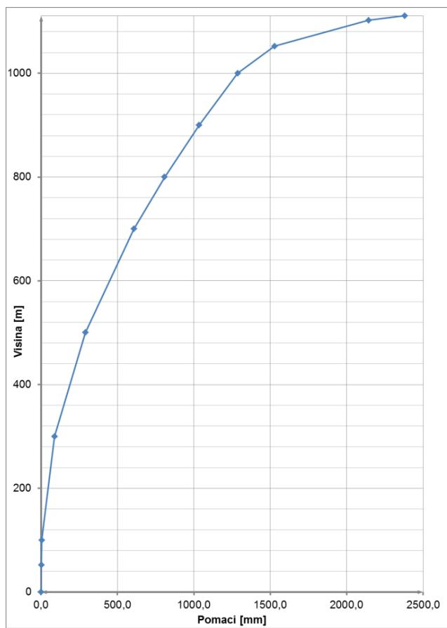
Slika 7.3.2.5 Pomaci konstrukcije u horizontalnom smjeru, opterećenje potresom
