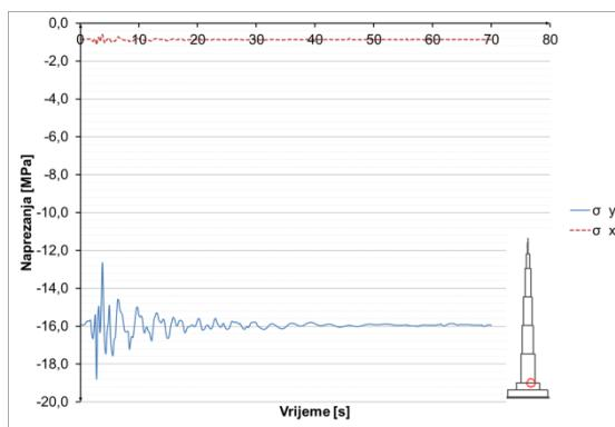
**Slika 8.3.9.18** Naprezanja u betonu u presjeku  $h=100$  m
