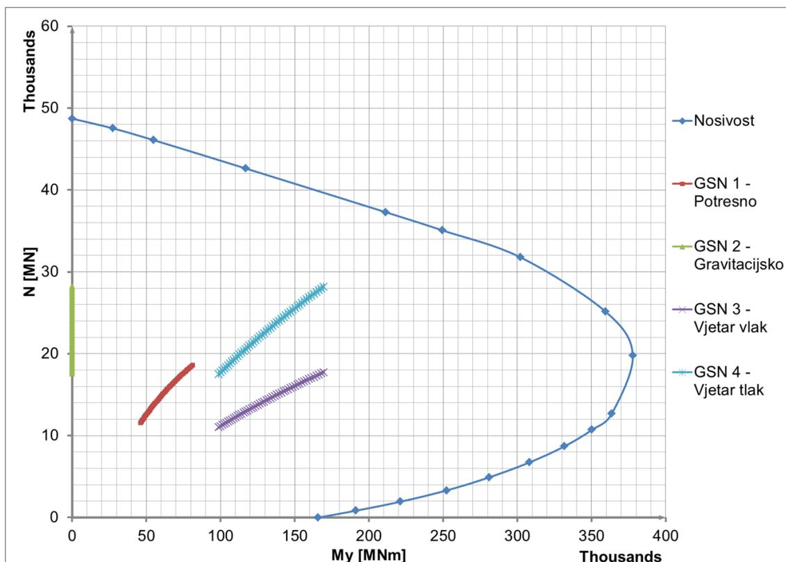
Slika 7.4.3.3 Dijagram nosivosti za presjek 100-300 m
