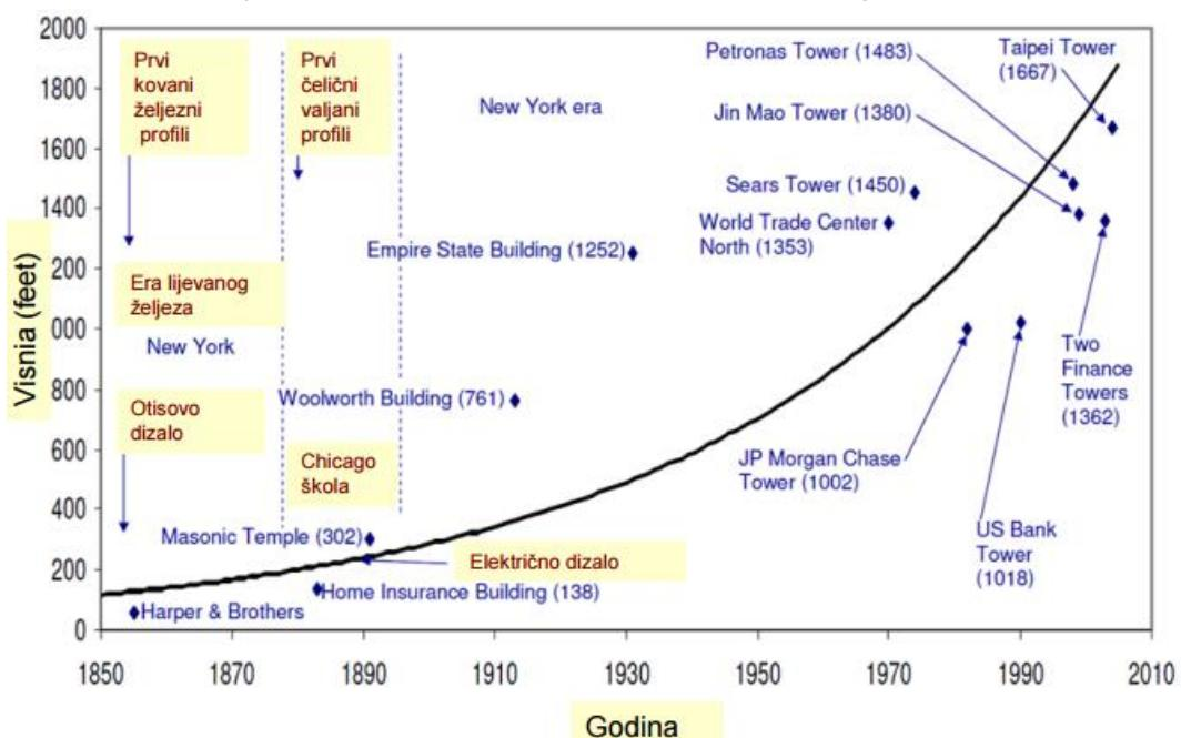
Slika 1.2.1.13 Rast visokih građevina od 1850. do 2005.
