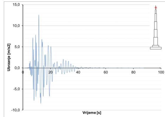
**Slika 8.3.4.52** Ubrzanja u presjeku  $h=1052$  m – potres Kobe
