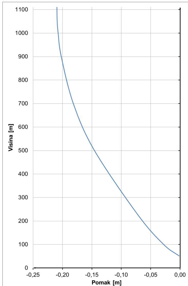
**Slika 8.1.3.2** Vertikalni pomak po visini konstrukcije
