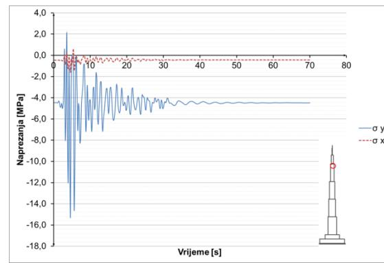
**Slika 8.3.9.23** Naprezanja u betonu u presjeku  $h=900$  m
