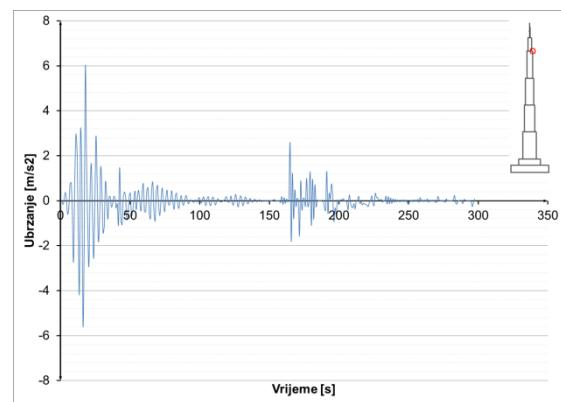
**Slika 8.3.2.50** Ubrzanja u presjeku h=900 m – potres Izmit
