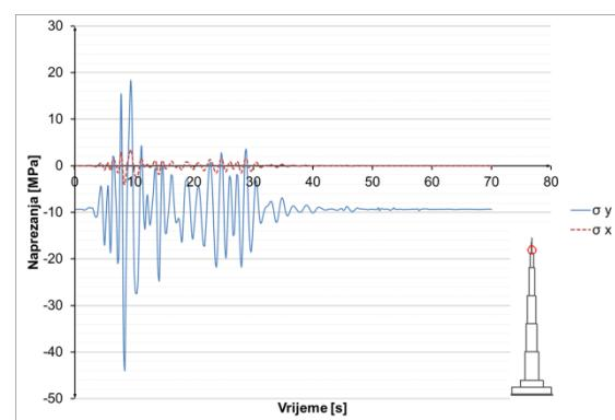
**Slika 8.3.7.27** Naprezanja u čeliku u presjeku  $h=1030$  m
