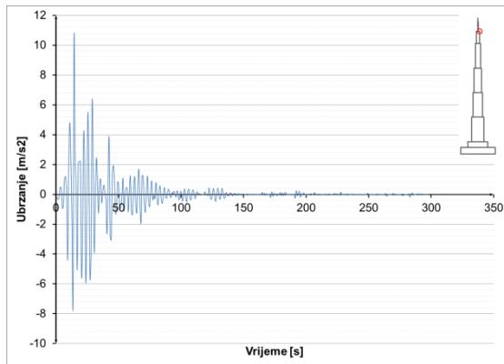
**Slika 8.3.2.51** Ubrzanja u presjeku h=1000 m – potres Izmit
