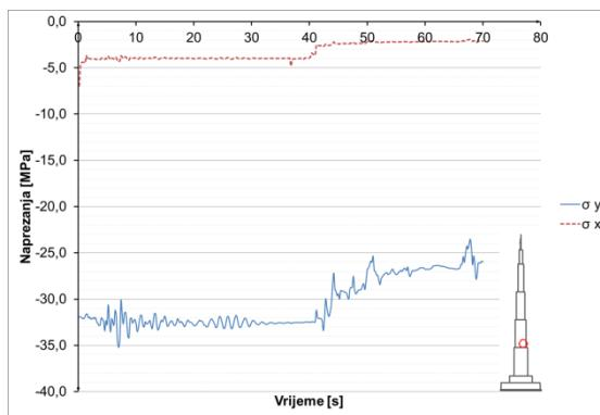
**Slika 8.3.7.20** Naprezanja u betonu u presjeku  $h=305$  m
