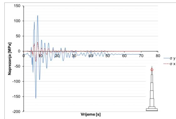
**Slika 8.3.5.26** Naprezanja u čeliku u presjeku  $h=1005$  m
