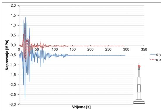
**Slika 8.3.2.25** Naprezanja u betonu u presjeku  $h=100$  m
