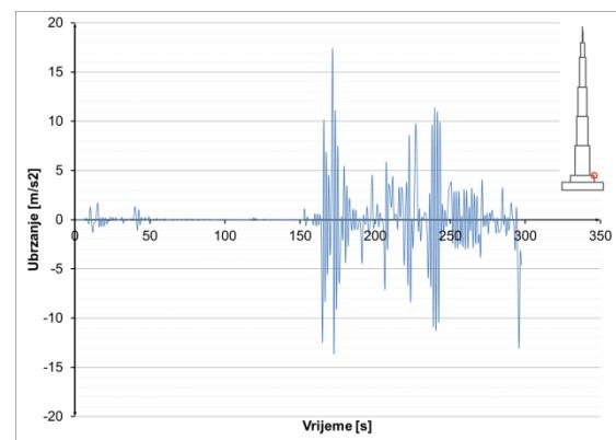
Slika 8.3.2.46 Ubrzanja u presjeku  $h=100$  m – potres Izmit
