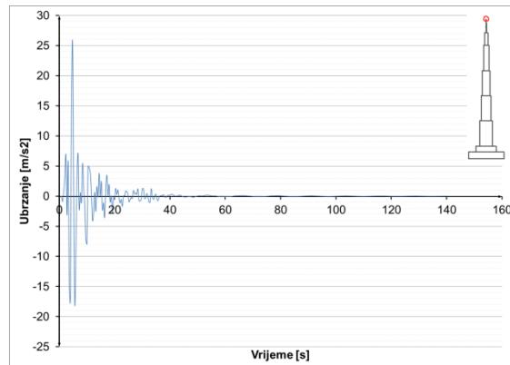
**Slika 8.3.3.53** Ubrzanja u presjeku  $h=1111$  m – potres Banja Luka
