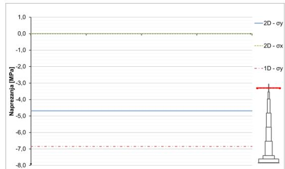
**Slika 8.1.3.13** Naprezanja u čeliku presjek  $h=1052$  m m
