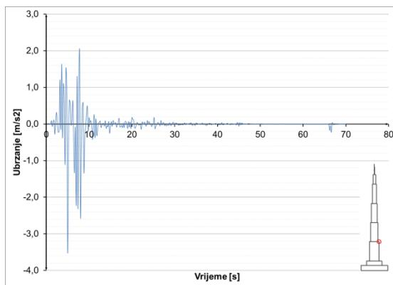
Slika 8.3.5.47 Ubrzanja u presjeku  $h=300$  m – potres Bingöl
