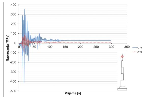
**Slika 8.3.2.26** Naprezanja u čeliku u presjeku  $h=1005$  m
