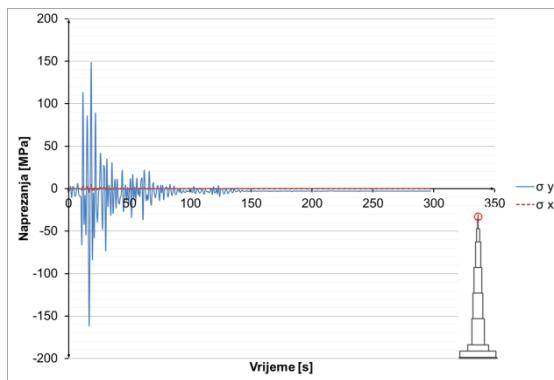
Slika 8.3.2.31 Naprezanja u čeliku u presjeku  $h=1075$  m
