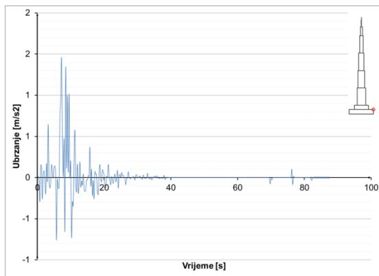
Slika 8.3.4.45 Ubrzanja u presjeku  $h=52$  m – potres Kobe
