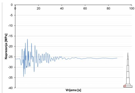
**Slika 8.3.4.33** Naprezanja u armaturi u presjeku  $h=52$  m
