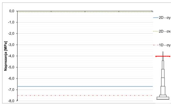
**Slika 8.1.2.11** Naprezanja u čeliku u presjeku  $h=1005\text{ m}$
