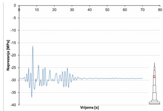
**Slika 8.3.7.39** Naprezanja u armaturi u u presjeku
