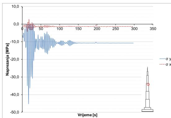
**Slika 8.3.2.23** Naprezanja u betonu u presjeku  $h=700$  m
