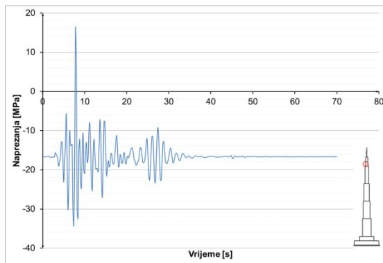
**Slika 8.3.7.42** Naprezanja u armaturi u presjeku
