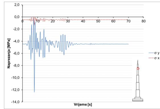
**Slika 8.3.7.23** Naprezanja u betonu u presjeku  $h=900$  m
