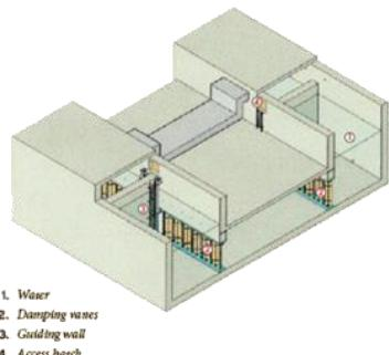
Slika 2.7.2.4 Prigušivač s uskladenim gibanjem tekućine (TLCD)
