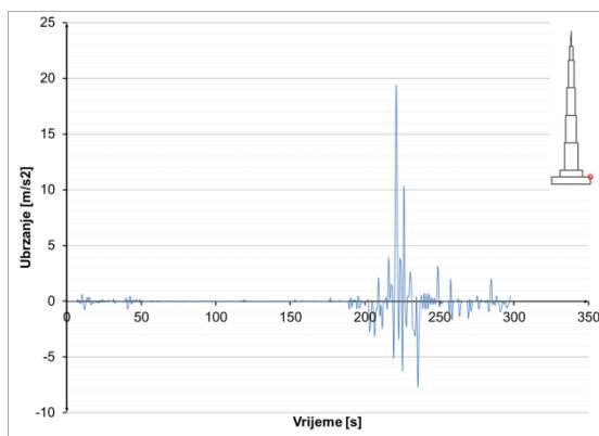
Slika 8.3.2.45 Ubrzanja u presjeku  $h=52$  m – potres Izmit
