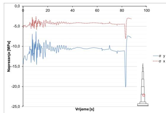
**Slika 8.3.4.20** Naprezanja u betonu u presjeku  $h=295$  m
