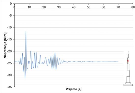
**Slika 8.3.7.40** Naprezanja u armaturi u u presjeku
