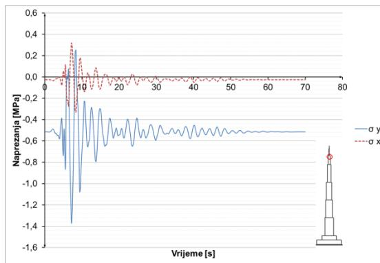
**Slika 8.3.5.25** Naprezanja u betonu u presjeku  $h=100$  m
