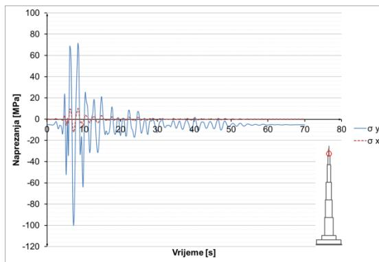
**Slika 8.3.5.29** Naprezanja u čeliku u presjeku  $h=1045$  m
