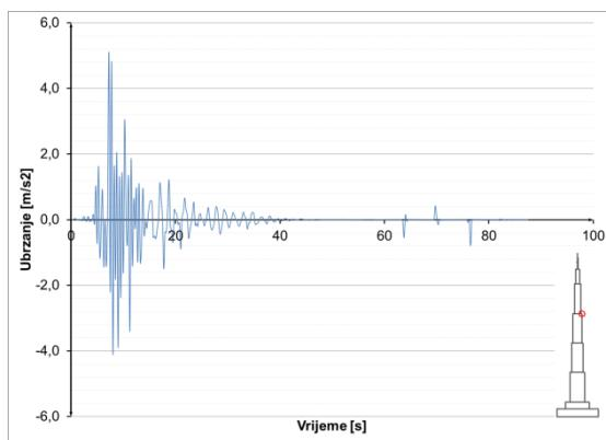
**Slika 8.3.4.49** Ubrzanja u presjeku  $h=700$  m – potres Kobe
