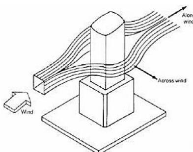
Slika 2.5.2.3 Pojednostavljeni dvodimenzionalni tok vjetra (Taranath, 1998)
