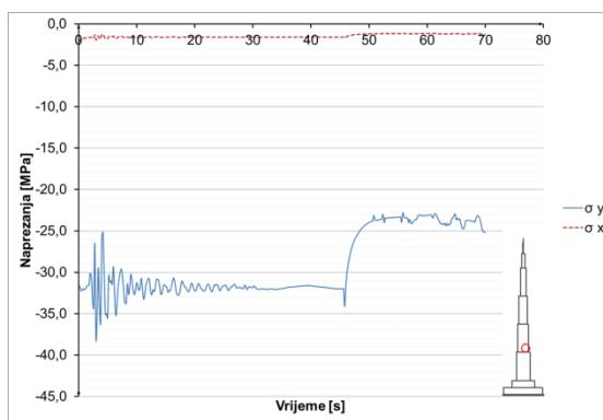
**Slika 8.3.9.20** Naprezanja u betonu u presjeku  $h=305$  m
