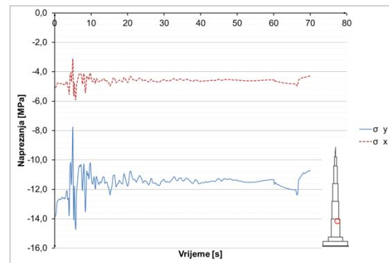
**Slika 8.3.5.20** Naprezanja u betonu u presjeku  $h=295$  m
