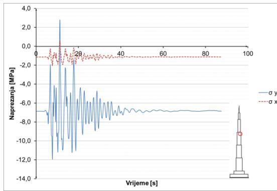
**Slika 8.3.4.23** Naprezanja u betonu u presjeku  $h=700$  m
