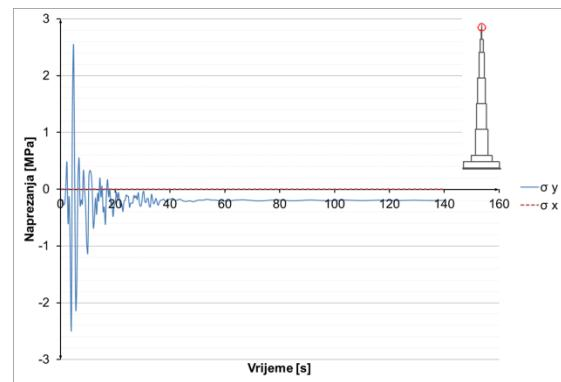
**Slika 8.3.3.32** Naprezanja u čeliku u presjeku  $h=1100$  m
