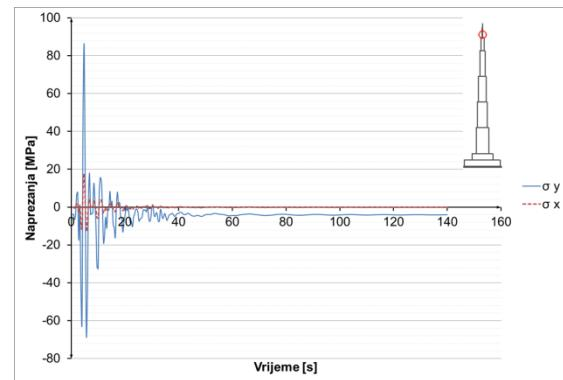
**Slika 8.3.3.30** Naprezanja u čeliku u presjeku  $h=1052$  m
