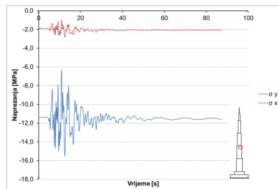
**Slika 8.3.4.22** Naprezanja u betonu u presjeku  $h=500$  m
