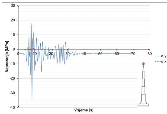
**Slika 8.3.7.30** Naprezanja u čeliku u presjeku  $h=1075$  m
