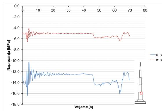
**Slika 8.3.9.19** Naprezanja u betonu u presjeku  $h=295$  m
