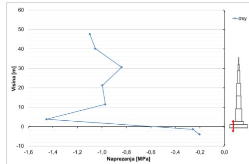
Slika 8.1.3.18 Posmična naprezanja u presjeku  $x=94\text{m}$  – opterećenje vjetrom
