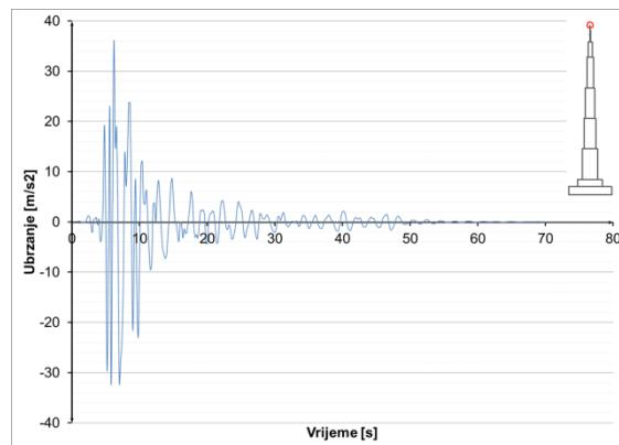
**Slika 8.3.5.53** Ubrzanja u presjeku  $h=1111$  m – potres Bingöl
