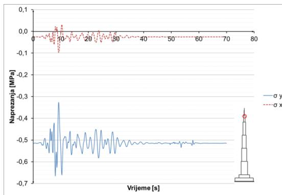
**Slika 8.3.7.24** Naprezanja u betonu u presjeku  $h=100$  m
