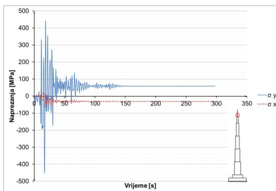
**Slika 8.3.2.27** Naprezanja u čeliku u presjeku  $h=1015$  m
