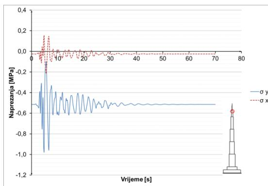
**Slika 8.3.9.24** Naprezanja u betonu u presjeku  $h=100$  m
