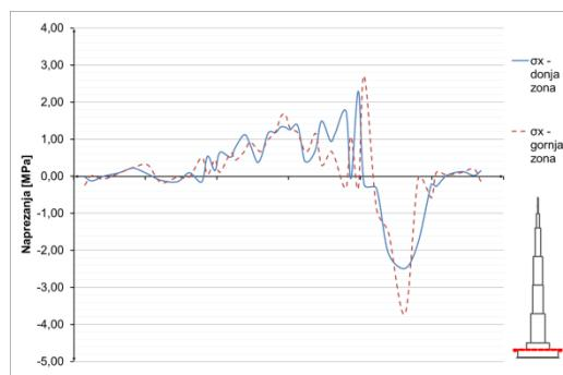
**Slika 8.1.3.21** Horizontalna naprezanja u ploči, h=52m – opterećenje vjetrom
