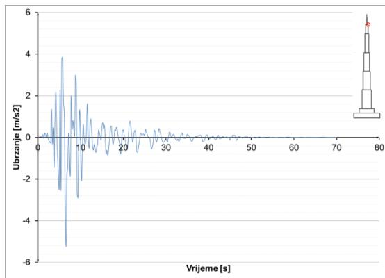
**Slika 8.3.5.51** Ubrzanja u presjeku  $h=1000$  m – potres
