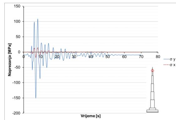
**Slika 8.3.5.28** Naprezanja u čeliku u presjeku  $h=1030$  m
