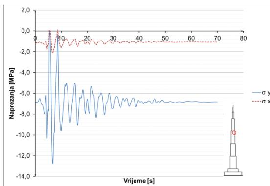
**Slika 8.3.5.23** Naprezanja u betonu u presjeku  $h=700$  m
