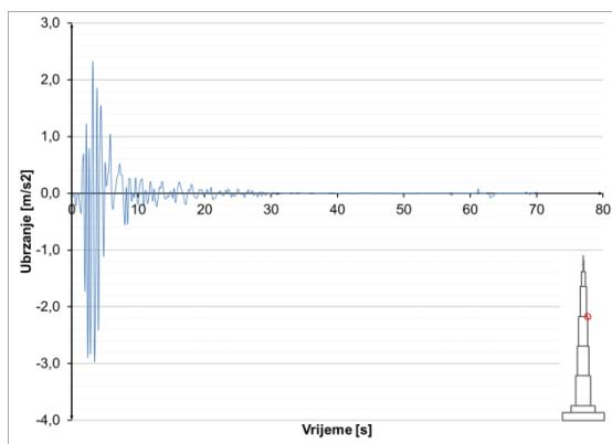
Slika 8.3.9.48 Ubrzanja u presjeku  $h=700$  m – potres
