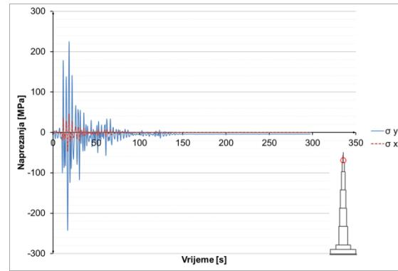
**Slika 8.3.2.30** Naprezanja u čeliku u presjeku  $h=1052$  m
