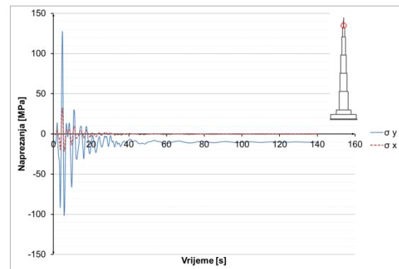
**Slika 8.3.3.26** Naprezanja u čeliku u presjeku  $h=1005$  m
