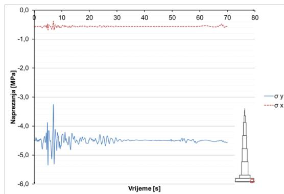
Slika 8.3.7.16 Naprezanja u betonu u presjeku  $h=0$  m – potres S. Monica
