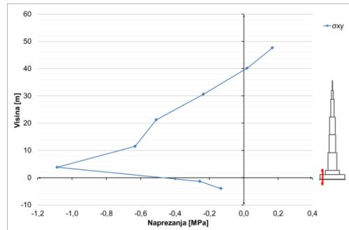
Slika 8.1.3.17 Posmična naprezanja u presjeku  $x=82\text{m}$  – opterećenje vjetrom
