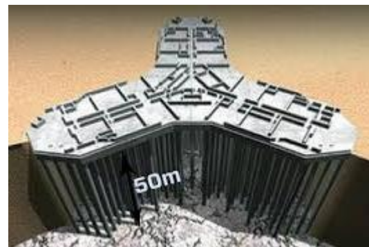
Slika 2.2.2.5 Temelji Burj Khalifa
