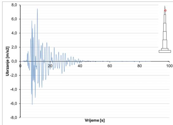
**Slika 8.3.4.51** Ubrzanja u presjeku  $h=1000$  m – potres Kobe
