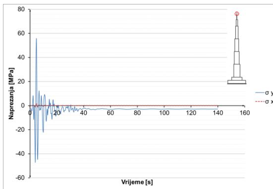
**Slika 8.3.3.31** Naprezanja u čeliku u presjeku  $h=1075$  m
