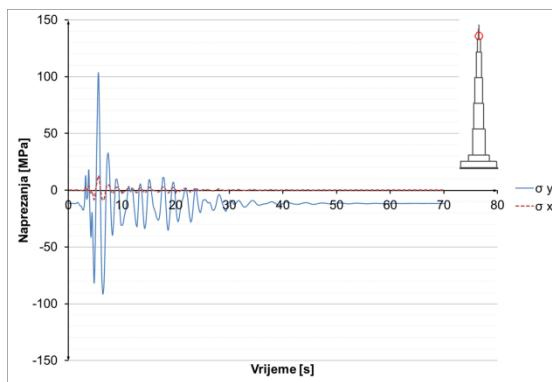
**Slika 8.3.9.26** Naprezanja u čeliku u presjeku  $h=1015$  m
