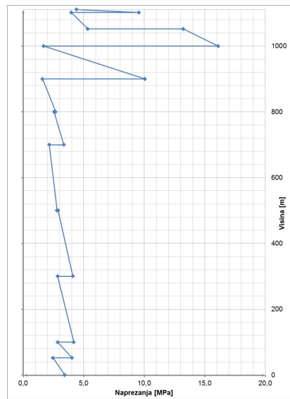
**Slika 7.4.3.2** Prikaz posmičnih naprezanja po visini konstrukcije, kombinacija GSN3
