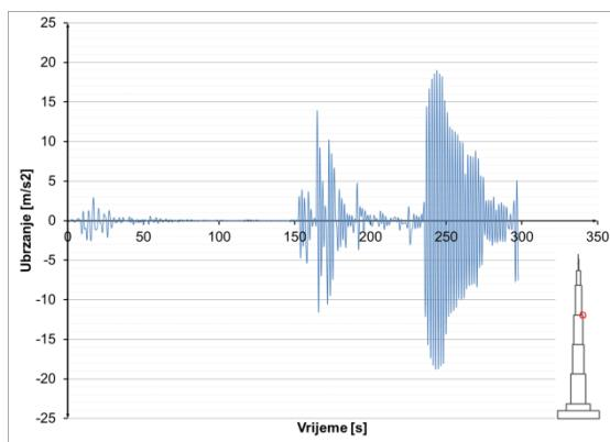
**Slika 8.3.2.49** Ubrzanja u presjeku h=700 m – potres Izmit
