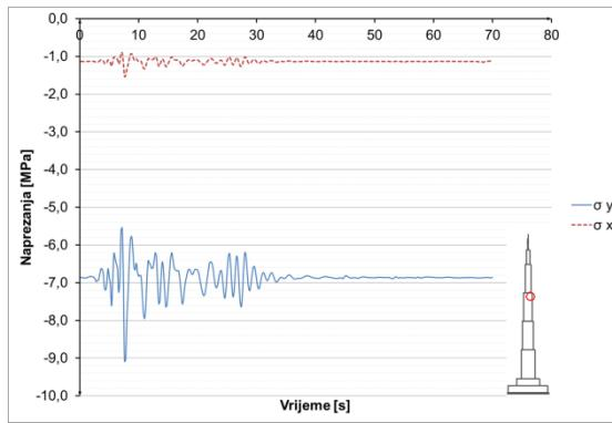
**Slika 8.3.7.22** Naprezanja u betonu u presjeku  $h=700$  m
