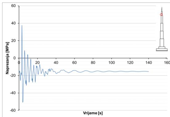
Slika 8.3.3.43 Naprezanja u armaturi u presjeku  $h=920$  m – potres Banja Luka
