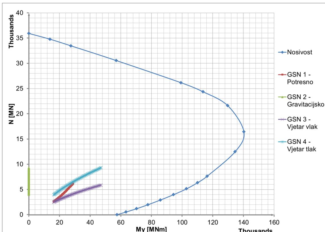
Slika 7.4.3.5 Dijagram nosivosti za presjek 500-700 m
