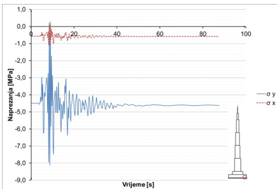
Slika 8.3.4.17 Naprezanja u betonu u presjeku  $h=0$  m –
