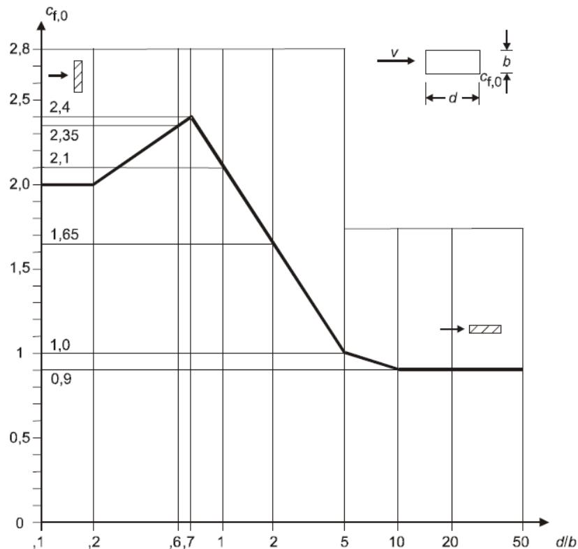
Slika 5.2.3.3 Prikaz koeficijenta sile  $c_{f,0}$  za pravokutni presjek
