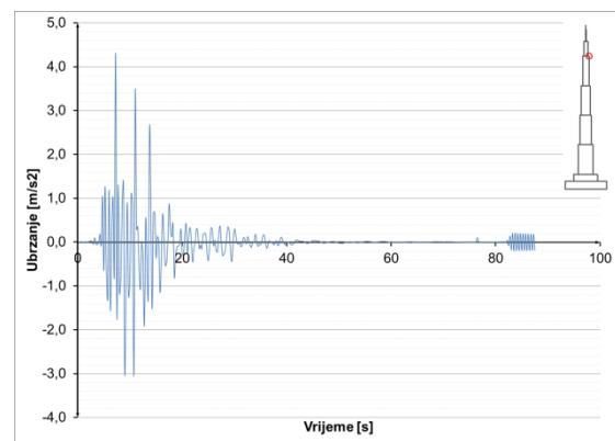
**Slika 8.3.4.50** Ubrzanja u presjeku  $h=900$  m – potres Kobe
