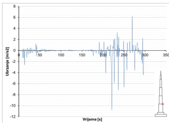
Slika 8.3.2.47 Ubrzanja u presjeku  $h=300$  m – potres Izmit
