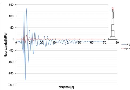
**Slika 8.3.5.27** Naprezanja u čeliku u presjeku  $h=1015$  m
