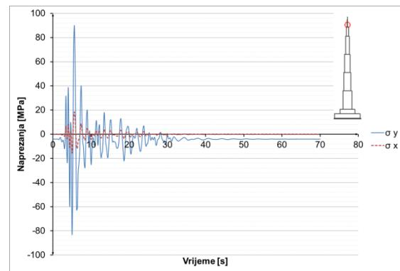
**Slika 8.3.9.29** Naprezanja u čeliku u presjeku  $h=1052$  m
