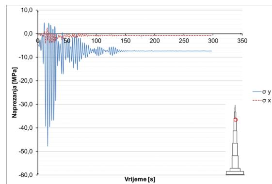
**Slika 8.3.2.24** Naprezanja u betonu u presjeku  $h=900$  m
