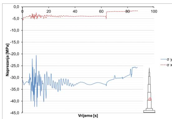
**Slika 8.3.4.21** Naprezanja u betonu u presjeku  $h=305$  m
