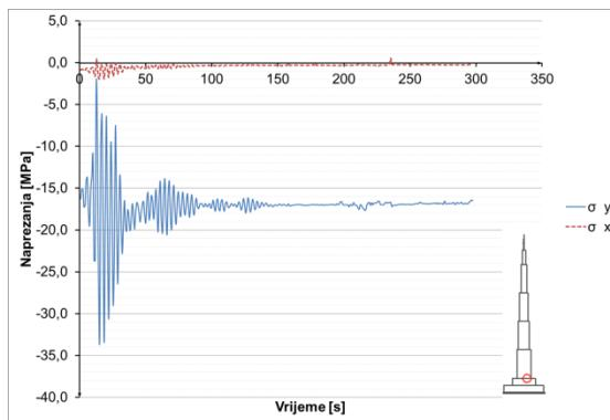
**Slika 8.3.2.19** Naprezanja u betonu u presjeku  $h=100$  m
