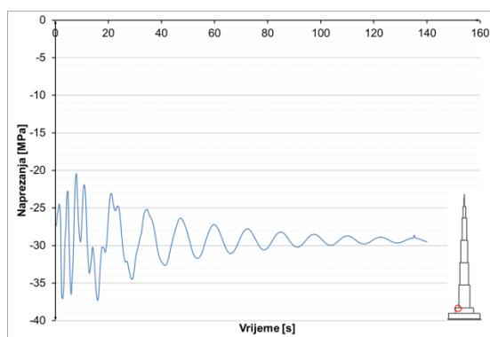
**Slika 8.3.3.35** Naprezanja u armaturi u presjeku  $h=300$  m – potres Banja Luka
