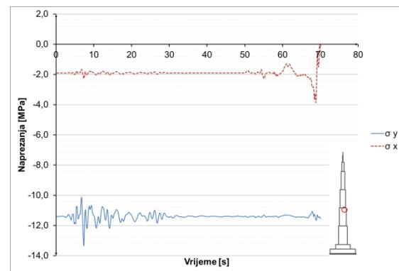
**Slika 8.3.7.21** Naprezanja u betonu u presjeku  $h=500$  m
