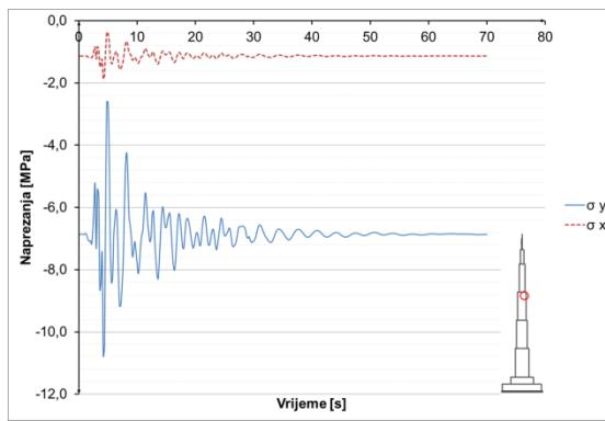
**Slika 8.3.9.22** Naprezanja u betonu u presjeku  $h=700$  m
