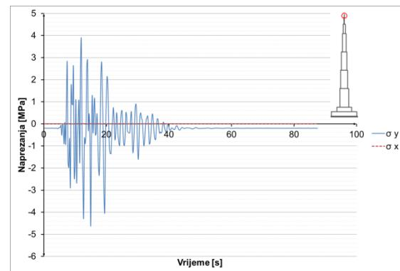
**Slika 8.3.4.32** Naprezanja u čeliku u presjeku  $h=1100$  m
