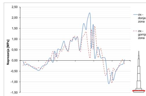
**Slika 8.1.3.20** Horizontalna naprezanja u ploči, h=36m – opterećenje vjetrom
