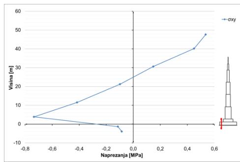
Slika 8.1.3.15 Posmična naprezanja u presjeku  $x=42\text{m}$  – opterećenje vjetrom
