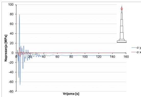
**Slika 8.3.3.29** Naprezanja u čeliku u presjeku  $h=1045$  m
