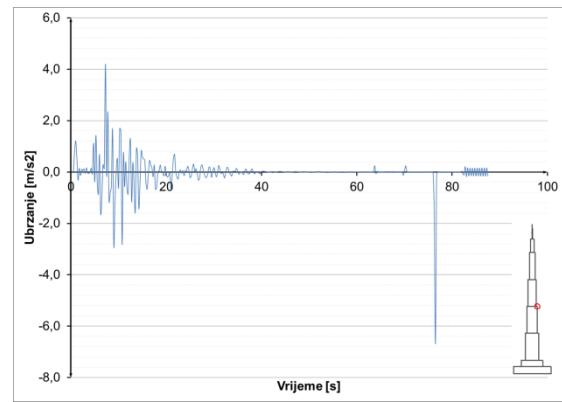
Slika 8.3.4.48 Ubrzanja u presjeku  $h=500$  m – potres Kobe
