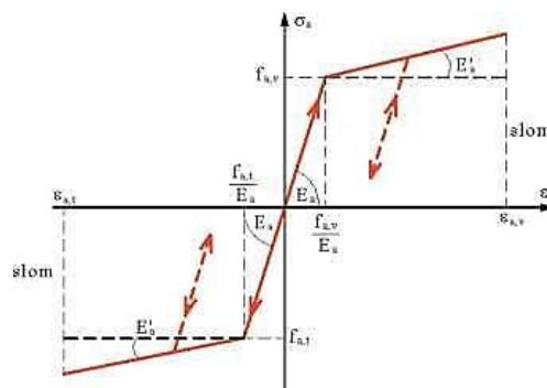
Slika 4.2.3.4 Veza naprezanje – deformacija za armaturu
