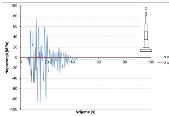
**Slika 8.3.4.31** Naprezanja u čeliku u presjeku  $h=1075$  m
