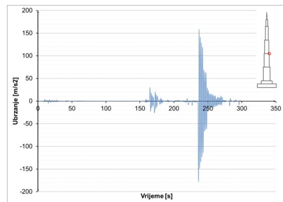
Slika 8.3.2.48 Ubrzanja u presjeku  $h=500$  m – potres Izmit
