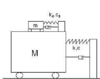
Slika 2.7.2.1 Shematski prikaz sustava prigušenja
