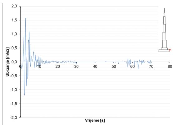
**Slika 8.3.9.44** Ubrzanja u presjeku  $h=52$  m – potres Ston
