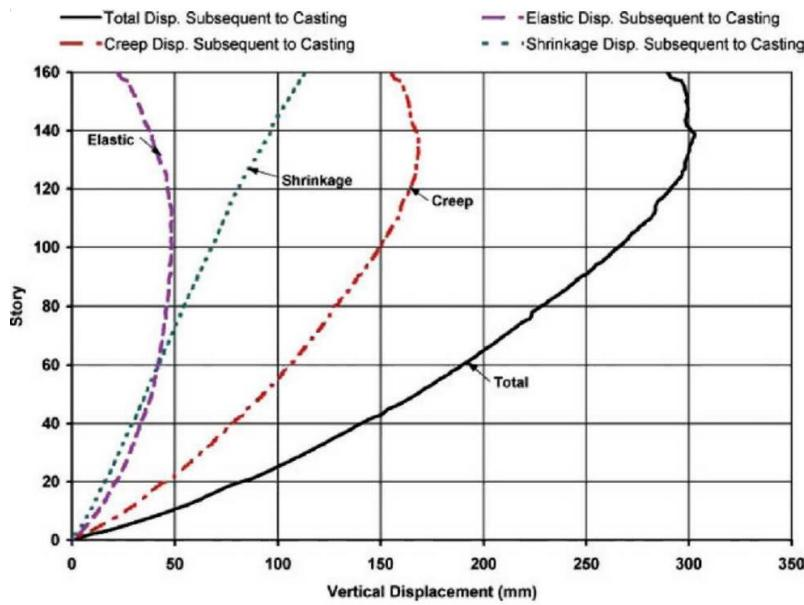
Slika 3.1.2.2 Predviđene vertikalne deformacije konstrukcije nakon 30 godina
