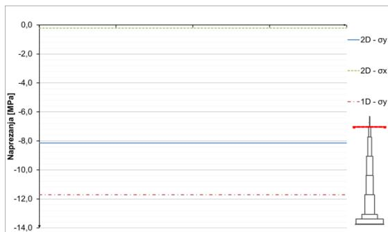
Slika 8.1.1.11 Naprezanja u čeliku u presjeku  $h=1005$  m
