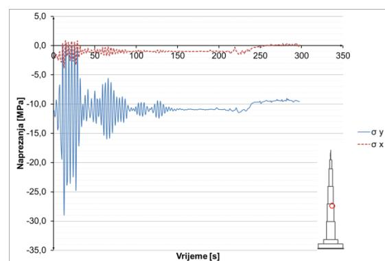
**Slika 8.3.2.22** Naprezanja u betonu u presjeku  $h=500$  m
