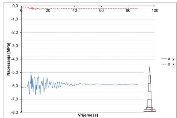
Slika 8.3.4.18 Naprezanja u betonu u presjeku  $h=52$  m –
