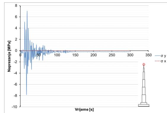
Slika 8.3.2.32 Naprezanja u čeliku u presjeku  $h=1100$  m
