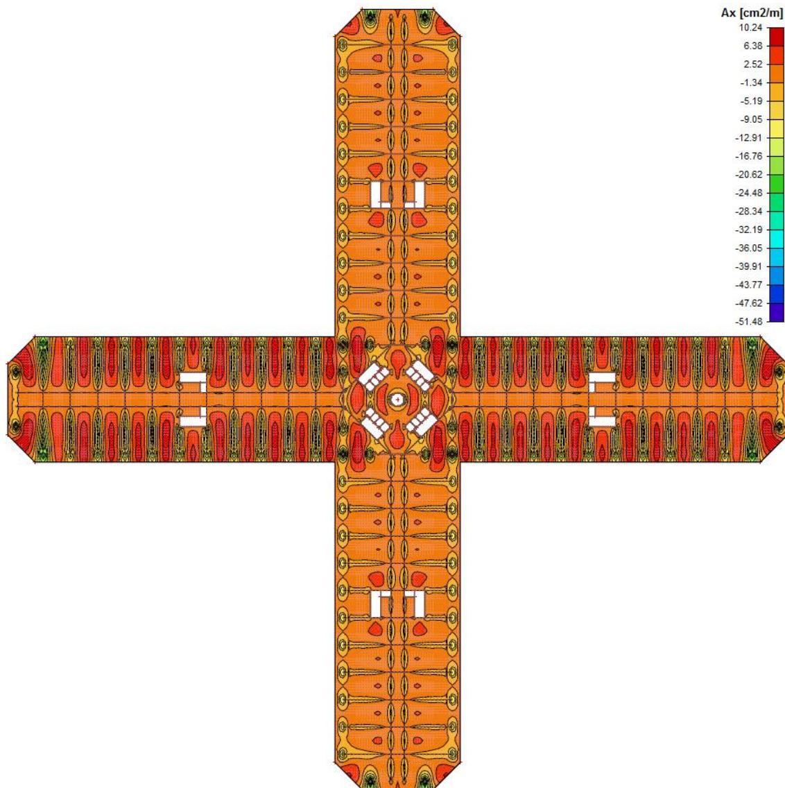
Slika 6.1.4.1 Potrebna površina armature [Ax] – cm<sup>2</sup>/m
