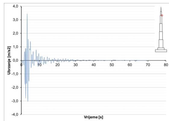
Slika 8.3.9.49 Ubrzanja u presjeku  $h=900$  m – potres
