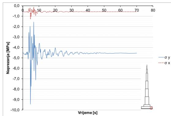
Slika 8.3.5.17 Naprezanja u betonu u presjeku  $h=0$  m –
