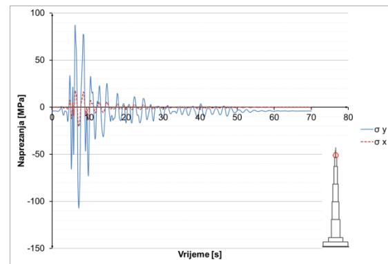
**Slika 8.3.5.30** Naprezanja u čeliku u presjeku  $h=1052$  m
