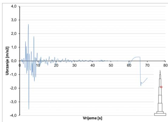
**Slika 8.3.5.49** Ubrzanja u presjeku  $h=700$  m – potres
