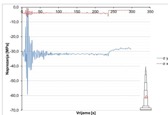
**Slika 8.3.2.21** Naprezanja u betonu u presjeku  $h=305$  m
