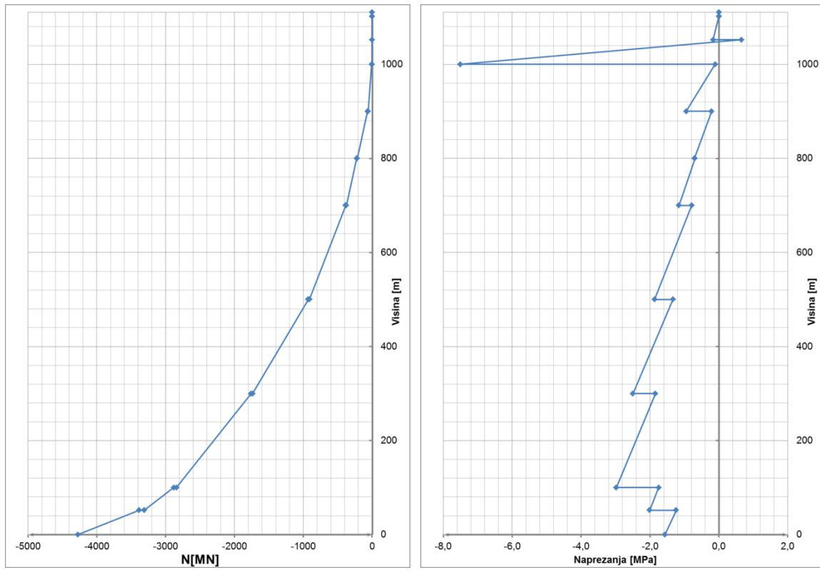
**Slika 7.1.2.1** Prikaz uzdužne sile po visini konstrukcije, pokretno opterećenje
