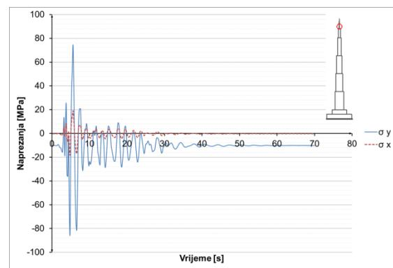
**Slika 8.3.9.25** Naprezanja u čeliku u presjeku  $h=1005$  m
