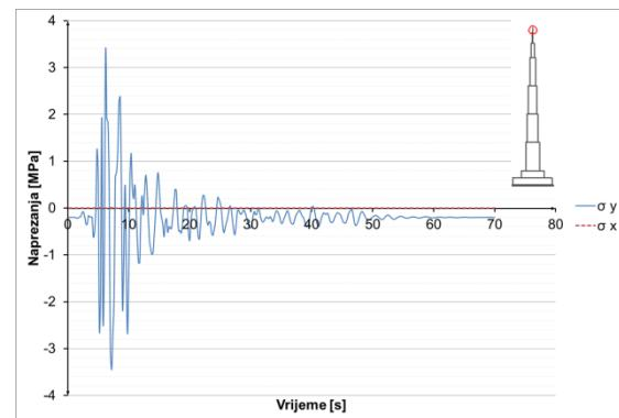
**Slika 8.3.5.32** Naprezanja u čeliku u presjeku  $h=1100$  m
