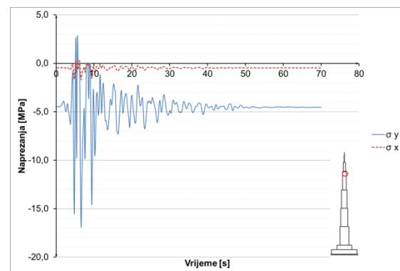
**Slika 8.3.5.24** Naprezanja u betonu u presjeku  $h=900$  m
