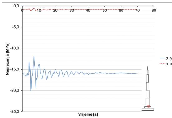
**Slika 8.3.5.19** Naprezanja u betonu u presjeku  $h=100$  m
