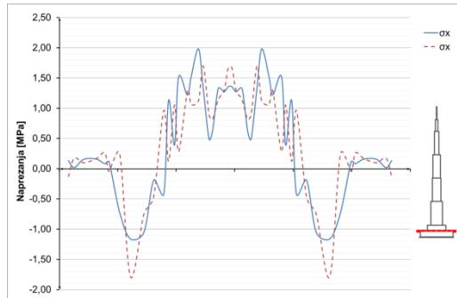
**Slika 8.1.3.22** Horizontalna naprezanja u ploči,  $h=52\text{m}$  – kombinacija opterećenja  $1.0G + 1.0Q$
