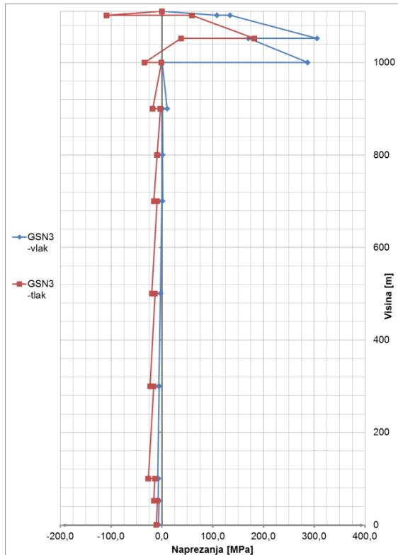
**Slika 7.4.3.1** Prikaz normalnih naprezanja po visini konstrukcije, kombinacija GSN3
