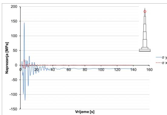
**Slika 8.3.3.27** Naprezanja u čeliku u presjeku  $h=1015$  m
