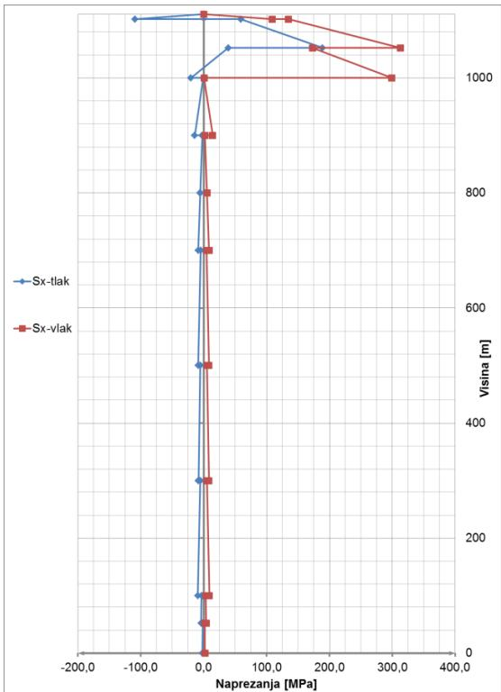
Slika 7.3.2.3 Prikaz normalnih naprezanja po visini konstrukcije, opterećenje potresom
