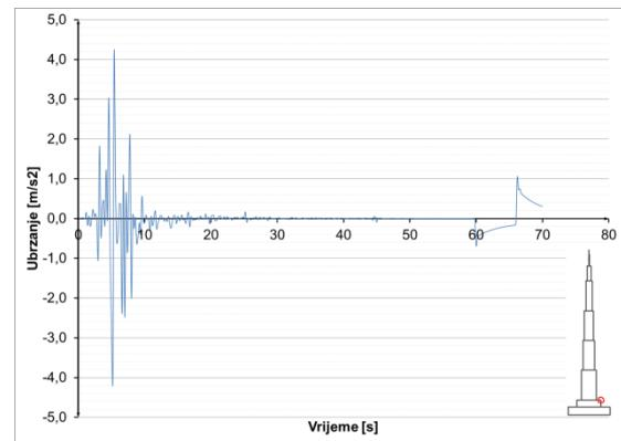
Slika 8.3.5.46 Ubrzanja u presjeku  $h=100$  m – potres Bingöl
