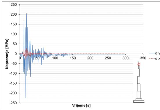
**Slika 8.3.2.29** Naprezanja u čeliku u presjeku  $h=1045$  m
