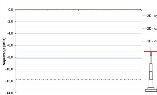
**Slika 8.1.3.12** Naprezanja u čeliku presjek  $h=1005$  m m
