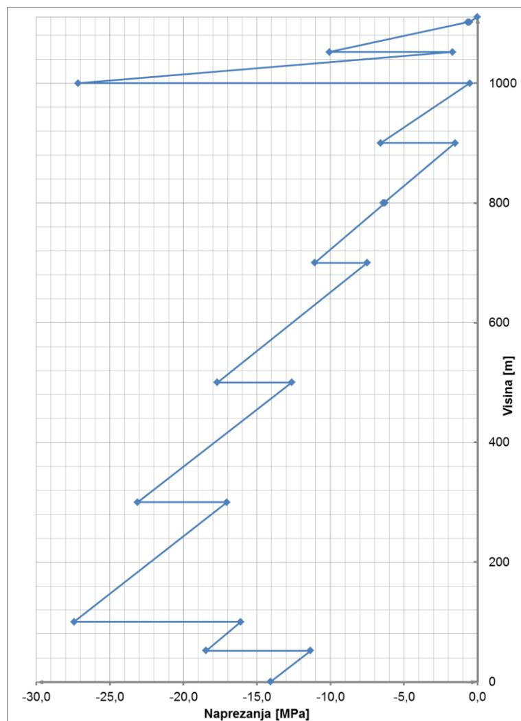
Slika 7.4.1.1 Prikaz normalnih naprezanja po visini konstrukcije, kombinacija GSNI
