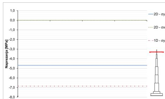
Slika 8.1.1.12 Naprezanja u čeliku u presjeku  $h=1052$  m
