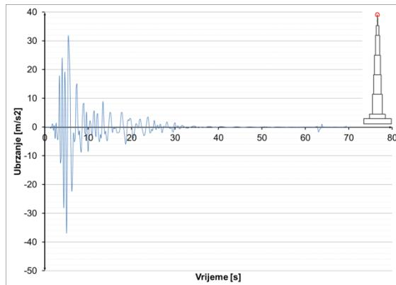
Slika 8.3.9.52 Ubrzanja u presjeku  $h=1111$  m – potres Ston
