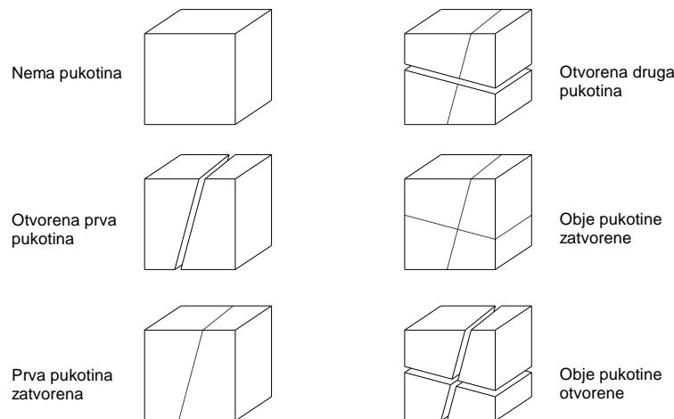
Slika 4.2.3.3 Shematski prikaz mogućih otvaranja i zatvaranja pukotina
