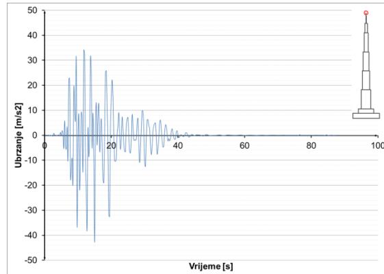
**Slika 8.3.4.53** Ubrzanja u presjeku  $h=1111$  m – potres Kobe
