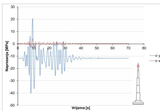
**Slika 8.3.7.26** Naprezanja u čeliku u presjeku  $h=1015$  m
