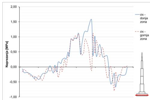
**Slika 8.1.3.19** Horizontalna naprezanja u ploči, h=16m – opterećenje vjetrom
