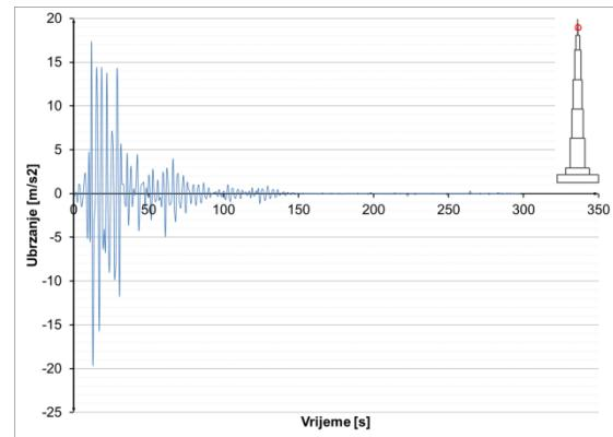
**Slika 8.3.2.52** Ubrzanja u presjeku h=1052 m – potres Izmit
