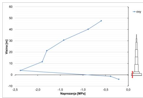
**Slika 8.1.3.16** Posmična naprezanja u presjeku  $x=42$  m –
