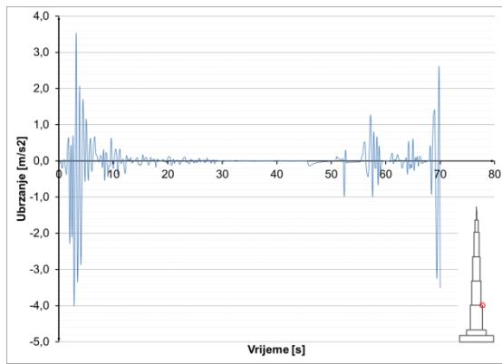
**Slika 8.3.9.46** Ubrzanja u presjeku  $h=300$  m – potres Ston
