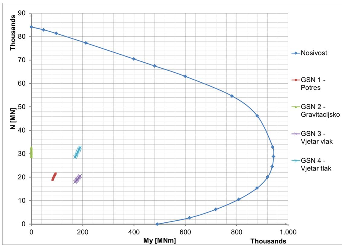
Slika 7.4.3.2 Dijagram nosivosti za presjek 52-100 m
