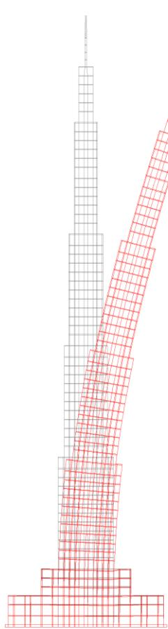
Slika 8.1.3.1 Deformirano stanje za opterećenje vjetrom
