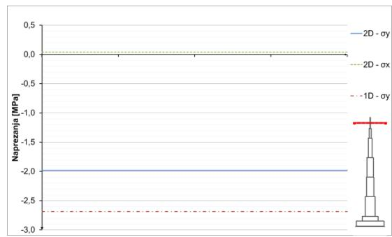
**Slika 8.1.2.12** Naprezanja u čeliku u presjeku  $h=1052\text{ m}$
