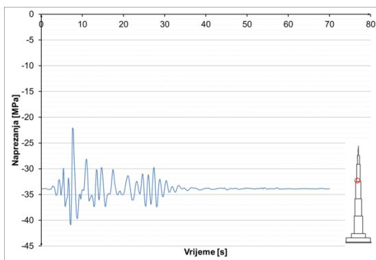
**Slika 8.3.7.38** Naprezanja u armaturi u u presjeku
