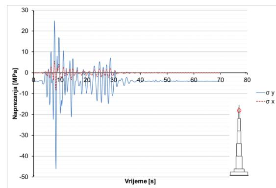
**Slika 8.3.7.29** Naprezanja u čeliku u presjeku  $h=1052$  m
