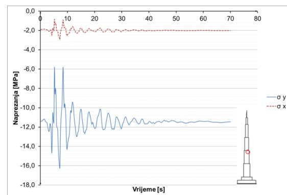
**Slika 8.3.5.22** Naprezanja u betonu u presjeku  $h=500$  m
