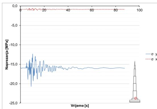
**Slika 8.3.4.19** Naprezanja u betonu u presjeku  $h=100$  m
