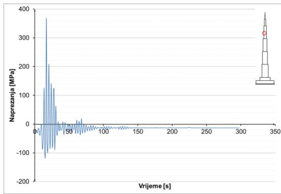
**Slika 8.3.2.41** Naprezanja u armaturi u presjeku  $h=770$  m – potres Izmit
