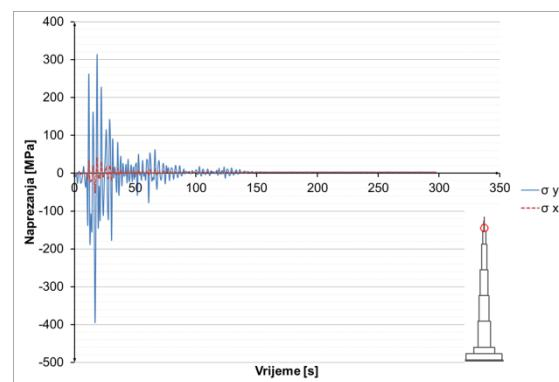
**Slika 8.3.2.28** Naprezanja u čeliku u presjeku  $h=1030$  m
