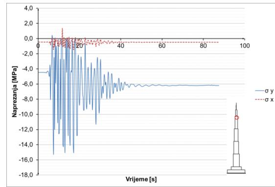
**Slika 8.3.4.24** Naprezanja u betonu u presjeku  $h=900$  m
