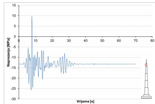
**Slika 8.3.7.43** Naprezanja u armaturi u presjeku
