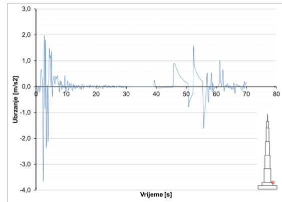
**Slika 8.3.9.45** Ubrzanja u presjeku  $h=100$  m – potres Ston
