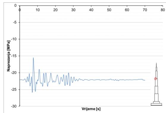
**Slika 8.3.7.37** Naprezanja u armaturi u u presjeku
