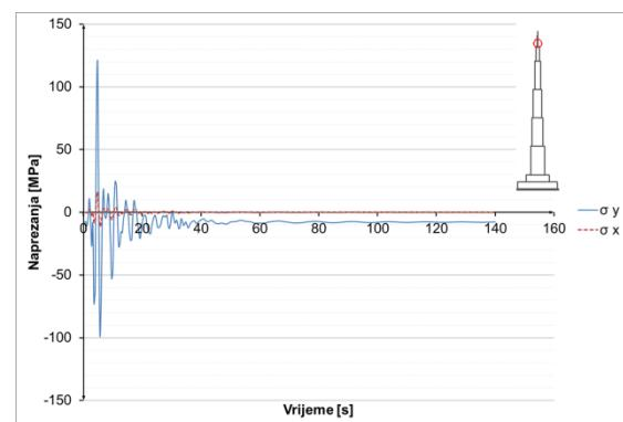
**Slika 8.3.3.28** Naprezanja u čeliku u presjeku  $h=1030$  m
