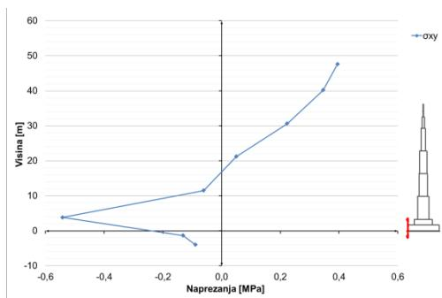
Slika 8.1.3.13 Posmična naprezanja u presjeku  $x=13\text{m}$  – opterećenje vjetrom
