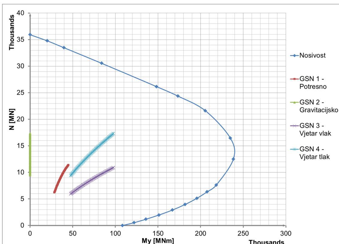
Slika 7.4.3.4 Dijagram nosivosti za presjek 300-500 m
