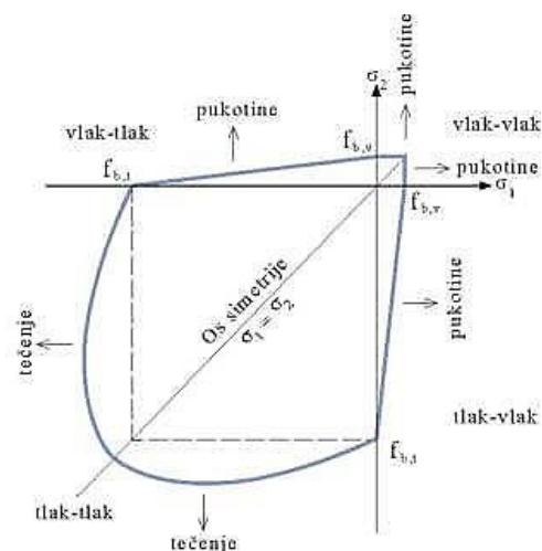
Slika 4.2.3.2 Dvodimenzionalni prikaz u polju glavnih naprezanja
