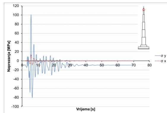
**Slika 8.3.9.27** Naprezanja u čeliku u presjeku  $h=1030$  m
