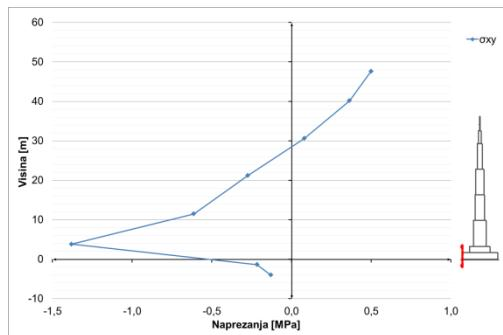
**Slika 8.1.3.14** Posmična naprezanja u presjeku  $x=13$  m –
