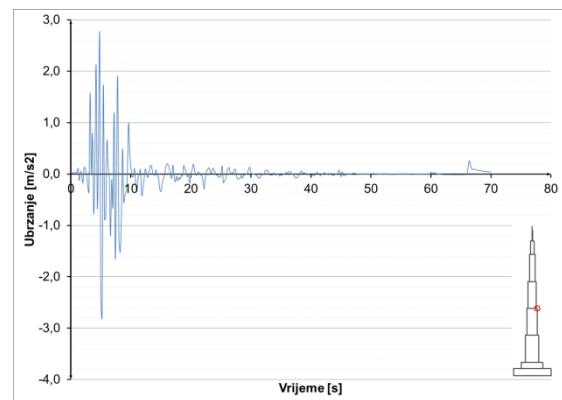
Slika 8.3.5.48 Ubrzanja u presjeku  $h=500$  m – potres Bingöl
