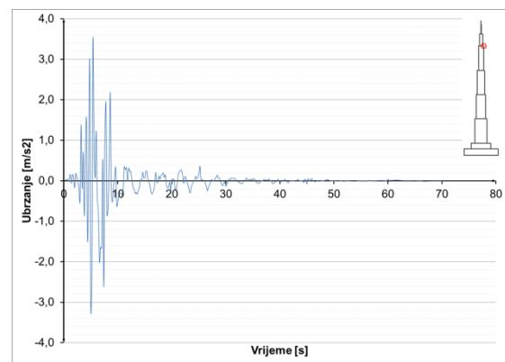
**Slika 8.3.5.50** Ubrzanja u presjeku  $h=900$  m – potres
