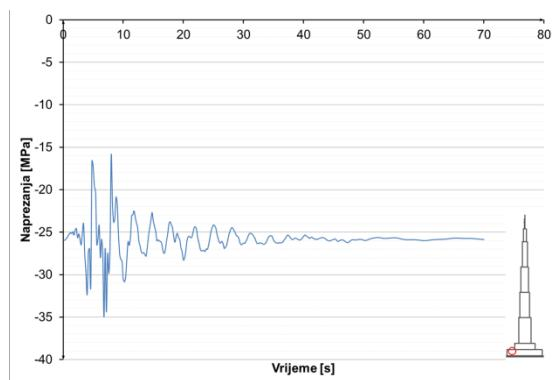
**Slika 8.3.5.33** Naprezanja u armaturi u presjeku  $h=52$  m
