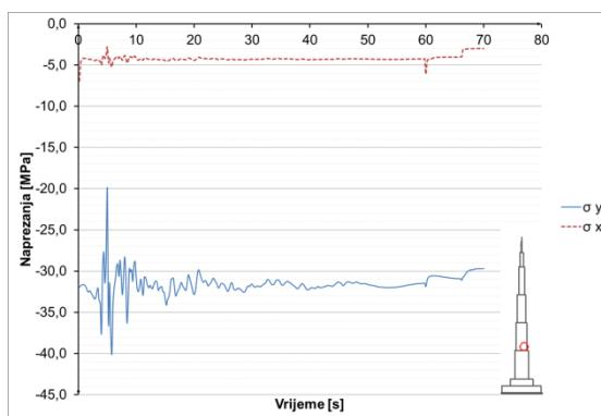
**Slika 8.3.5.21** Naprezanja u betonu u presjeku  $h=305$  m
