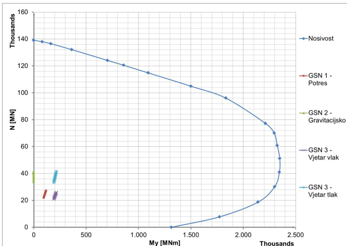
Slika 7.4.3.1 Dijagram nosivosti za presjek 0-52 m
