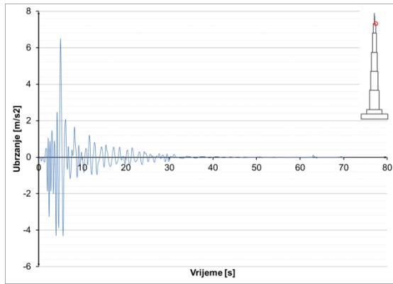
Slika 8.3.9.50 Ubrzanja u presjeku  $h=1000$  m – potres
