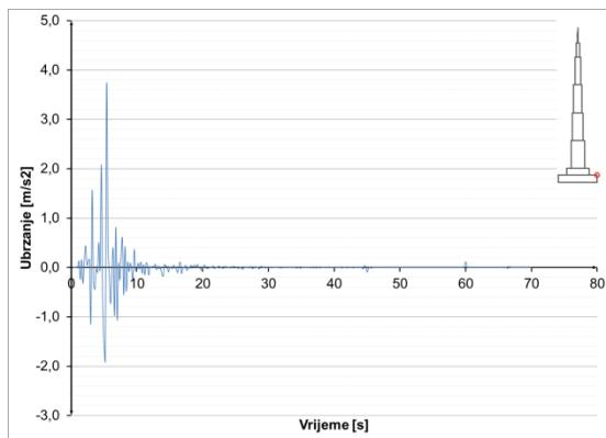
Slika 8.3.5.45 Ubrzanja u presjeku  $h=52$  m – potres Bingöl
