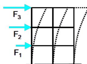
Slika 2.6.1.2 Shema rasporeda karakterističnog opterećenja po visini
