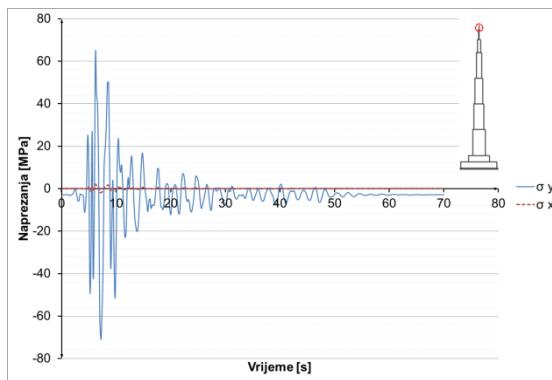
**Slika 8.3.5.31** Naprezanja u čeliku u presjeku  $h=1075$  m
