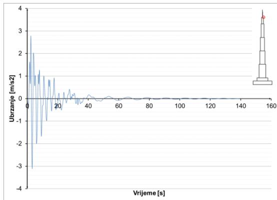
**Slika 8.3.3.51** Ubrzanja u presjeku  $h=1000$  m – potres Banja Luka
