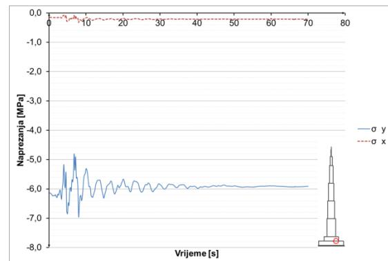
Slika 8.3.5.18 Naprezanja u betonu u presjeku  $h=52$  m –
