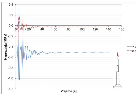
**Slika 8.3.3.25** Naprezanja u betonu u presjeku  $h=100$  m
