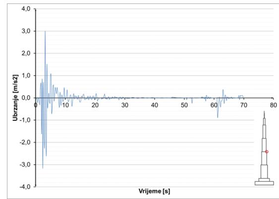
**Slika 8.3.9.47** Ubrzanja u presjeku  $h=500$  m – potres Ston
