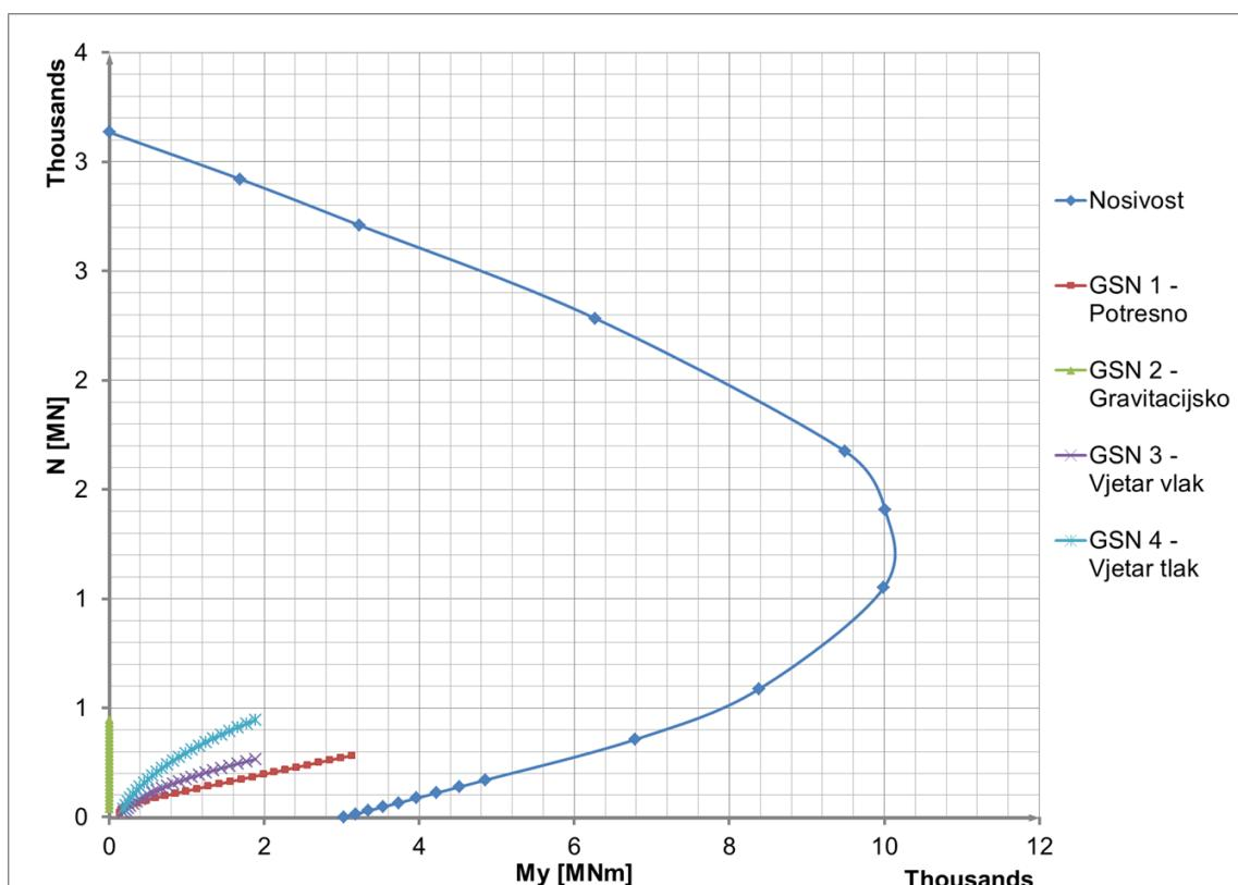
Slika 7.4.3.8 Dijagram nosivosti za presjek 900-1000 m
