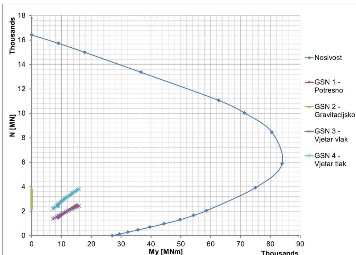
Slika 7.4.3.6 Dijagram nosivosti za presjek 700-800 m
