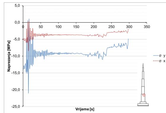
**Slika 8.3.2.20** Naprezanja u betonu u presjeku  $h=295$  m
