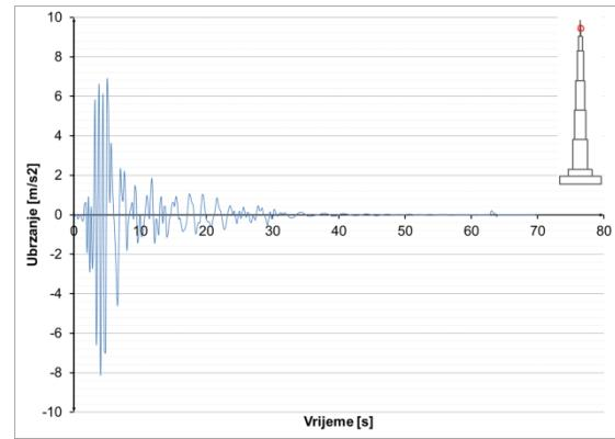
Slika 8.3.9.51 Ubrzanja u presjeku  $h=1052$  m – potres
