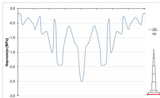
Slika 8.1.3.3 Naprezanja u tlu – kombinacija opterećenja 1.0G + 1.0Q
