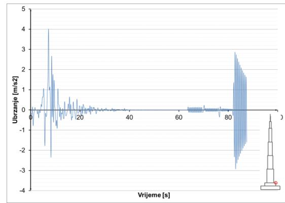
Slika 8.3.4.46 Ubrzanja u presjeku  $h=100$  m – potres Kobe
