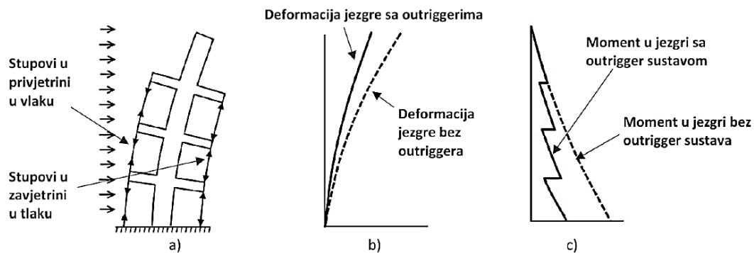
Slika 2.3.3.11 (a) Osnovno konstrukcijsko ponašanje "outrigger" sustava,
