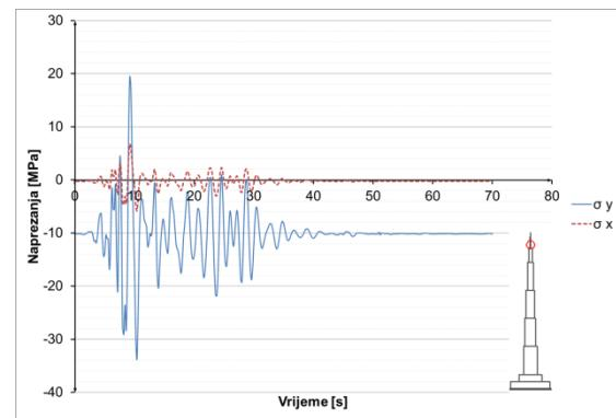
**Slika 8.3.7.25** Naprezanja u čeliku u presjeku  $h=1005$  m
