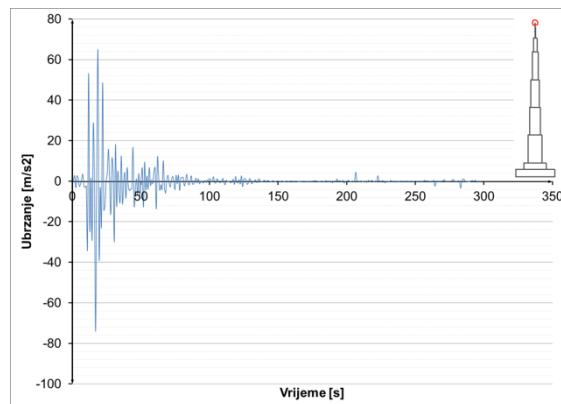
**Slika 8.3.2.53** Ubrzanja u presjeku h=1111 m – potres Izmit
