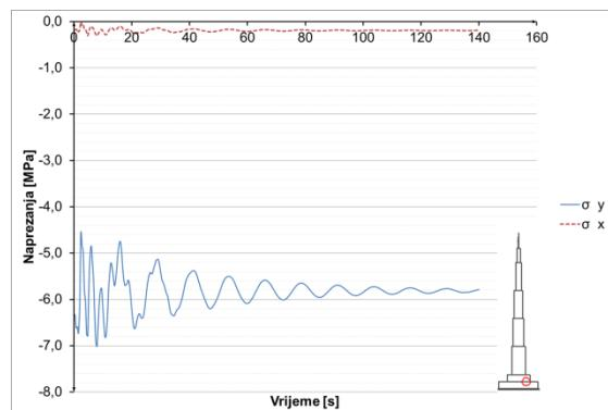
Slika 8.3.3.18 Naprezanja u betonu u presjeku  $h=52$  m –
