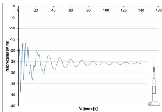
**Slika 8.3.3.33** Naprezanja u armaturi u presjeku  $h=52$  m
