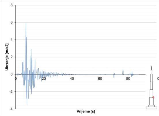
Slika 8.3.4.47 Ubrzanja u presjeku  $h=300$  m – potres Kobe
