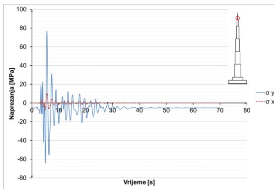
**Slika 8.3.9.28** Naprezanja u čeliku u presjeku  $h=1045$  m
