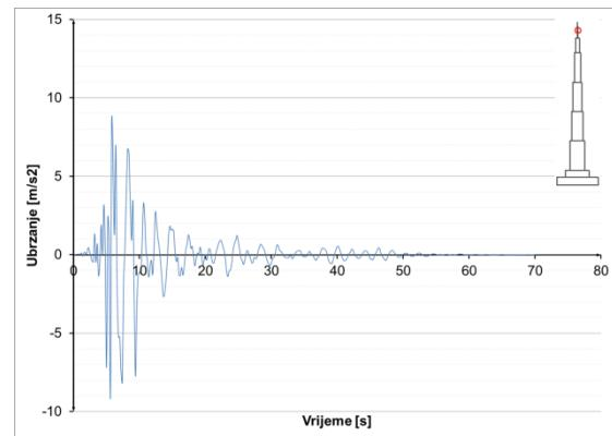
**Slika 8.3.5.52** Ubrzanja u presjeku  $h=1052$  m – potres
