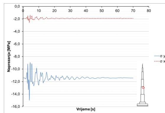
**Slika 8.3.9.21** Naprezanja u betonu u presjeku  $h=500$  m
