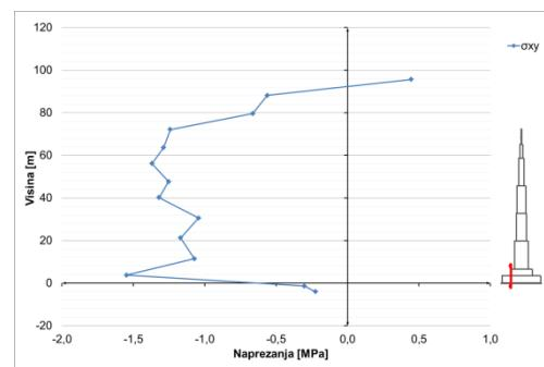
Slika 8.1.3.14 Posmična naprezanja u presjeku  $x=32\text{m}$  – opterećenje vjetrom
