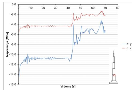
**Slika 8.3.7.19** Naprezanja u betonu u presjeku  $h=295$  m
