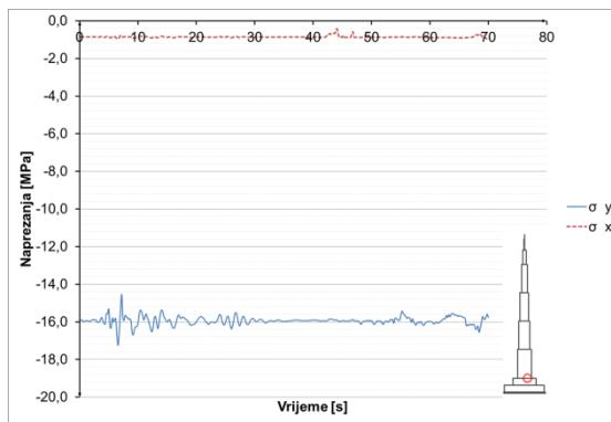
**Slika 8.3.7.18** Naprezanja u betonu u presjeku  $h=100$  m
