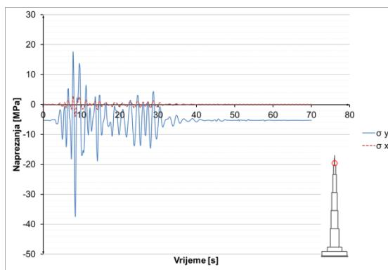
**Slika 8.3.7.28** Naprezanja u čeliku u presjeku  $h=1045$  m
