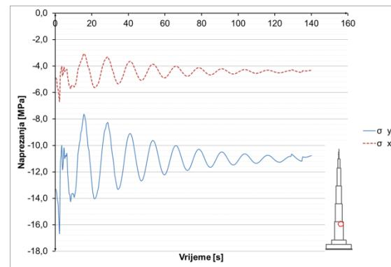
**Slika 8.3.3.20** Naprezanja u betonu u presjeku  $=295$  m – potres Banja Luka
