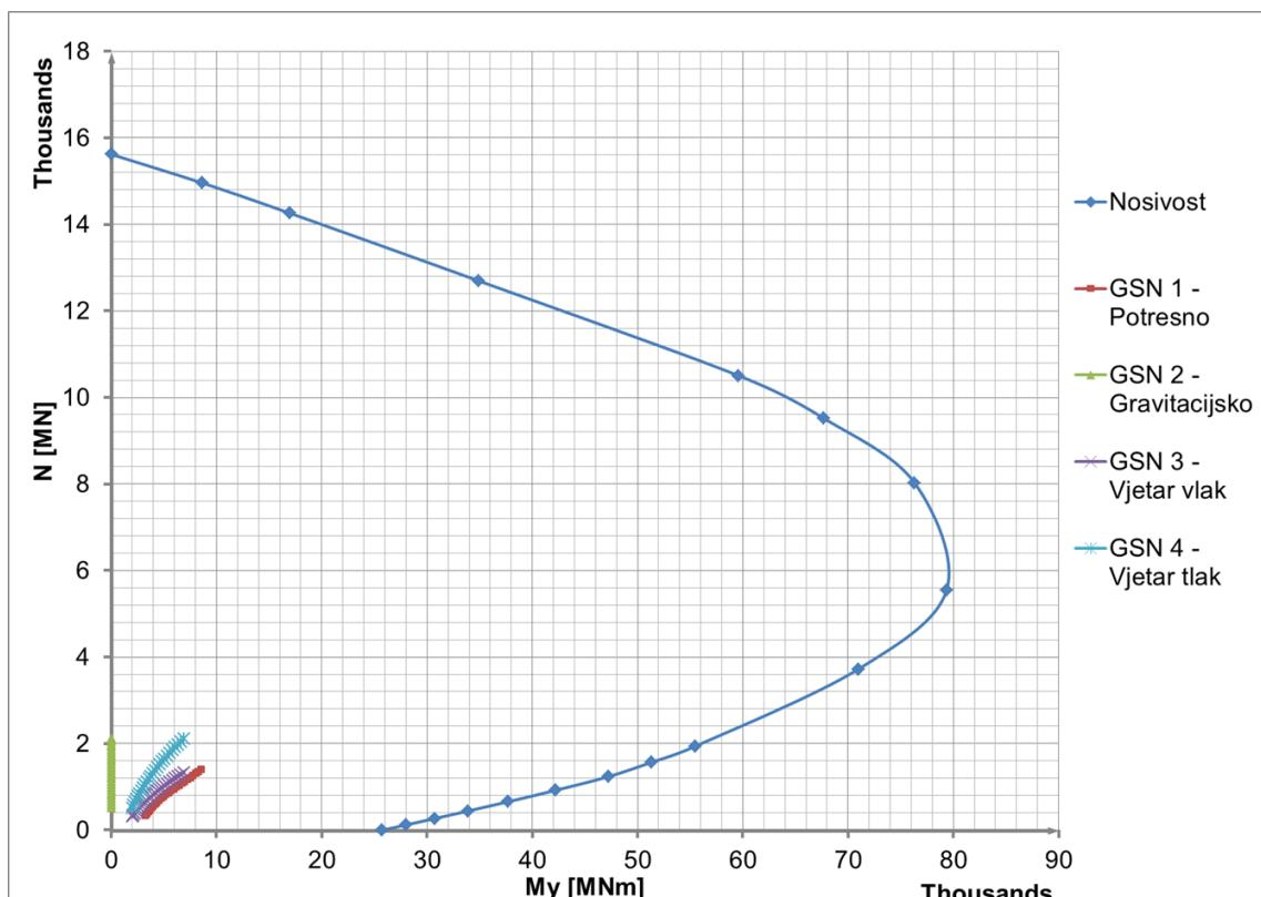
Slika 7.4.3.7 Dijagram nosivosti za presjek 800-900 m
