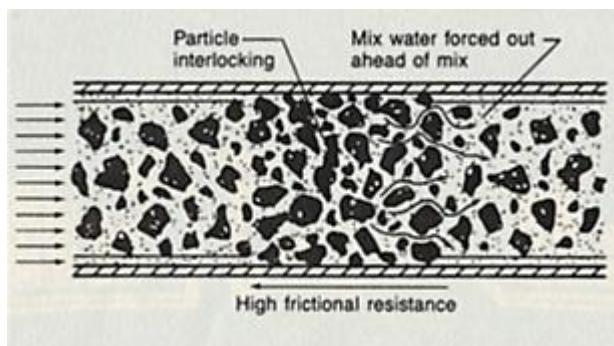
Slika 2.1.1.2 Shema formiranja blokade krupnog agregata, uzrokovanog potiskivanjem vode kroz mješavinu. Upotreba silicijske prašine (10%) i sitnog agregata (50%) za mješavinu pri izvedbi Burj Khalife pripomogla je prevenciji blokade agregata i ne pretjeranoj koheziji mješavine.
