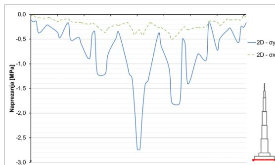
Slika 8.1.3.3 Naprezanja u betonu u temelju – opterećenje vjetrom
