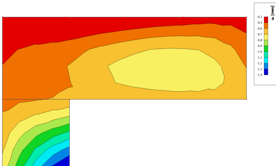
Slika 8.1.34. Progibi ploča [mm] za GSU-2 ( \delta EL \leq L/1250 )
